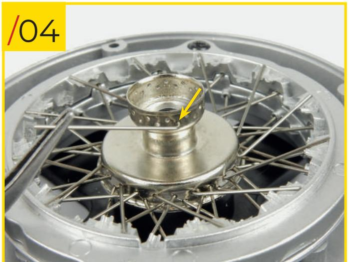
71/04 Insérez l'extrémité crochue de l'un des rayons de type C dans l'un des trous de la rangée inférieure sur le moyeu de type C.
