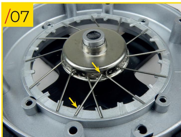
69/07 Maintenant mettez les rayons de type A (qui sont plus longs que ceux de type B) en insérant leur extrémité crochue dans les trous de la rangée supérieure directement à gauche des rayons de type B en veillant à ce qu'ils passent par-dessus les rayons insérés dans les trous de la rangée inférieure. Regardez la photo pour repérer l'encoche sur laquelle vous devez positionner l'autre extrémité du rayon. Laissez toujours un trou vide entre chaque rayon dans le moyeu.
