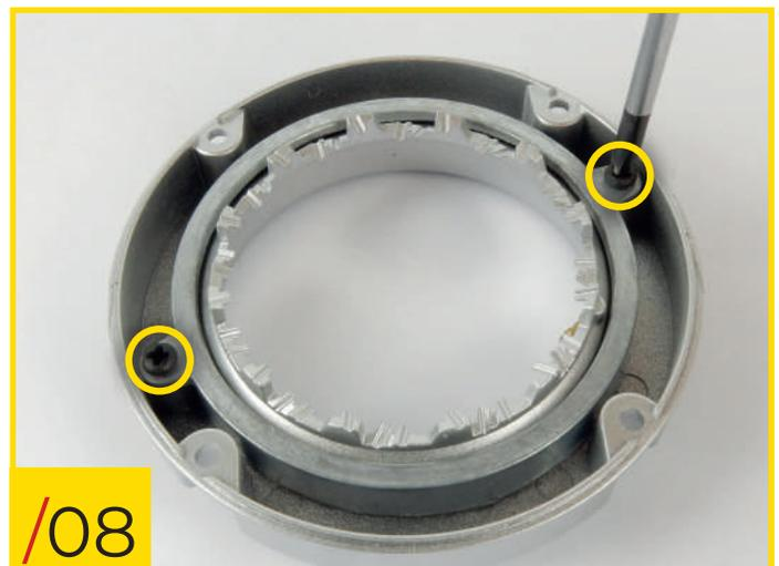
71/08 Posez la bague d'étanchéité sur la jante externe comme sur la photo. Vissez à l'aide de deux vis de type B.
