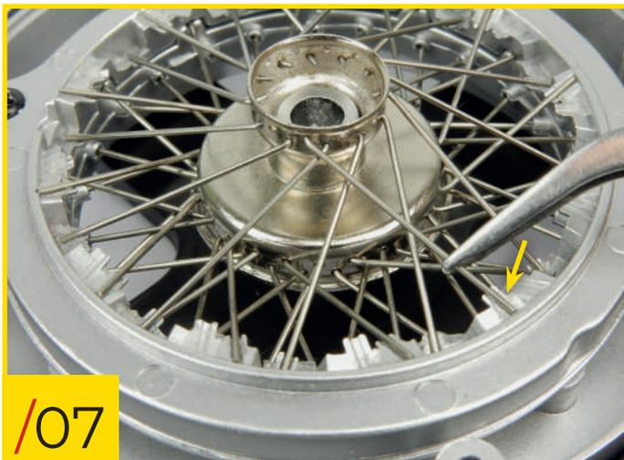
71/07 Placez l'autre extrémité du rayon sur l'encoche correspondante sur le niveau supérieur de l'anneau de fixation. Répétez ces étapes pour les onze autres rayons de type C, jusqu'à ce que tous les trous de la rangée supérieure sur le moyeu soient remplis.
