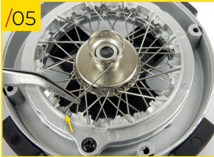
71/05 Placez l'autre extrémité du rayon sur l'encoche au niveau inférieur de l'anneau de fixation comme indiqué sur la photo. Répétez ces étapes pour les onze autres rayons de type C, jusqu'à ce que tous les trous de la rangée inférieure sur le moyeu soient remplis.
