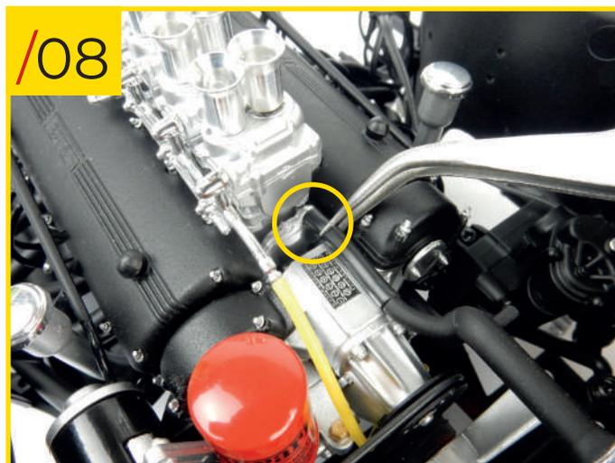
65/08 Enfoncez l'autre extrémité du tuyau flexible sur le bloc-moteur, comme indiqué sur la photo.
