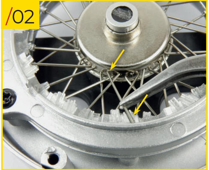
71/02 Insérez chaque extrémité crochue des rayons de type A dans les trous restants du moyeu de type A. Servez-vous de la photo pour l'orientation correcte des rayons et pour vérifier que les autres extrémités soient bien dans les encoches correspondantes au niveau supérieur de l'anneau de fixation.
