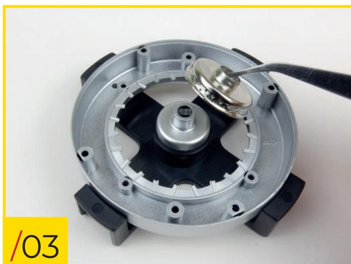
69/03 Posez le moyeu de type B sur l'ergot central du gabarit. Une fois en place, appuyez sur le moyeu de type A, comme le montre la photo.
