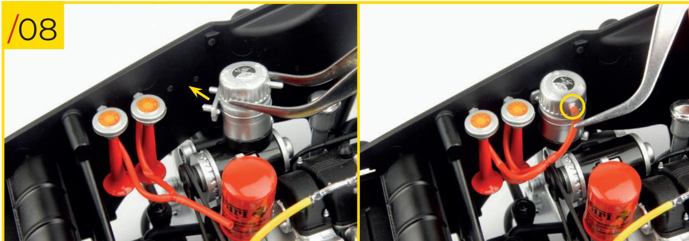
67/08 Montez le compresseur sur le côté du pare-boue avant droit, près des trompettes, et enfoncez le tuyau court sur l'ergot du couvercle du compresseur.
