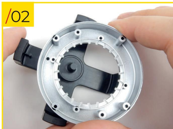
69/02 Insérez l'ergot dans le trou pour fixer la jante sur le gabarit. Avant de procéder à l'assemblage, nous vous recommandons de coller un petit morceau de scotch double face sur l'ergot central du gabarit. Cela aidera à maintenir les moyeux en place.
