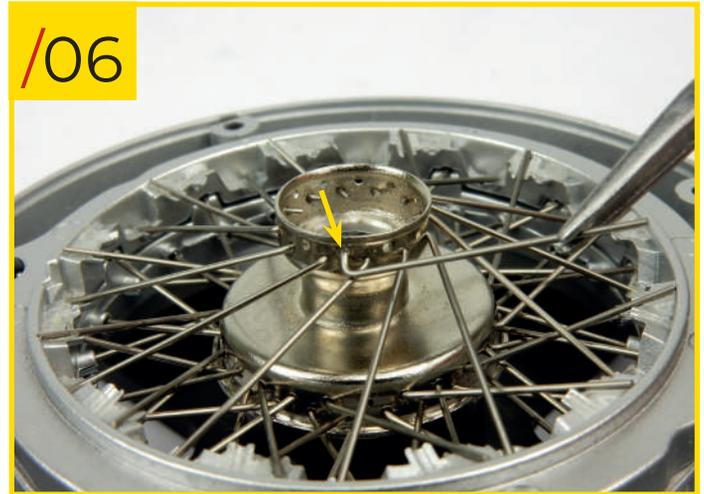
71/06 Insérez maintenant l'extrémité crochue d'un rayon de type C dans l'un des trous de la rangée supérieure sur le moyeu de type C.
