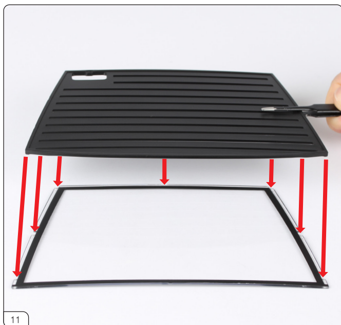
ステージ081で開梱したウインドガラスはわずかに湾曲しています。画像のように湾曲面を上に向けウインドスクリーンルーバー (82-A) を合わせます。
