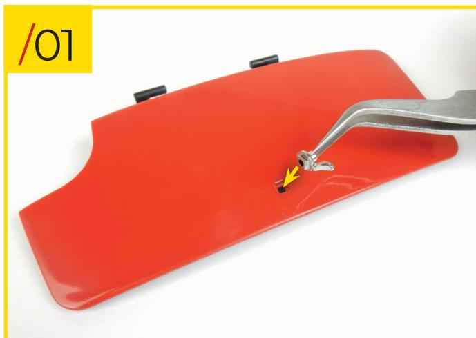
74/01 Ajoutez la serrure du coffre sur la porte du coffre, en orientant les pièces comme indiqué. Avant de mettre la serrure en place, nous vous recommandons d'utiliser une vis de type L pour agrandir le trou, ce qui facilitera l'étape suivante.
