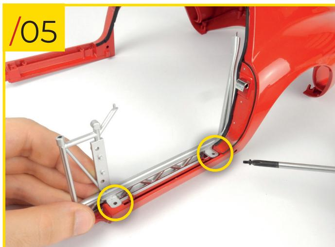
75/05 Placez l'armature de la portière gauche, comme indiqué sur la photo. Vissez-la à l'aide de deux vis de type C dans les trous indiqués.
