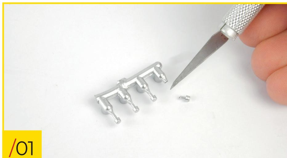
79/01 À l'aide d'un outil de coupe approprié, détachez les quatre éléments du tableau de bord de leur grappe. Veillez à ne pas les endommager.
