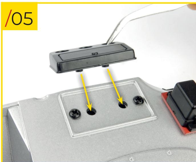
80/05 Montez le support de tuyaux sur le pare-feu, dans la position indiquée sur la photo. Insérez les ergots du support dans les trous prévus à cet effet.
