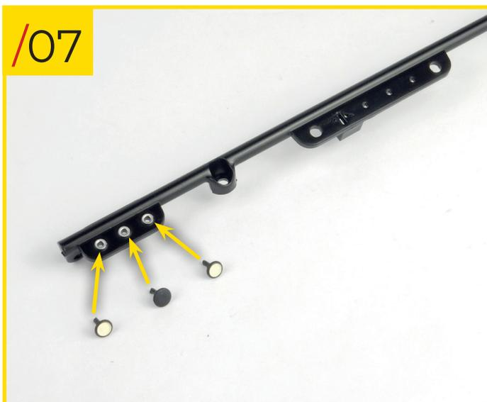
80/07 Récupérez le support du tableau de bord que vous avez reçu lors de l'étape 78. Insérez l'interrupteur A et les interrupteurs B dans les trous indiqués sur la photo (l'interrupteur A dans le trou central, les interrupteurs B dans les trous situés vers l'extérieur).
