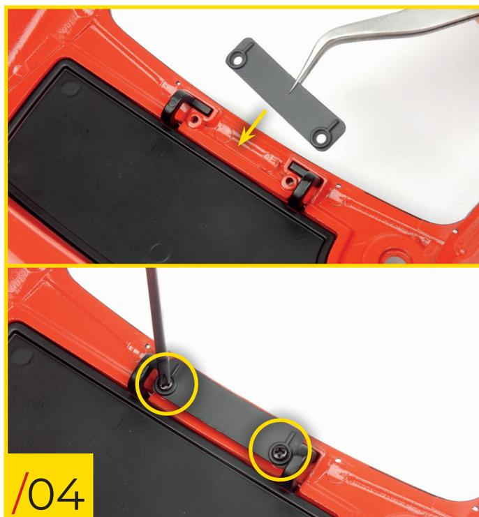
74/04 Retournez l'assemblage et placez la plaque de montage sur les charnières de la porte du coffre. Mettez les pièces dans le même sens que sur la photo et vissez deux vis de type C. Serrez bien les vis et vérifiez que la plaque se pose parfaitement sur la carrosserie. Quand vous ouvrez la porte du coffre, la plaque doit bien rester en place.
