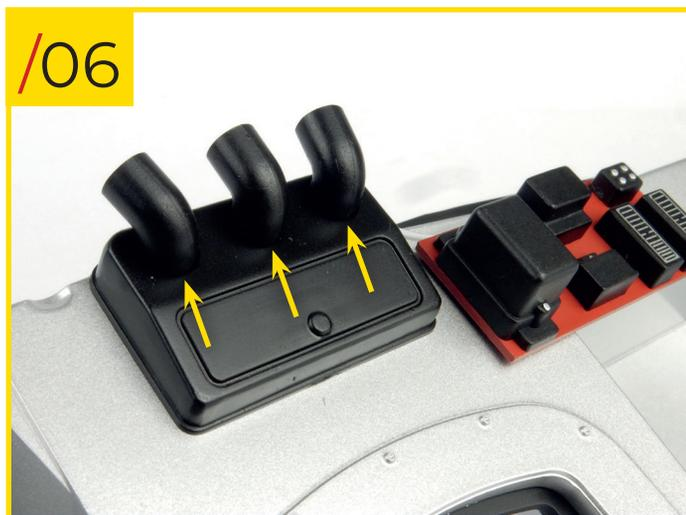
80/06 Insérez les extrémités semi-circulaires des trois tuyaux d'air dans les trous semi-circulaires du support. Les pièces ne se mettent que dans un seul sens.
