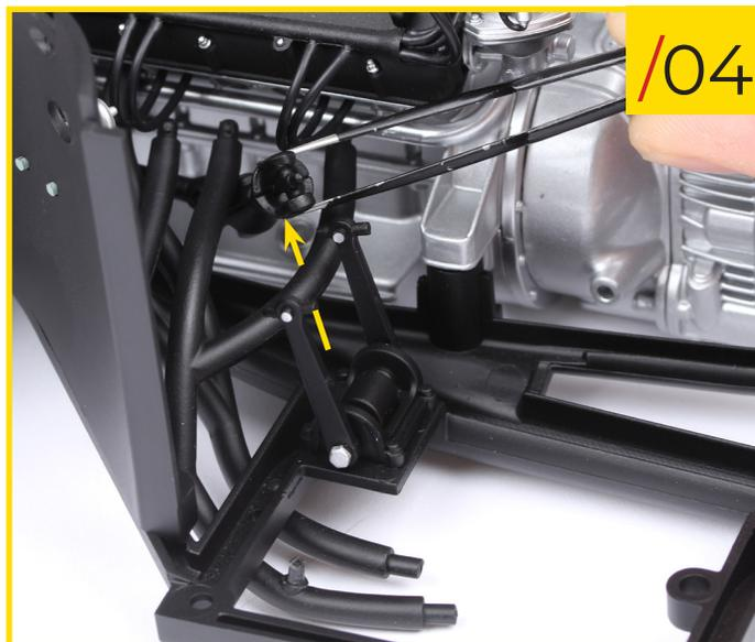
/05 Remettez le collecteur d'échappement arrière gauche dans le moteur et le châssis.
