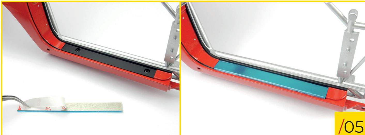
76/05 Retirez le film protecteur au dos de la plaque et placez celle-ci sur la partie noire du marchepied pour cacher les vis. Orientez les pièces comme indiqué et, pour l'instant, ne retirez pas le film bleu : la surface de la plaque restera ainsi protégée lors des prochaines séances de montage.
