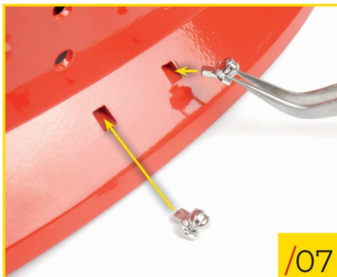
74/07 Insérez les deux lampes de la plaque d'immatriculation dans les trous prévus à cet effet à l'arrière de la carrosserie. Orientez les pièces comme indiqué.
