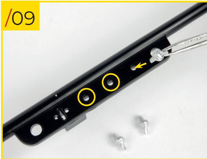
80/09 Insérez les extrémités semi-circulaires des trois interrupteurs C dans les trous correspondants situés au milieu du support du tableau de bord. Il n'y a qu'une seule façon de les mettre en place.
