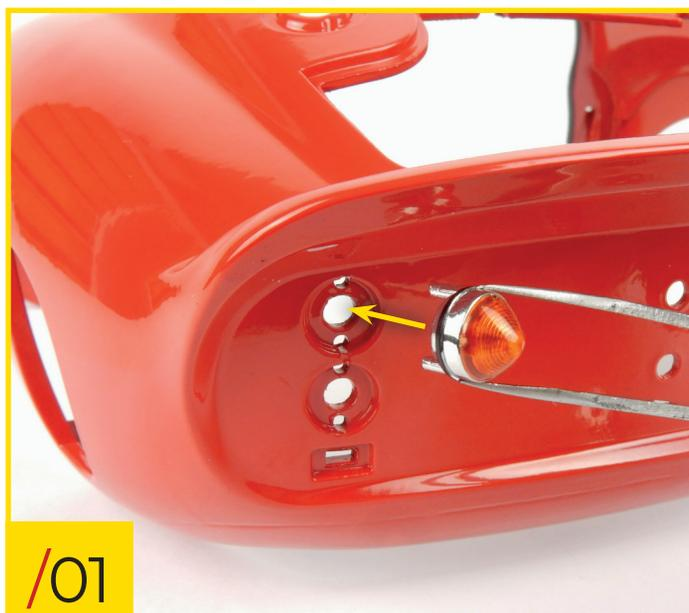
73/01 Placez la partie arrière de la carrosserie (étape 68) sur votre plan de travail. Placez l'un des clignotants dans l'emplacement sur le côté gauche de la carrosserie, en orientant les pièces comme indiqué.
