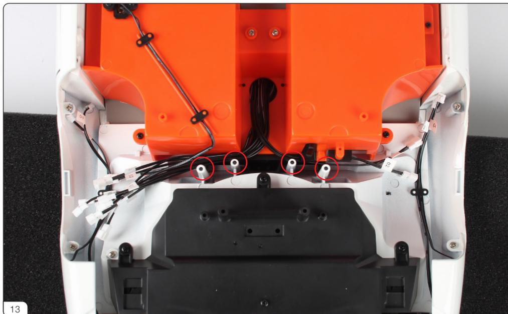
画像のように、残りのケーブルを左のホイールアーチの近くに移動します。ケーブルが4つのネジポスト（赤丸印）と干渉しないように配置してください。
