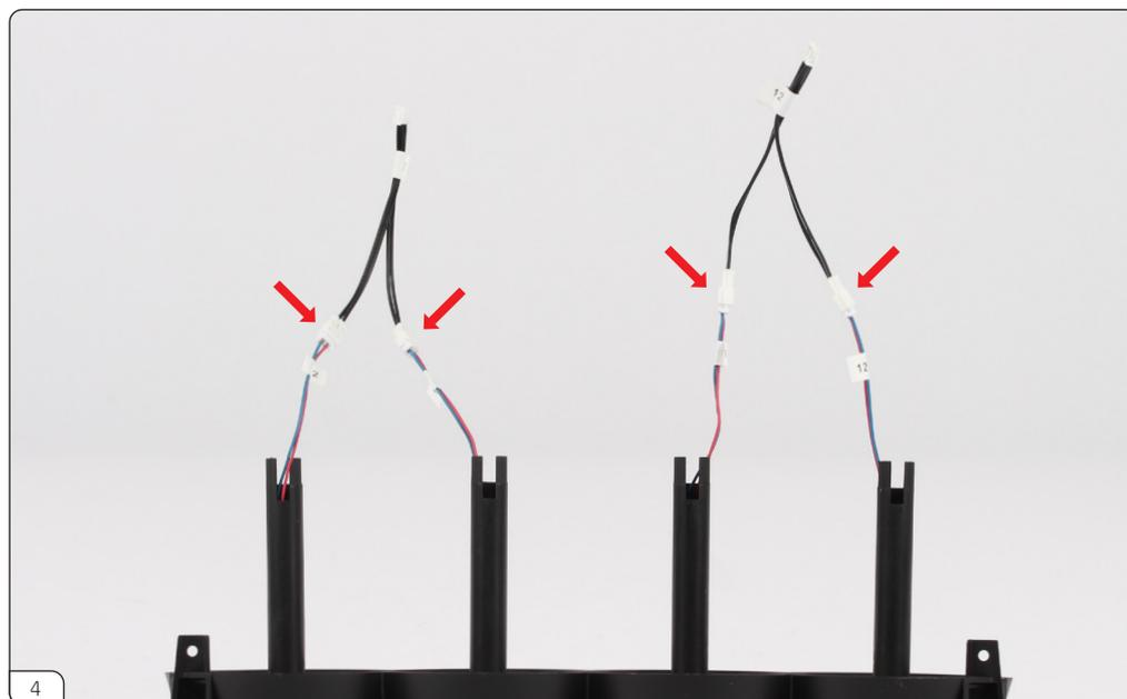
画像のように、モーターコネクタ（85-C）をプロペラモーター（85-B）のケーブルに接続します。
