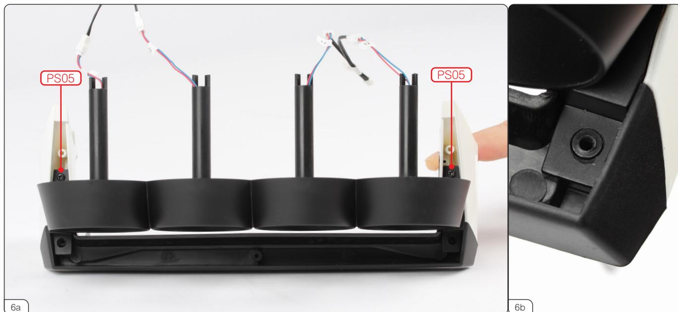
PS05ネジ2本でパーツを固定します (6a)。このとき2つのスクリューポストの上部が、プロペラガード後部のタブの上部と高さが合っているか、確認してください (6b)。
