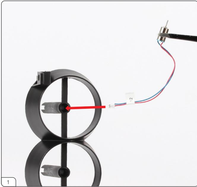
プロペラモーター (85-B) のケーブルコネクタをプロペラガード (85-A) に通します。
