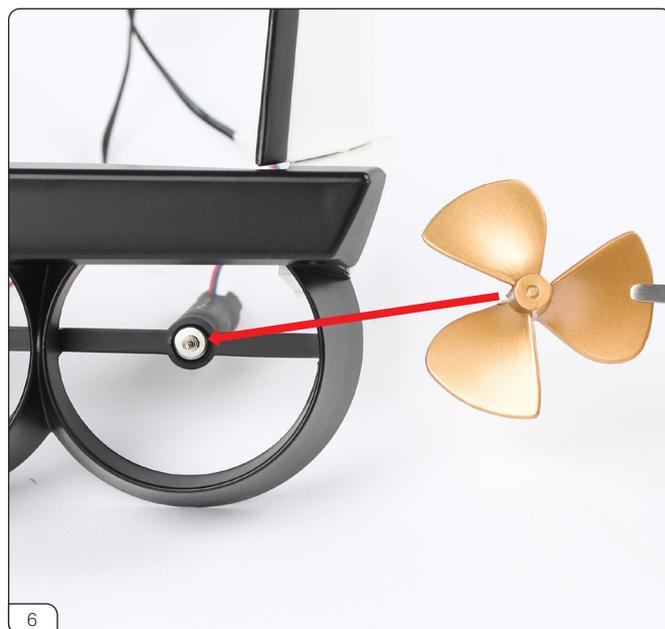
プロペラ (86-A) をモーターの軸に押し込みます。
