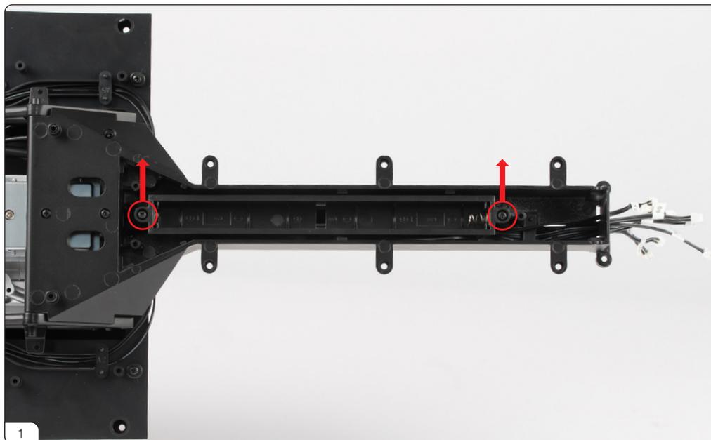
ステージ044で組み立てたシャーシのバッテリーコンパートメントを固定しているDS02ネジを取り外します（赤矢印）。
