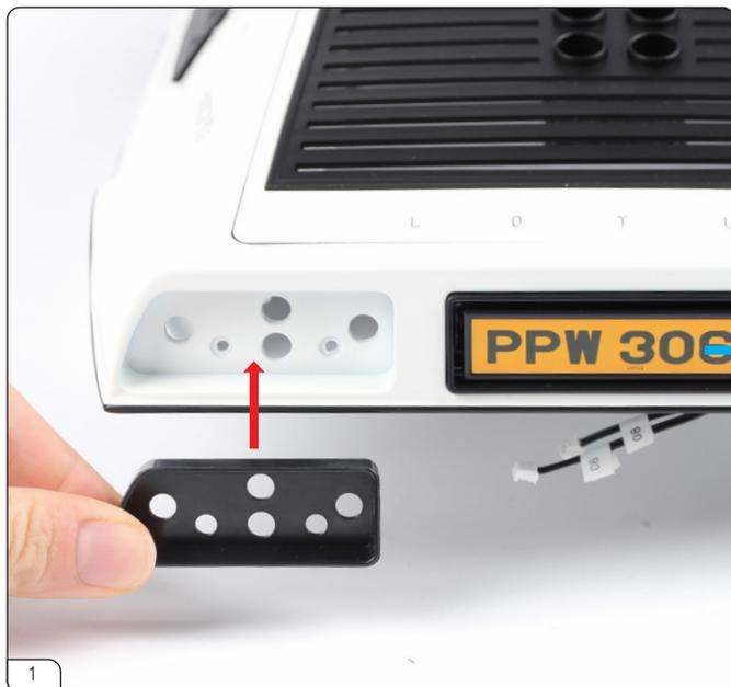
ステージ088で組み立てたボディにリアライトハウジング (89-C) を押し込みます。
