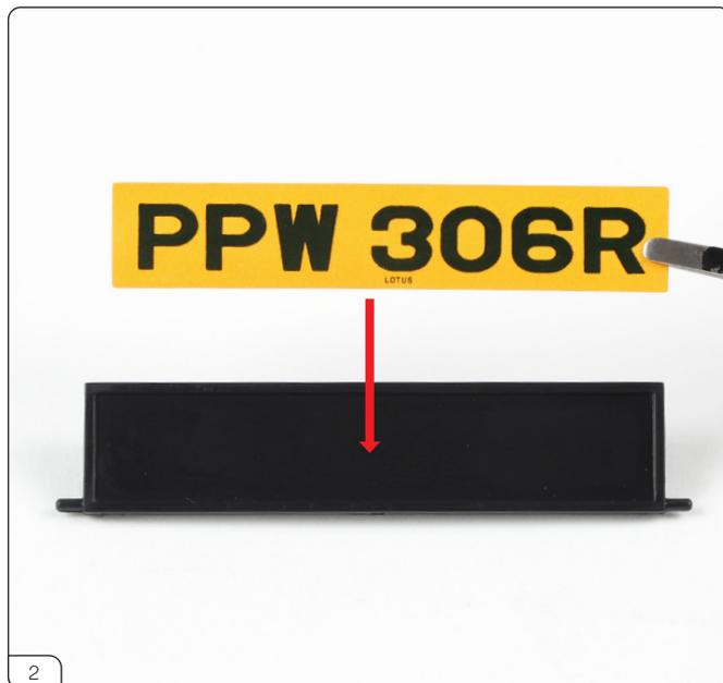
画像のように、ナンバープレートステッカー (87-H) をナンバープレート (87-B) に合わせます。
