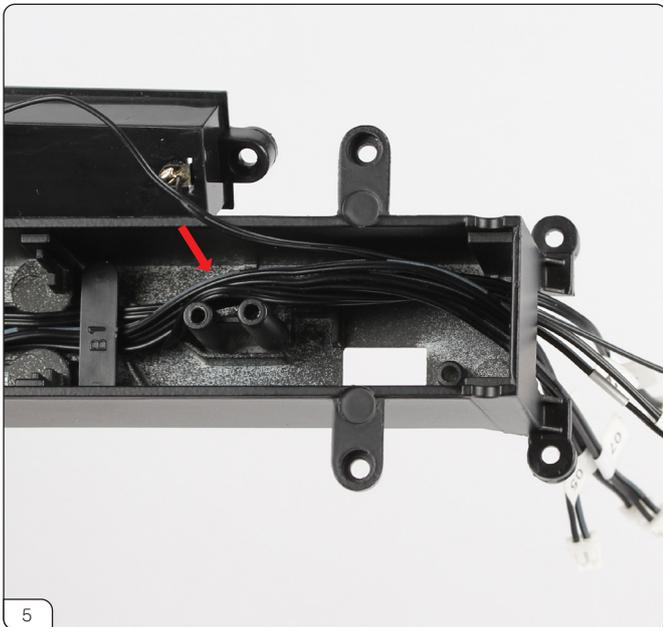
画像のように、ケーブルをネジポストの反対側に配置します。
