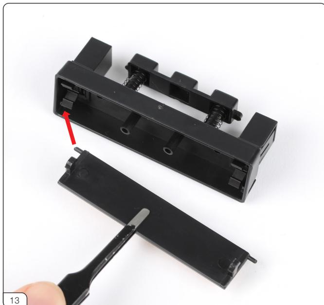
コンパートメント (87-A) のブラケットに突起を差し込み、ナンバープレートを取り付けます。
