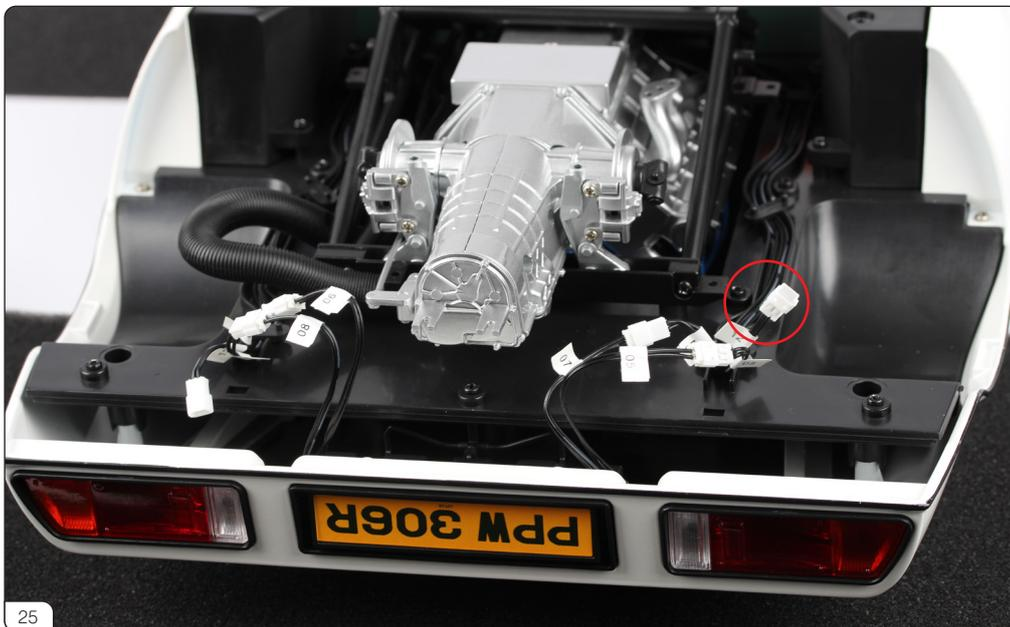
ケーブル「05」「06」「08」を接続します。ケーブル「12」(赤丸印)はあとの工程で接続します。
