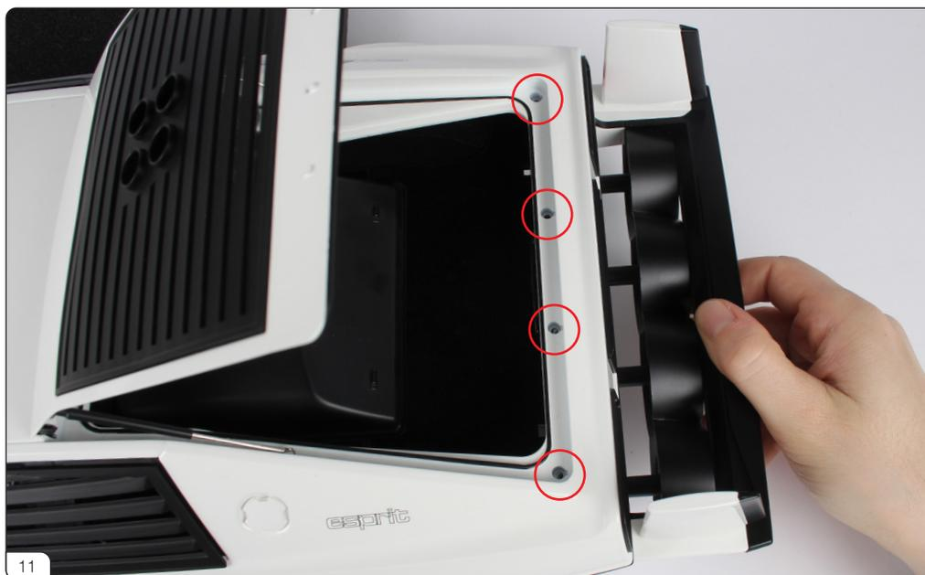
赤丸印がネジ穴です。ネジポストとネジ穴をしっかりと合わせます。このときケーブルなどを引っ掛けないように注意してください。
