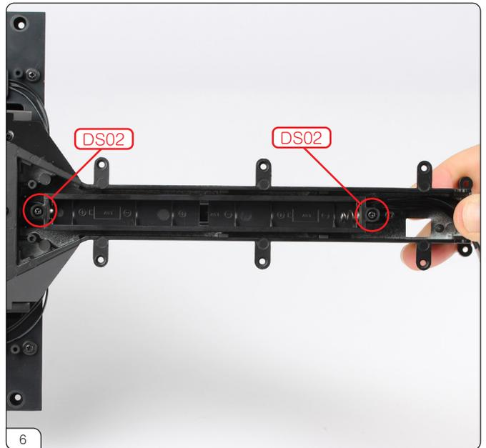
バッテリーコンパートメントを元に戻し、DS02ネジで固定します。
