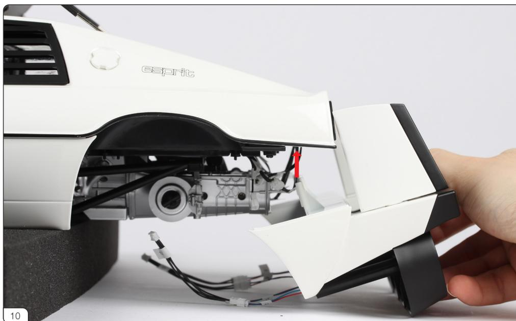
画像のように、リアバランスをボディの下に入れて保持します。赤矢印のネジポストをボディのネジ穴に合わせてください。
