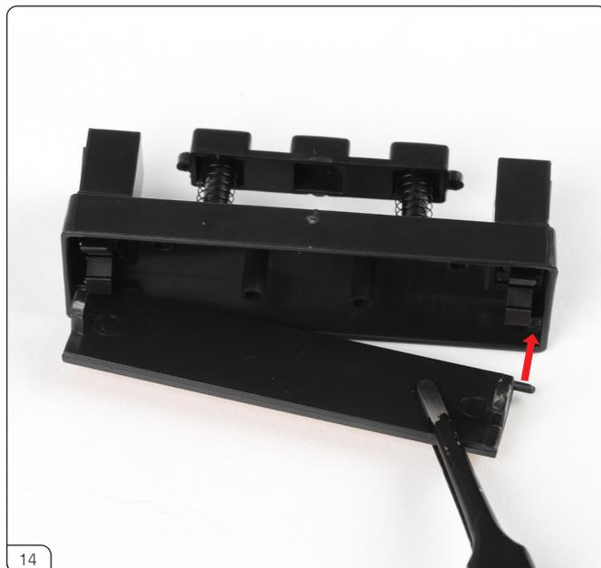
反対側のブラケットに突起を差し込みます。ナンバープレートを少し曲げながら差し込みましょう。
