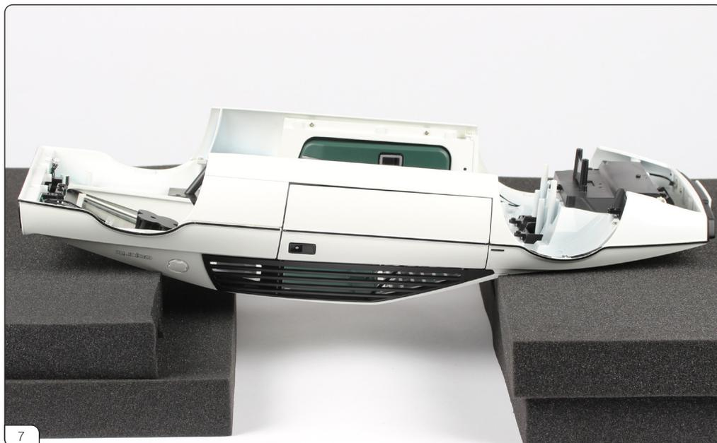
ステージ089で組み立てたボディを裏返します。画像のような台を使って塗装面を保護してください。
