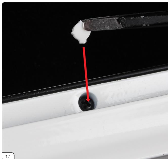
17 ネジの上部にスクリーキャップ (91-D) を押し込みます。
