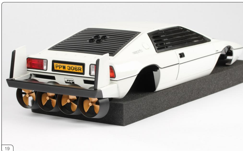
画像のように、モデルを保管するときは、プロペラガードが傷つかないようにボディの下側を支えてください。
