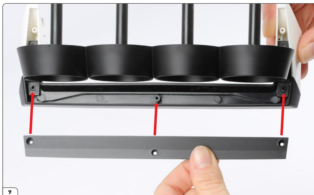
Placez le dessous du pare-chocs (84-B) sur l'assemblage.
