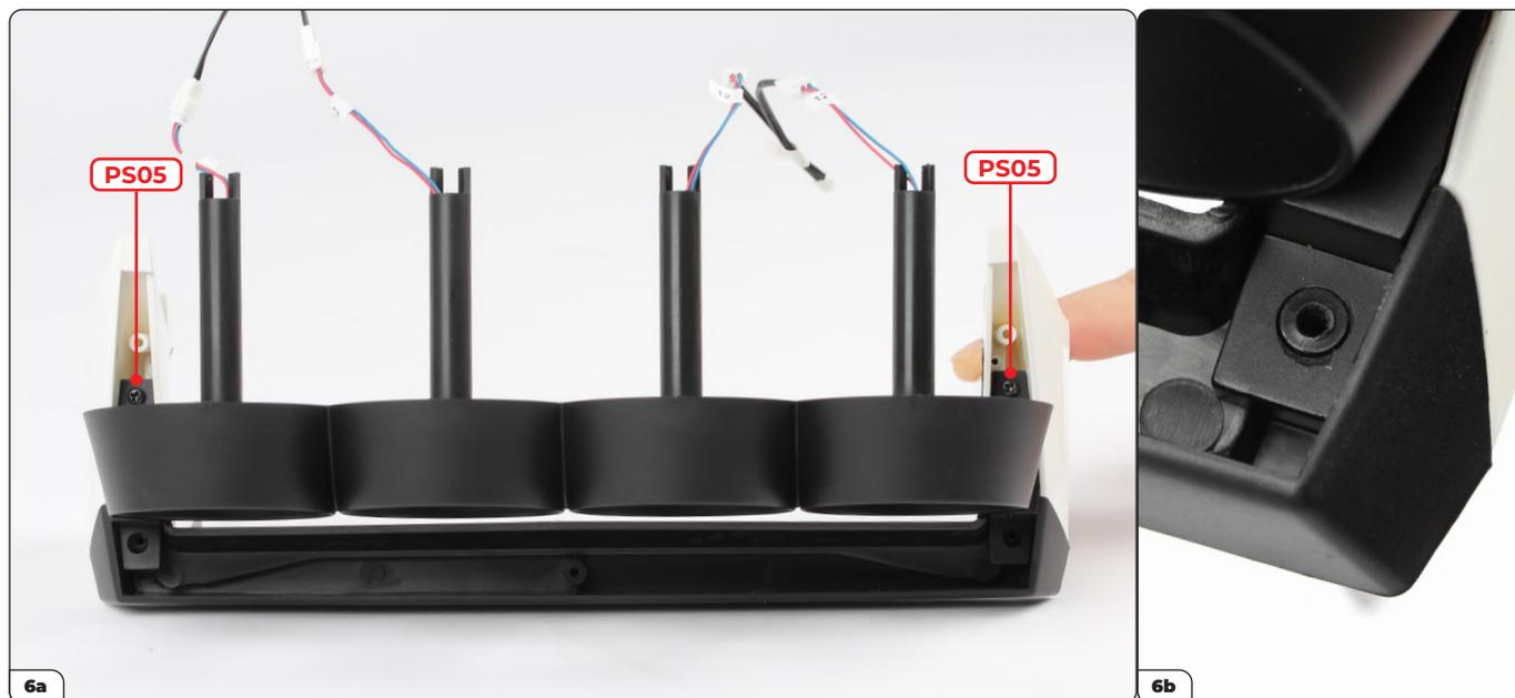
Vissez les pièces à l'aide de 2 vis PS05. Assurez-vous que les deux trous de vis du pare-chocs soient au même niveau que le trou des languettes du garde-hélice (6b).
