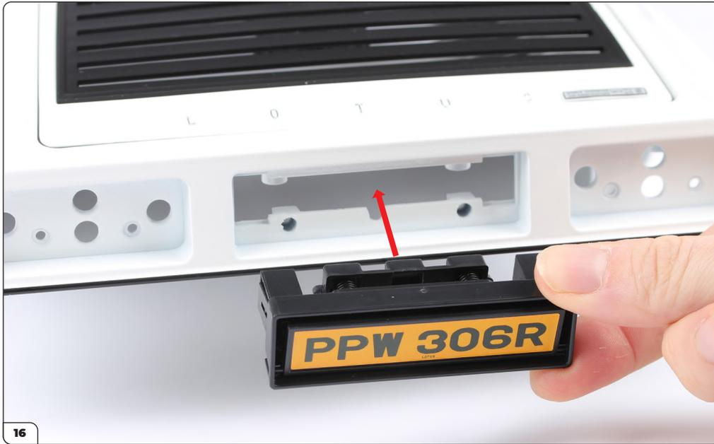
Alignez l'assemblage de la plaque avec l'ouverture sur la carrosserie (étape 082).
