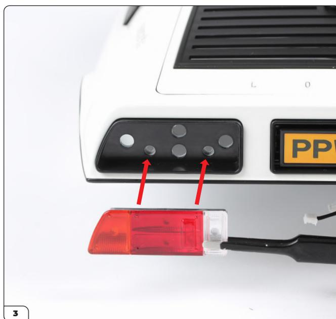
Enfoncez l'assemblage dans le boîtier du feu arrière.
