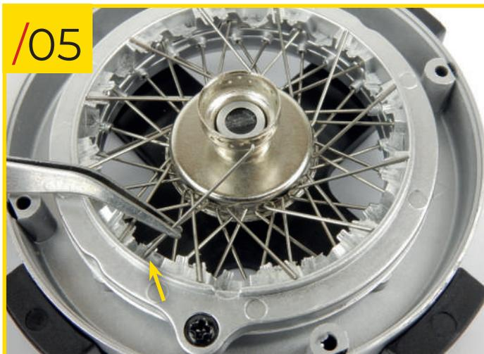
86/05 Servez-vous de la photo pour placer l'extrémité droite du rayon sur l'encoche au niveau inférieur de l'anneau de fixation des rayons. Répétez ces étapes pour les onze autres rayons de type C, jusqu'à ce que tous les trous de la rangée inférieure sur le moyeu soient remplis.
