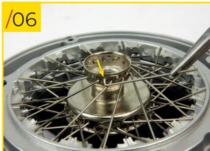
86/06 Insérez maintenant l'extrémité crochetée d'un rayon de type C dans l'un des trous de la rangée supérieure sur le moyeu de type C.
