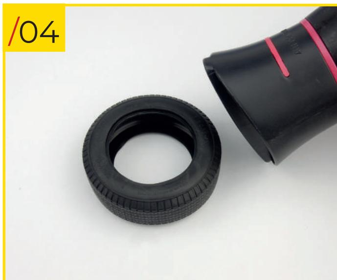
87/04 Avant d'ajouter le pneu au reste de la roue, nous vous recommandons de le chauffer légèrement (en utilisant un sèche-cheveux, par exemple) pour le rendre plus malléable.
