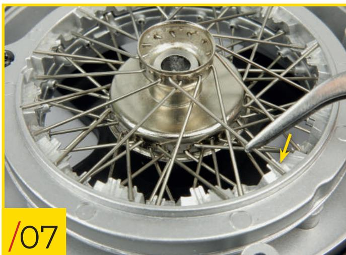
86/07 Placez l'extrémité droite du rayon sur l'encoche correspondante au niveau supérieur de la bague de retenue. Répétez ces étapes pour les onze autres rayons de type C, jusqu'à ce que tous les trous de la rangée supérieure sur le moyeu soient remplis.
