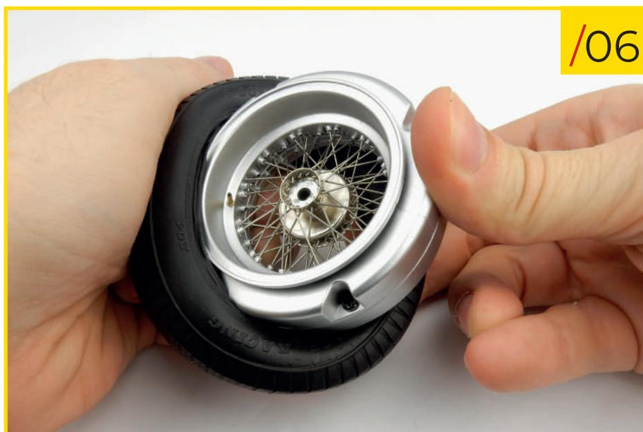
87/06 Montez le pneu sur la jante de la roue arrière droite.
