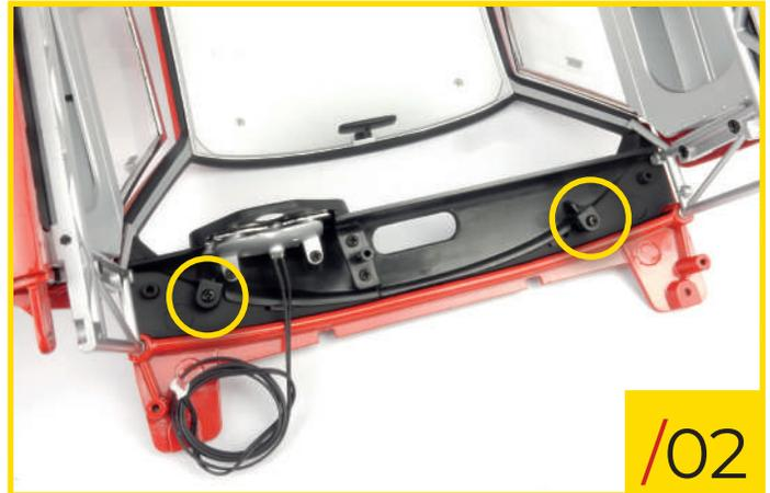
84/02 Récupérez le tableau de bord et placez-le dans sa position à l'intérieur de la carrosserie. Utilisez deux vis de type C (de l'étape 81) pour le fixer en place.
