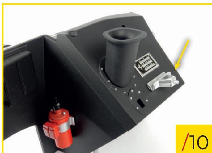
82/10 Enfoncez la plaque sur le pare-feu et installez le support du réservoir dans le sens indiqué.
