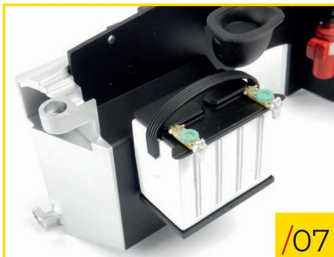
82/07 Ajoutez les deux bornes de la batterie et la poignée à l'assemblage.
