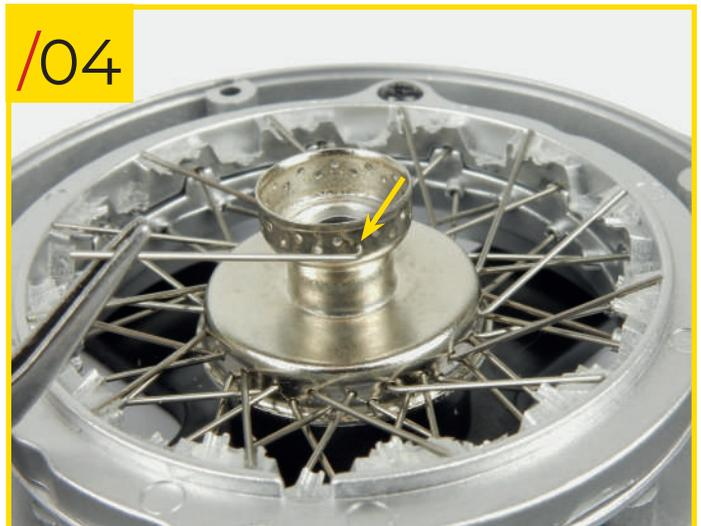
86/04 Insérez l'extrémité crochetée d'un rayon de type C dans l'un des trous de la rangée inférieure sur le moyeu de type C.
