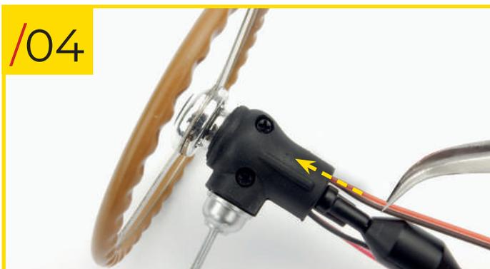
82/04 Pour éviter d'endommager le câble du klaxon lors des phases suivantes, nous vous recommandons de l'enfoncer vers le volant d'environ 0,5 à 1 cm.
