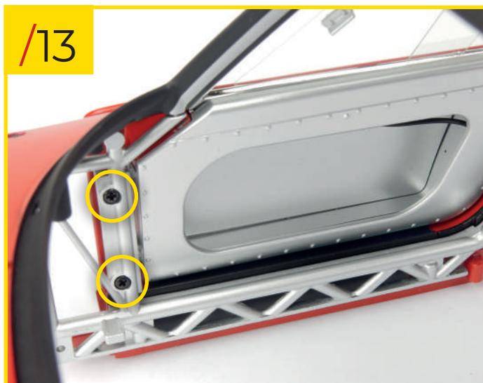
83/13 Vissez deux vis de type C (reçues lors des étapes 75 et 76) dans les trous indiqués. Répétez les phases 12 et 13 pour monter également la portière gauche sur la carrosserie.
