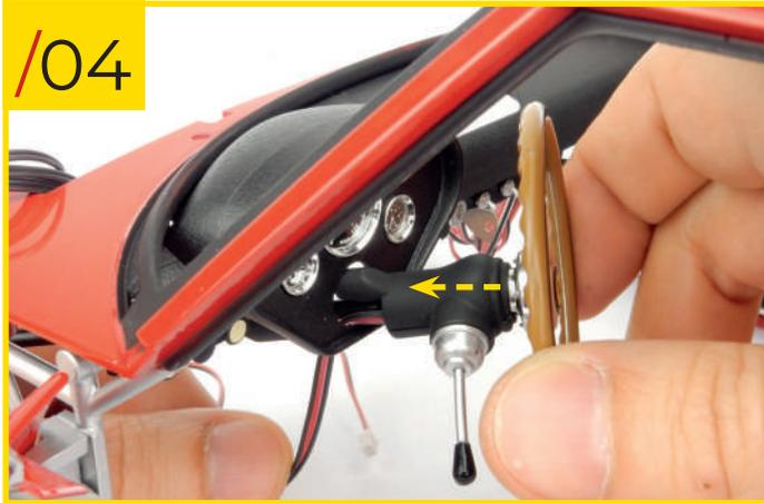
84/04 Récupérez le volant et insérez la colonne de direction, avec les deux câbles, dans le trou dédié du tableau de bord.
