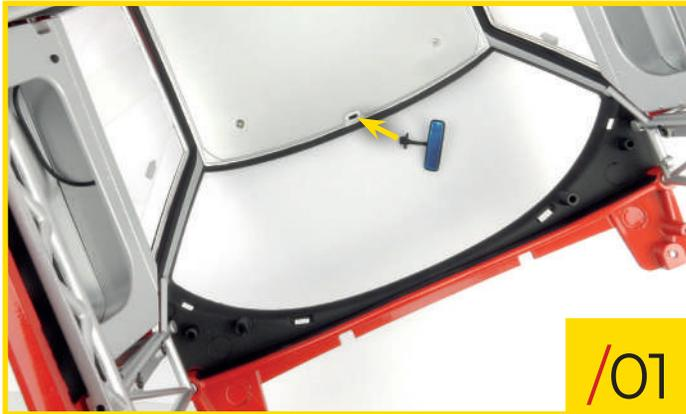
84/01 Enfoncez le rétroviseur que vous avez reçu avec l'étape 79 dans le trou prévu à cet effet sur le toit. Ne retirez pas le film bleu pour l'instant car il permet de protéger la surface du miroir lors des prochaines séances de montage.
