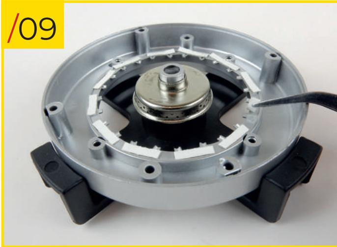
84/09 Placez le moyeu de type B au centre du gabarit. Une fois en place, mettez le moyeu de type A par-dessus. Avant d'ajouter les rayons, nous vous recommandons de coller de petites bandes de scotch double face sur le bord interne de la jante, ou de déposer une goutte de colle sur chaque rayon une fois en position.
