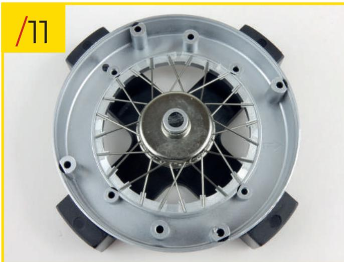
84/11 Positionnez maintenant les rayons de type A (ils sont plus longs que ceux de type B) en insérant leur extrémité crochetée dans la rangée supérieure de trous immédiatement à gauche des rayons de type B, en veillant à ce qu'ils passent au-dessus des rayons insérés dans la rangée inférieure de trous. Laissez toujours un trou libre entre chaque rayon comme auparavant.
