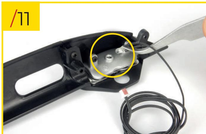
81/11 Recupere el montaje del salpicadero e inserte la luz LED del cable 1 (conector rojo) en el orificio en la parte trasera del panel de instrumentos. Tenga cuidado de no dañar el cable.
