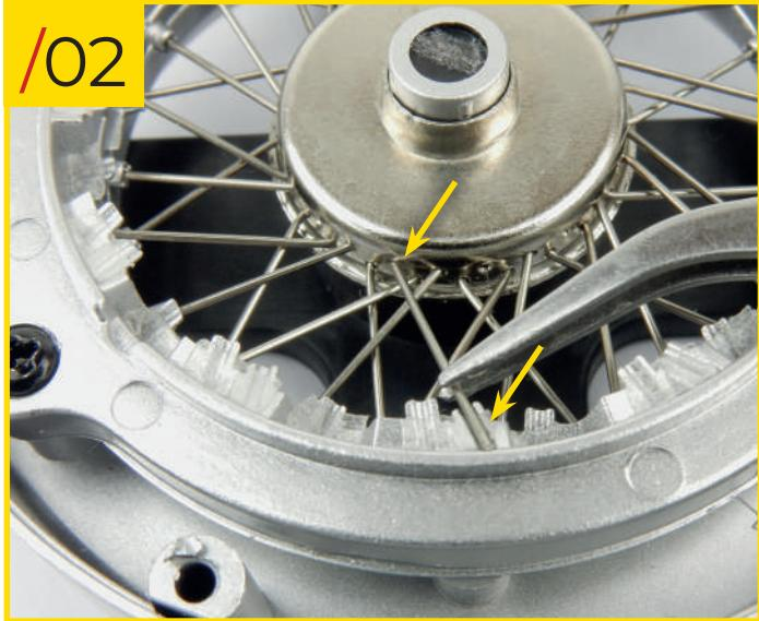
86/02 Inserte el extremo con gancho de los radios tipo A en los agujeros restantes del cubo tipo A. Utilice la foto para ayudar a orientar correctamente los radios y para colocar su extremo recto en la muesca correspondiente en el nivel superior de la carcasa.
