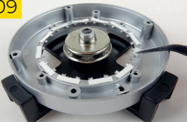
84/09 Coloque el cubo tipo B en el perno central del soporte; una vez en su lugar, coloque el cubo tipo A encima de este. Antes de añadir los radios, recomendamos que pegue algunas tiras pequeñas de cinta adhesiva doble cara en el borde interno de la llanta, o aplique una gota de pegamento en cada radio una vez que estén en posición.
