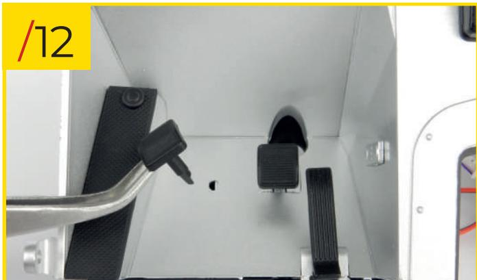
88/12 Coloque el pedal del embrague en su posición en la parte frontal del mamparo. Solo hay una forma en que las piezas pueden encajar.
