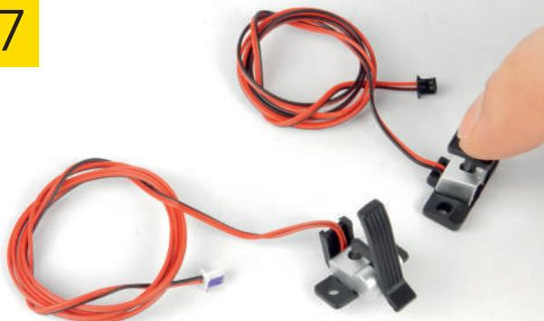
88/07 Presiona los dos pedales que has ensamblado hasta ahora para verificar que sus interruptores funcionen correctamente.
