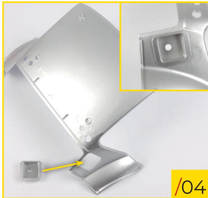
83/04 Inserte la boca de llenado del tanque de combustible en su posición dedicada en el revestimiento del techo.
