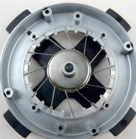
84/10 Posicione los radios tipo B (son más cortos que los tipo A) insertando su extremo enganchado en la fila inferior de agujeros en el cubo tipo A. Coloque el extremo recto de los radios en la muesca correspondiente en el borde de la llanta (en la cinta adhesiva doble cara). Siempre deje un agujero vacío entre cada radio.
