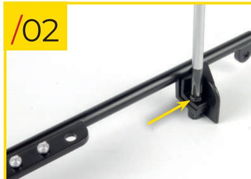
81/02 Recupera el soporte del tablero de instrumentos y coloca el soporte del motor en la posición indicada en la foto. Asegura las piezas utilizando un tornillo tipo B.
