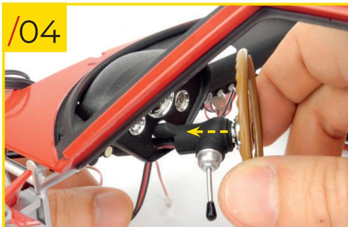
84/04 Recupere el volante e inserte la columna de dirección, con ambos cables, en el orificio dedicado en el salpicadero.
