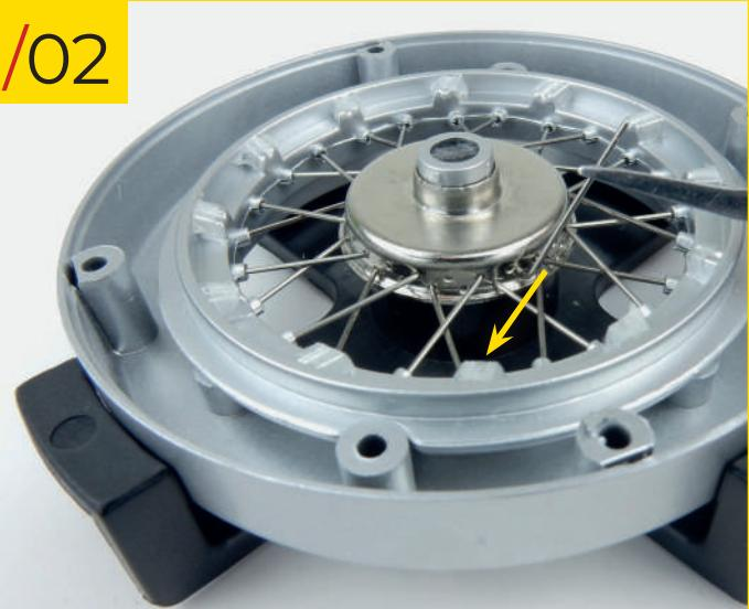
85/02 Inserte el extremo con gancho de los radios tipo A que recibió con esta etapa en los agujeros restantes en la fila inferior del cubo. Coloque el extremo recto de los radios en la muesca correspondiente en el borde del anillo retenedor de radios 1. Utilice la foto para ayudar a orientar correctamente los radios.
