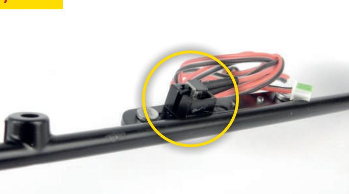
81/05 Inserte el interruptor que está conectado al cable 2 (conector verde) en la posición dedicada en la parte trasera del soporte. Oriente las piezas como se muestra en la foto.
