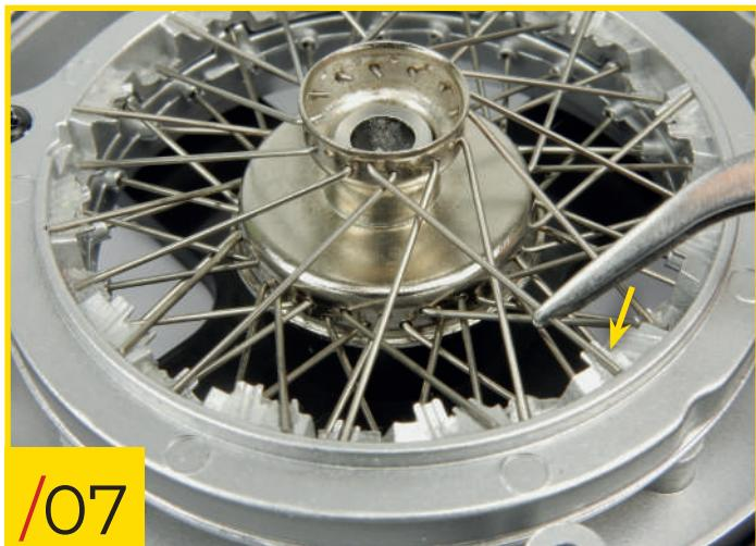
86/07 Coloqué el extremo recto del radio en la muesca correspondiente en el nivel superior del anillo retenedor. Repita estos pasos para los otros once radios tipo C, hasta que todos los agujeros en la fila superior del cubo estén llenos.
