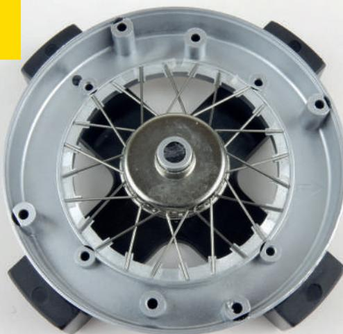
84/11 Ahora coloca los radios tipo A (que son más largos que los tipo B) insertando su extremo con gancho en la fila superior de agujeros inmediatamente a la izquierda de los radios tipo B, asegurándote de que pasen por encima de los radios insertados en la fila inferior de agujeros. Siempre deja un agujero vacío entre cada radio como antes.
