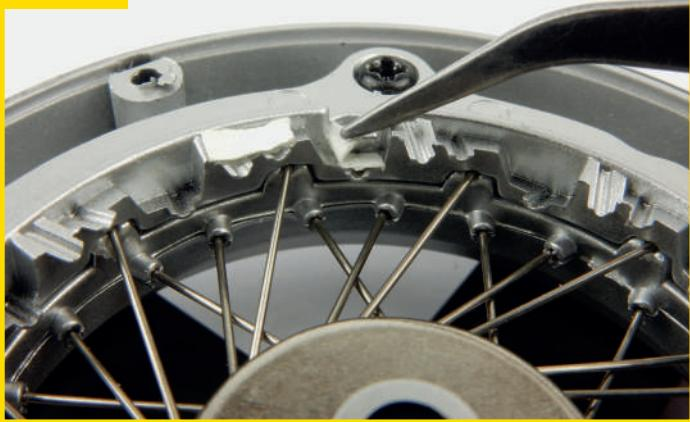
86/01 Coloque la rueda trasera derecha que ensambló en las etapas anteriores sobre su superficie de trabajo. Antes de proceder con el montaje, le recomendamos que pegue pequeñas tiras de cinta adhesiva de doble cara en el borde lateral del anillo retenedor de los radios 2 o que añada una gota de cola a los radios una vez estén en posición.
