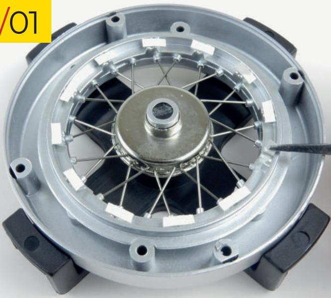
85/01 Coloque la rueda trasera derecha que ensambló en la etapa 84 sobre su superficie de trabajo. Antes de proceder, recomendamos que pegue pequeñas tiras de adhesivo doble cara en el borde lateral del anillo retenedor de los radios. Alternativamente, puede colocar todos los radios en posición y luego aplicar una gota de pegamento en cada uno después del paso 85/03.
