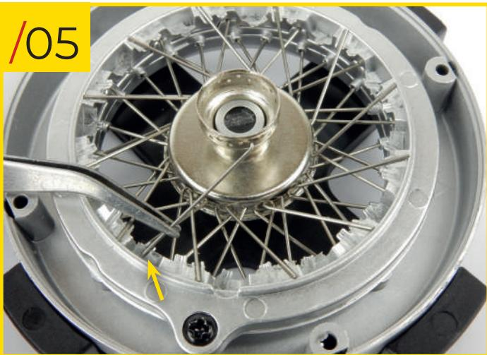
86/05 Utiliza la foto para ayudar a colocar el extremo recto del radio en la muesca del nivel inferior del anillo de retención. Repite estos pasos para los otros once radios tipo C, hasta que todos los agujeros en la fila inferior del cubo estén llenos.
