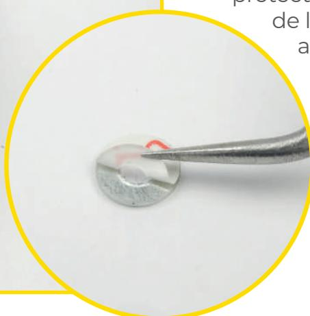
87/02 Con el lado de la arandela que tenía la película removida hacia abajo, insértala en el cubo tipo C, como se muestra en la foto.
