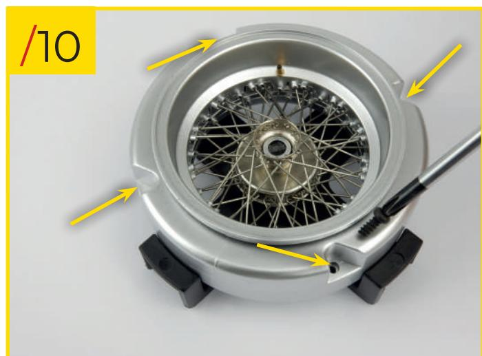
86/10 Asegure la llanta al resto de la rueda utilizando cuatro tornillos tipo B.
