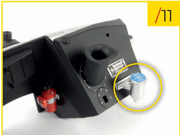
82/11 Coloque el depósito del líquido de frenos en el soporte y agregue la tapa del depósito.
