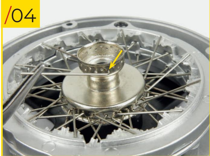
86/04 Inserte el extremo enganchado de uno de los radios tipo C en uno de los agujeros de la fila inferior en el cubo tipo C.
