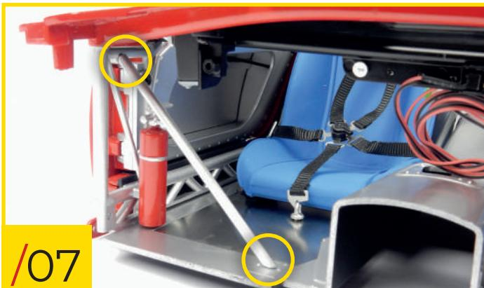
89/07 Coloque la varilla de soporte en la posición indicada en la foto, en el lado derecho del compartimiento del pasajero. Oriente las piezas como se muestra.
