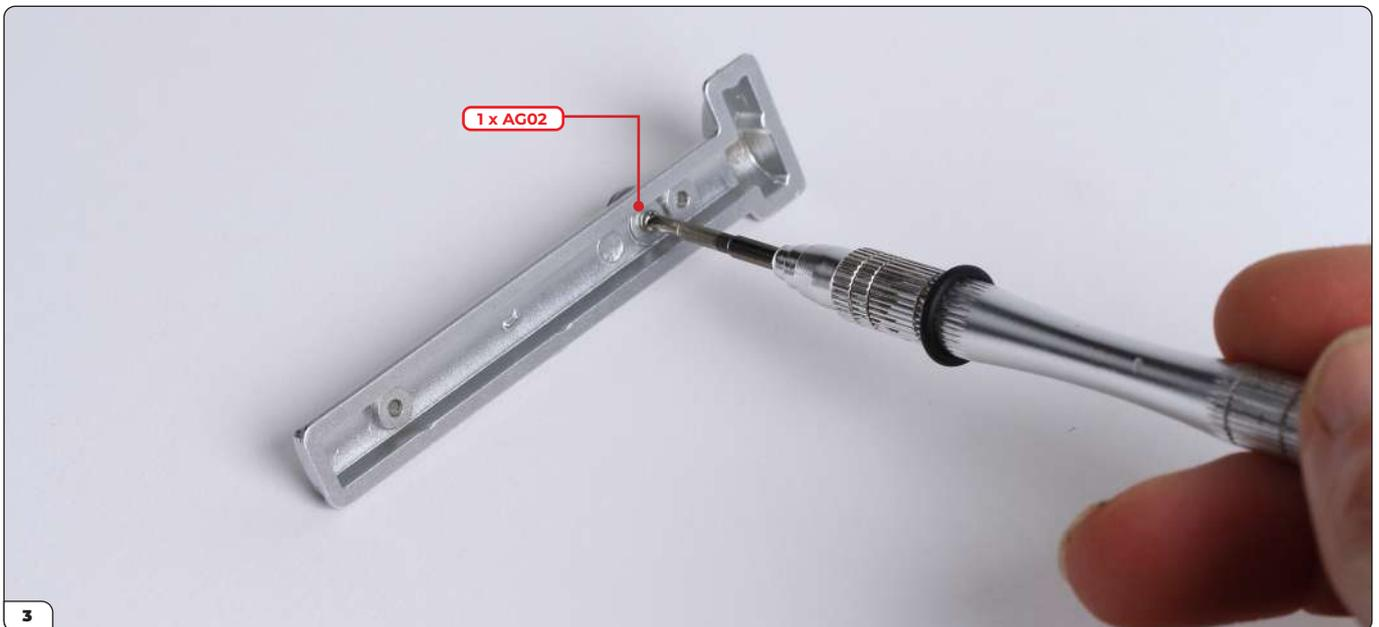
Verschrauben Sie die Teile von der Rückseite mit einer AG02-Schraube.
