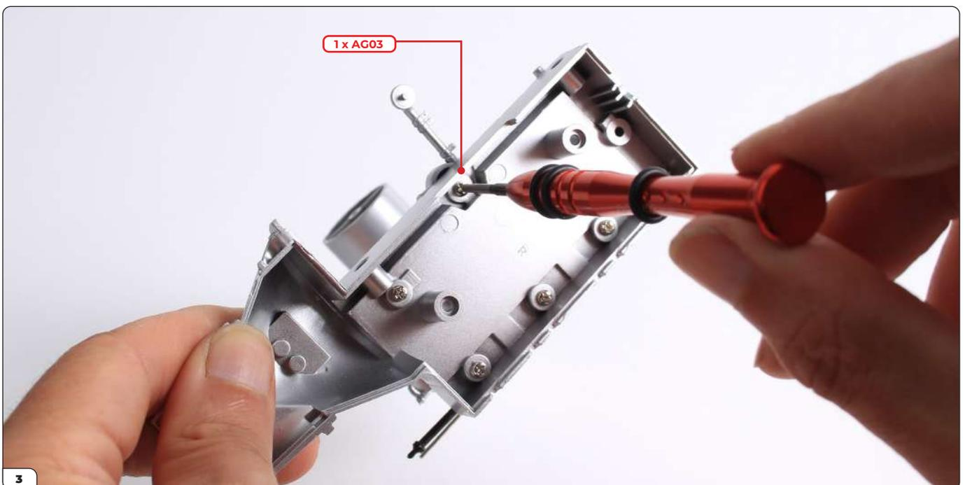
Verschrauben Sie die Teile von der Rückseite mit einer AG03-Schraube.
