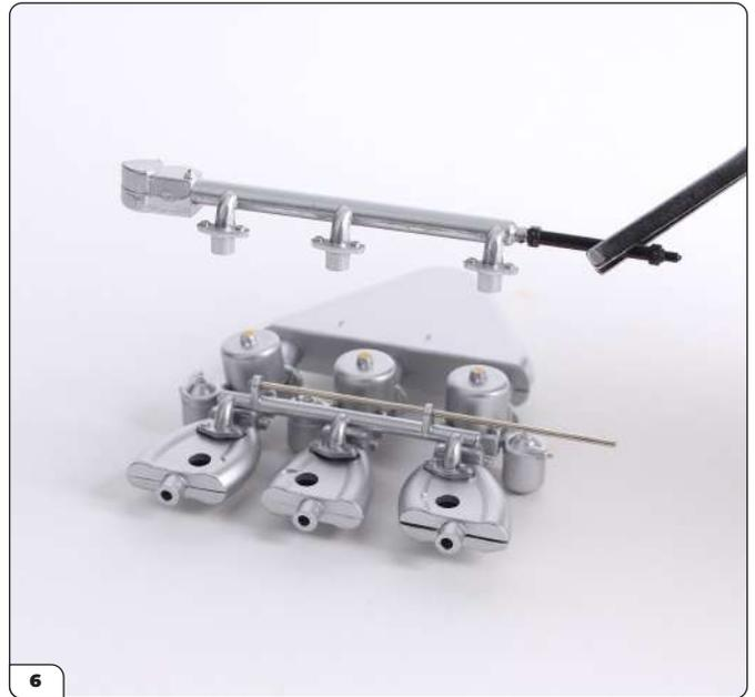
Richten Sie die drei Zapfen am Luftrohr auf die drei Löcher am Auspuffkrümmer aus und stecken Sie das Luftrohr hinein.
