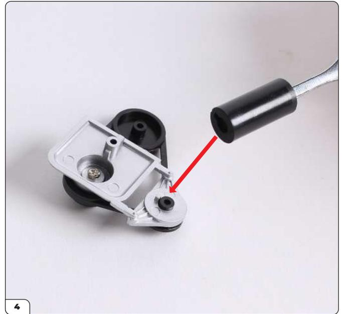
Richten Sie das schlüsselförmige Loch am Ende des Dynamos auf den entsprechenden Zapfen auf der Zahnriemenabdeckung aus.
