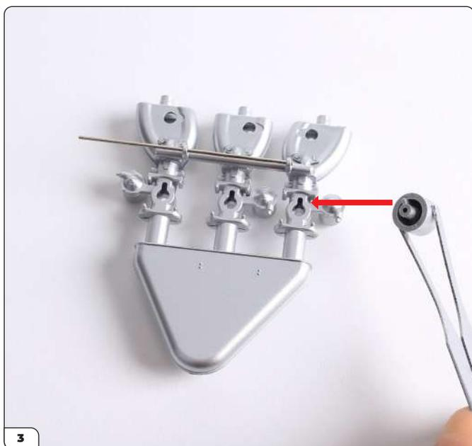
Nehmen Sie eine der Ansaugkammern aus der vorherigen Bauphase und stecken Sie sie in das schlüsselförmige Loch am Vergaser.
