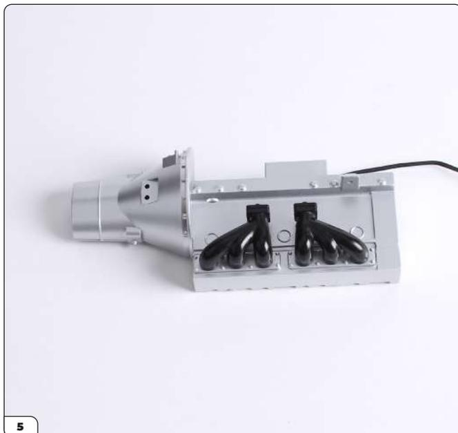
Positionieren Sie den hinteren Auspuffkrümmer in die drei freien Löcher und stecken Sie ihn fest hinein.
