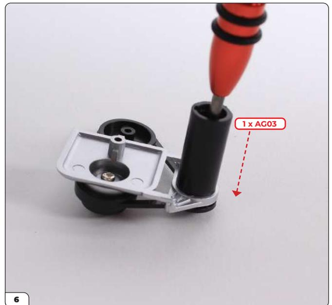
Drehen Sie eine AG03-Schraube durch das Gehäuse des Dynamos und ziehen Sie sie fest, um den Dynamo an seiner Position zu fixieren.
