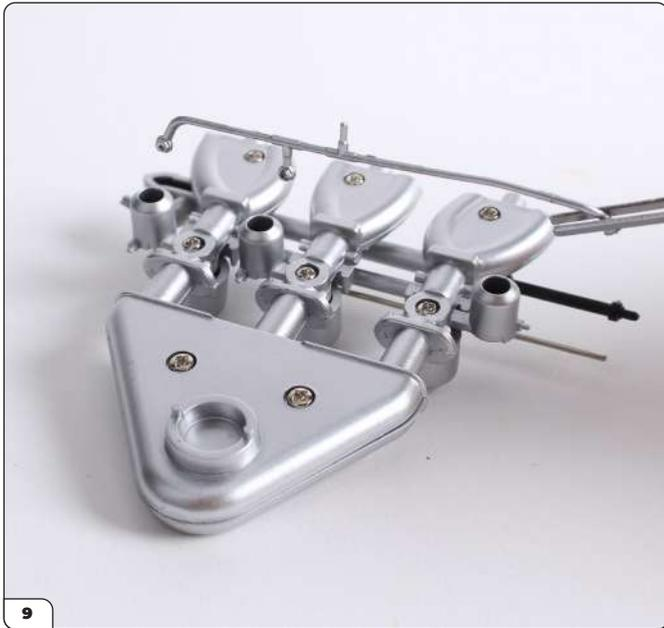
Richten Sie das Benzinrohr wie gezeigt auf die Baugruppe aus. Das Benzinrohr wird an drei Stellen befestigt. Diese Stellen sind im nächsten Bild mit Kreisen gekennzeichnet.
