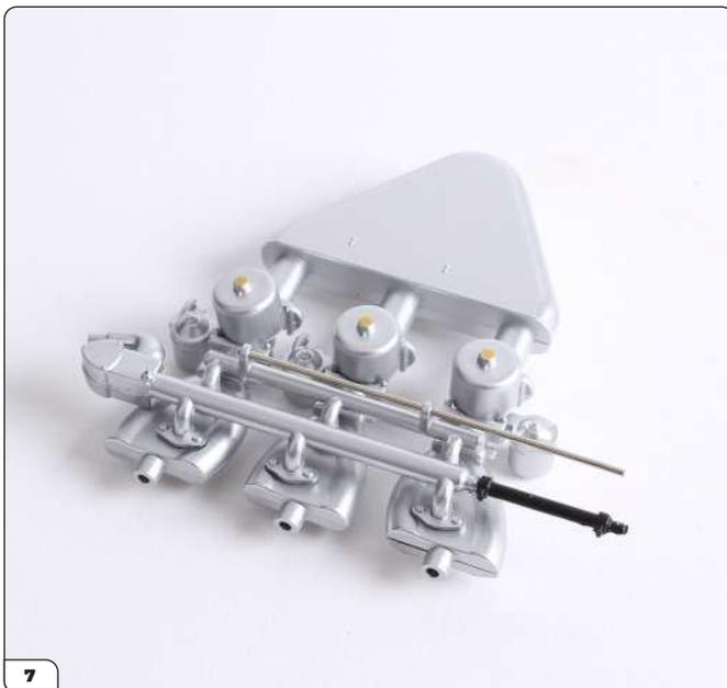
Dieses Bild zeigt das richtig positionierte Luftrohr.
