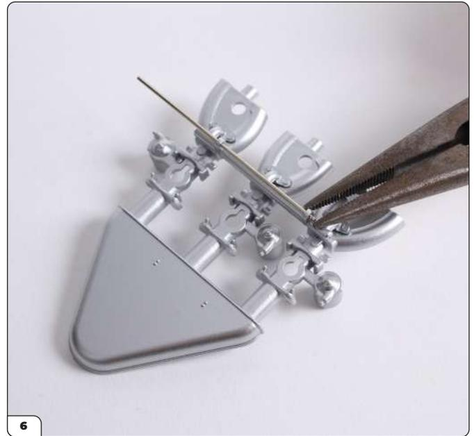
Drücken Sie das gerillte Ende der Welle mithilfe einer Zange durch das erste kleine Loch, um die Welle in ihrer Position zu verankern.
