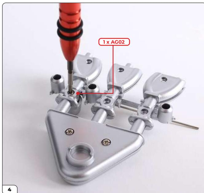
Befestigen Sie sie von der Rückseite mit einer AG02-Schraube.
