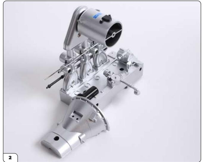
Stecken Sie den Filterkopf hinein. Das Rohr muss vom Block nach außen zeigen.
