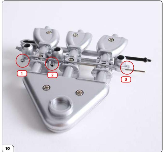
Für diesen Schritt benötigen Sie eine Pinzette. Schieben Sie das Loch auf der linken Seite des Rohrs über den hervorstehenden Stift an der unteren Schwimmerkammer (1). Schieben Sie das mittlere Loch am Rohr über den Stift an der mittleren Schwimmerkammer (2), und schieben Sie dann das letzte Loch über den Stift an der dritten Schwimmerkammer auf der rechten Seite (3). Geben Sie bei Bedarf einen Tropfen Sekundenkleber drauf.
