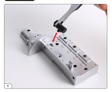
FIT THE STARTER MOTOR AND DISTRIBUTOR TO THE ENGINE BLOCK
