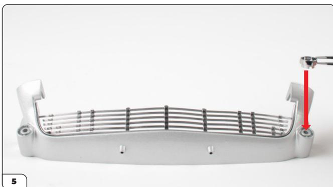
Richten Sie eines der Blinkergehäuse wie abgebildet auf die Aussparung auf der linken Seite aus.
