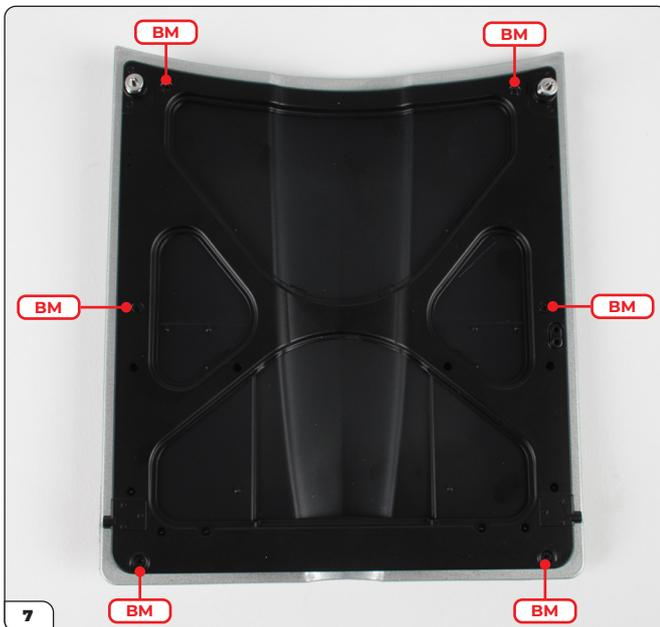
Bringen Sie die Verstärkung auf der Motorhaube an und befestigen Sie sie dann mit 6 BM-Schrauben. Beginnen Sie in jeder Ecke und ziehen Sie eine Eckschraube halb fest, um die Verstärkung zu fixieren. Ziehen Sie dann vorsichtig alle sechs Schrauben an, sobald Sie alle Schrauben eingesetzt und halb angezogen haben.
