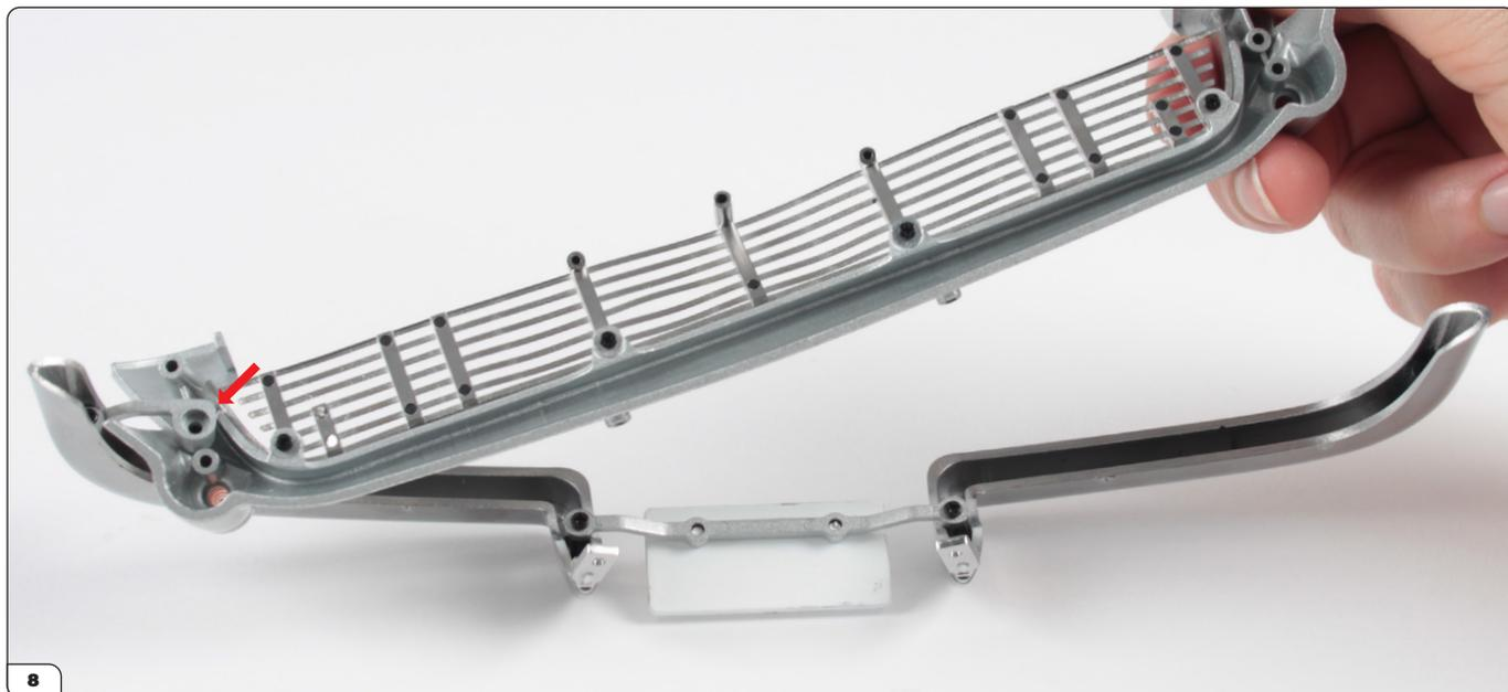
Beginnen Sie mit dem Einsetzen der Karosserieplatte in die Stoßstangen, indem Sie das mittlere Loch, das im vorherigen Schritt markiert wurde, unter der Halterung für die Stoßstange positionieren (siehe Pfeil). Sobald die Platte an ihrem Platz ist, senken Sie sie vorsichtig auf die Stoßstangen ab.
