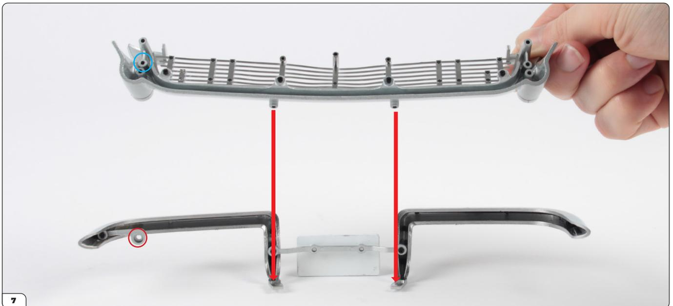
Nehmen Sie die Karosseriefrontplatten-Baugruppe aus Bauphase 01 und richten Sie sie wie gezeigt auf die Stoßstangen aus. Auf der Unterseite der Platte befinden sich zwei erhöhte Schraublöcher, die über die aus den Stoßstangen herausragenden Laschen passen (siehe Pfeile). Die Halterung (rot eingekreist) passt in das mittlere Loch auf der linken Seite der Platte (blau eingekreist).
