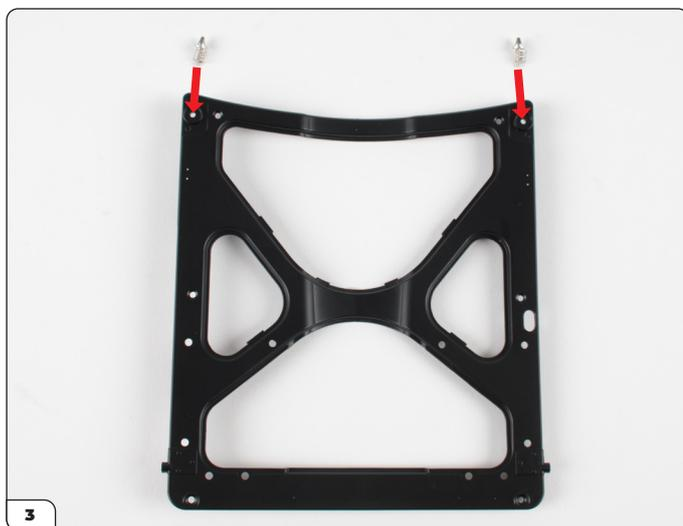
3 Legen Sie die Verstärkung für die Motorhaube mit der detaillierten Seite nach oben auf Ihre Arbeitsplatte, wie im Bild links gezeigt. Die zusammengebauten Verriegelungsstifte (mit Federn) werden in die äußersten Löcher gesteckt, wie durch die Pfeile (links) angezeigt und im vergrößerten Bild oben dargestellt.
