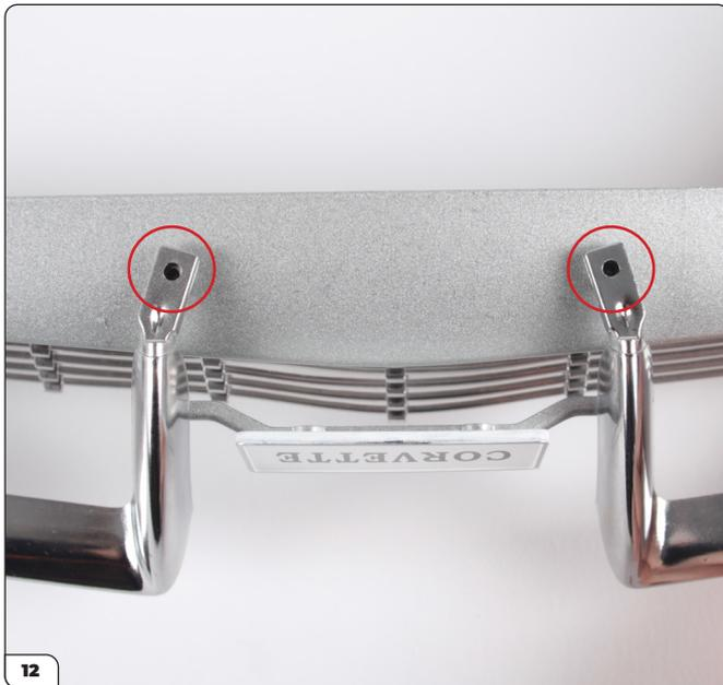
Drehen Sie die Baugruppe um und richten Sie die Laschen der Stoßstangen über den Schraublöchern der Platte aus (eingekreist).
