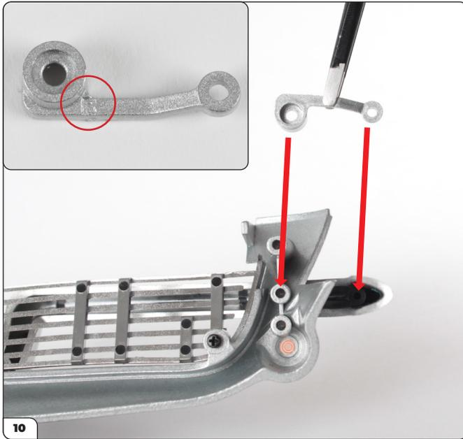
Nehmen Sie die rechte Halterung für die Stoßstange (mit einem „R“ gekennzeichnet, siehe kleines Bild) und richten Sie sie wie abgebildet auf der rechten Seite der Baugruppe aus.
