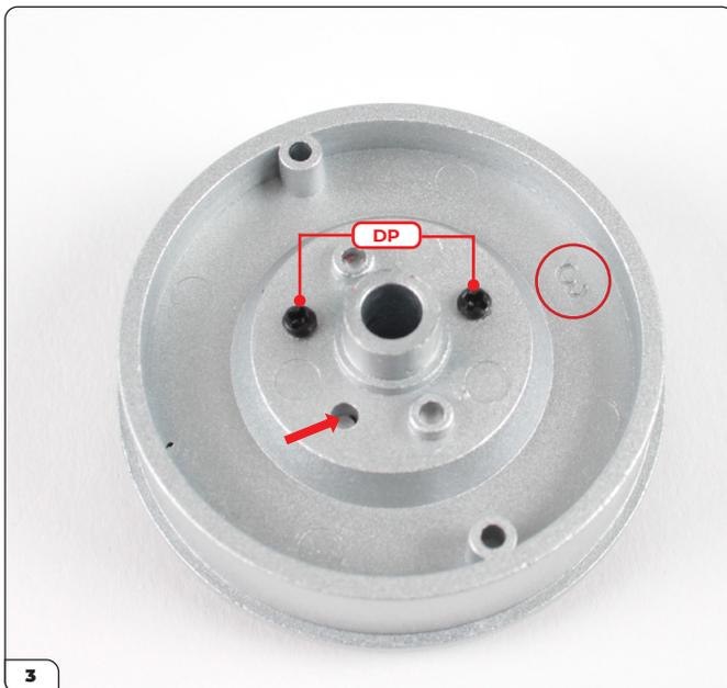
Drehen Sie die Baugruppe um und legen Sie sie wie abgebildet auf Ihre Arbeitsplatte. Beachten Sie dabei die Ausrichtung der „3“ (eingekreist). Befestigen Sie die Teile mit 2 DP-Schrauben in den im Bild gekennzeichneten Löchern. Vergewissern Sie sich, dass Sie die richtigen Schraublöcher identifiziert haben – eines davon (siehe Pfeil) muss frei bleiben.
