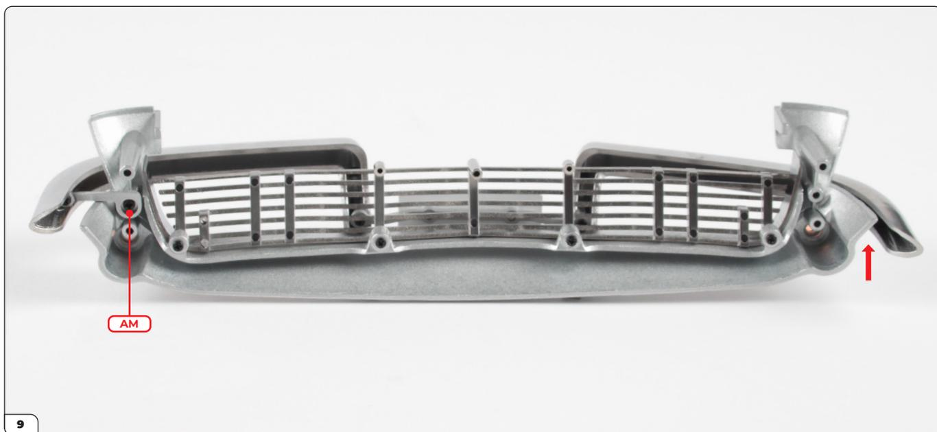
Die Baugruppe sollte so aussehen, wenn die Platte und die Stoßstangen zusammengesetzt sind. Befestigen Sie die Halterung für die Stoßstange und die Platte mit einer AM-Schraube. Beachten Sie, dass die rechte Stoßstange und die rechte Seite der Platte (siehe Pfeil) noch lose sind. Achten Sie darauf, dass Sie beim Eindrehen der Schraube keine Teile beschädigen.
