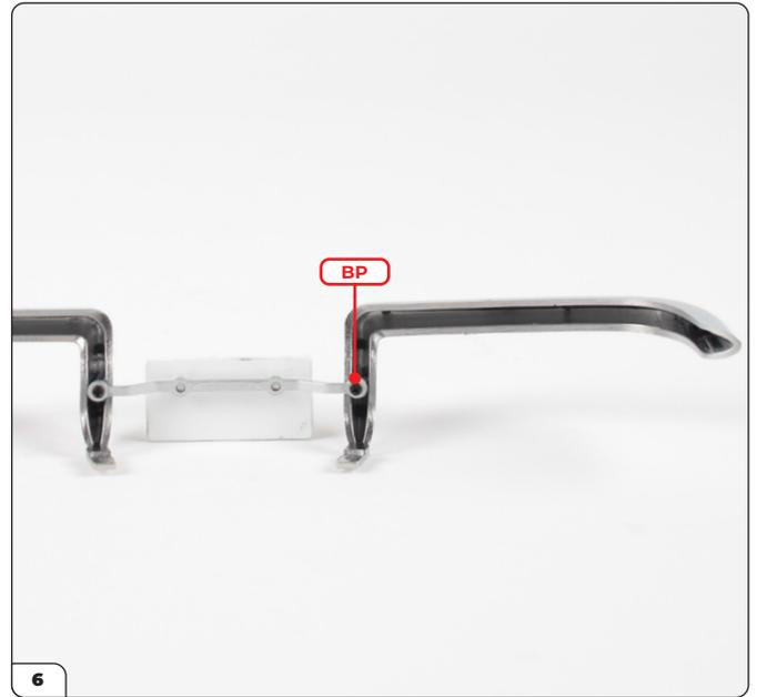
Nehmen Sie die vordere rechte Stoßstange und befestigen Sie die rechte Seite der Halterung auf die gleiche Weise mit einer weiteren BP-Schraube am Schraubzapfen.
