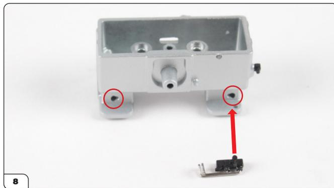
Placez le boîtier du système d'injection sur votre plan de travail. Prenez la buse gauche (broche formée), et alignez-la sur le trou indiqué par la flèche.
