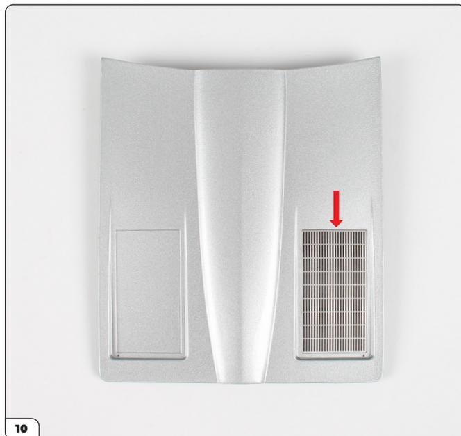
Alignez l'autocollant de l'évent sur le renforcement du capot et utilisez la face adhésive pour le coller. Commencez par positionner soigneusement le haut (flèche), vérifiez que les bords de chaque côté soient bien alignés puis abaissez lentement.
