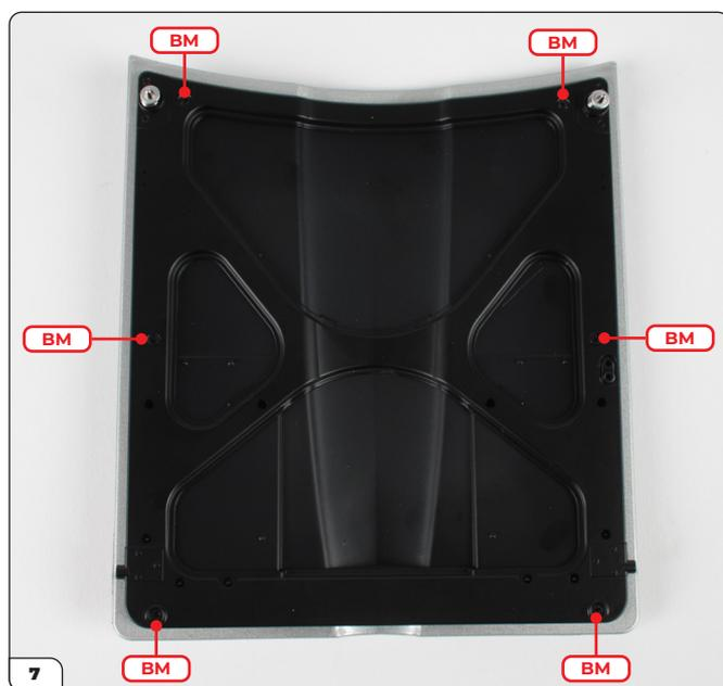
Placez le renforcement sur le capot, puis fixez-le avec 6 vis BM. Commencez par chaque coin, en serrant à moitié une vis d'angle pour maintenir le renfort en place, puis serrez doucement une fois que les six vis sont en place.
