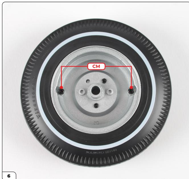
Insérez la jante intérieure dans le pneu et fixez-la avec deux vis CM. Vérifiez que le bord intérieur du pneu est correctement logé sous le rebord de la jante.
