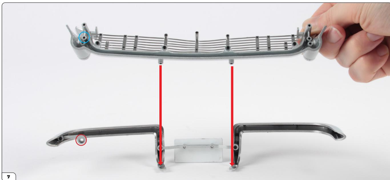
Récupérez le panneau avant de la carrosserie issu de l'étape 01 et alignez-le sur les pare-chocs tel qu'indiqué sur la photo. La face inférieure du panneau comporte deux pas de vis en saillie qui s'insèrent dans les languettes dépassant des pare-chocs (cf. flèches). Le support (entouré en rouge) s'insère dans le trou central sur le côté gauche du panneau (entouré en bleu).
