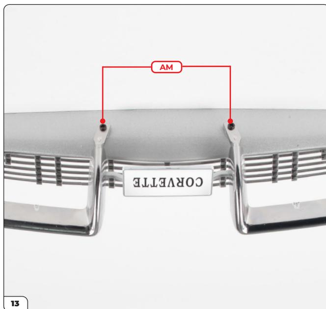
Mettez les languettes en place avec 2 vis AM.
