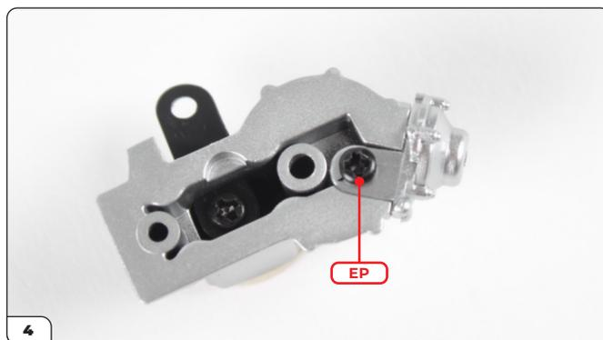
Insérez la languette du boîtier d'enrichissement dans le pas de vis du corps et fixez-la avec une vis EP.
