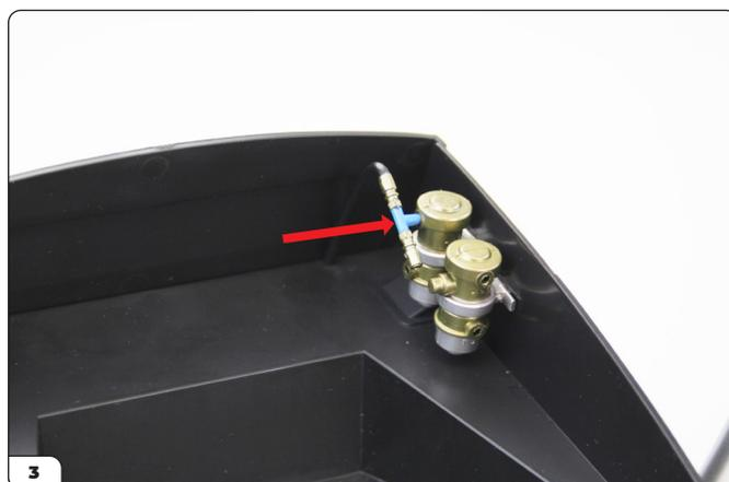
Poussez la cheville bleue de la durite de la pompe à carburant 2 dans le trou inférieur de la pompe à carburant 1.
