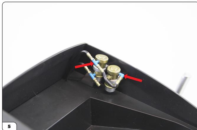
Insérez la cheville bleue de la durite de la pompe à carburant 4 dans le trou latéral inférieur de la pompe à carburant 2. Insérez l'extrémité libre de la durite 4 dans l'extrémité de la durite de la pompe à carburant 2.
