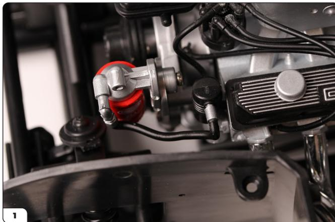
Prenez la durite 99c et placez une extrémité dans le trou sur le carter du volant d'inertie comme indiqué. L'extrémité supérieure de la durite 99c n'est pas connectée pour l'instant.
