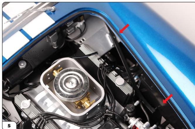
Prenez la durite 99e et enfoncez une extrémité dans l'appareil 9 (étape 64) et l'autre extrémité dans le pare-feu, comme illustré, image 6. Les trous dans le pare-feu peuvent être agrandis avec un poinçon ou une petite perceuse si nécessaire.
