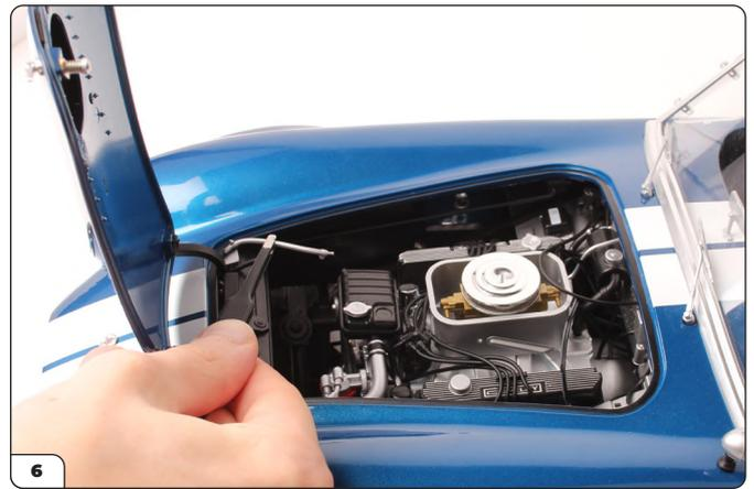
Prenez le système d'actionneur de carburateur (100c) et poussez les goupilles sur la plaque supérieure de l'arbre de direction (99d, images 8 et 9 ci-dessous).
