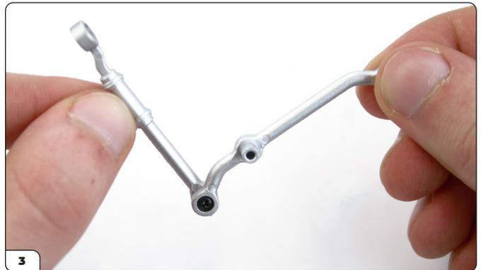
Nehmen Sie die aus der rechten Spurstange und der mittleren Spurstange bestehende Baugruppe. Legen Sie das freie Schraubloch am Ende der mittleren Spurstange wie in der Abbildung gezeigt auf das Schraubloch am Ende der Zahnstange. Verschrauben Sie die beiden Teile mit einer weiteren MD06-Schraube. Ziehen Sie auch hier wieder die Schraube nur so weit fest, dass die Teile sich weiterhin frei bewegen können.
