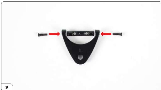
Legen Sie die linke Welle in den linken Querlenker und nehmen Sie 2 IM-Schrauben, die von außen durch den Querlenker eingedreht werden (siehe Pfeile).
