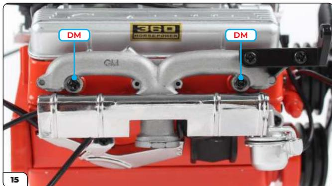
Bringen Sie den rechten Auspuffkrümmer wieder mit den beiden DM-Schrauben, die Sie zuvor entfernt hatten, wieder an der Baugruppe an.
