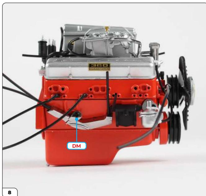
Bringen Sie die Abschirmung an und befestigen Sie sie dann mit einer DM-Schraube.
