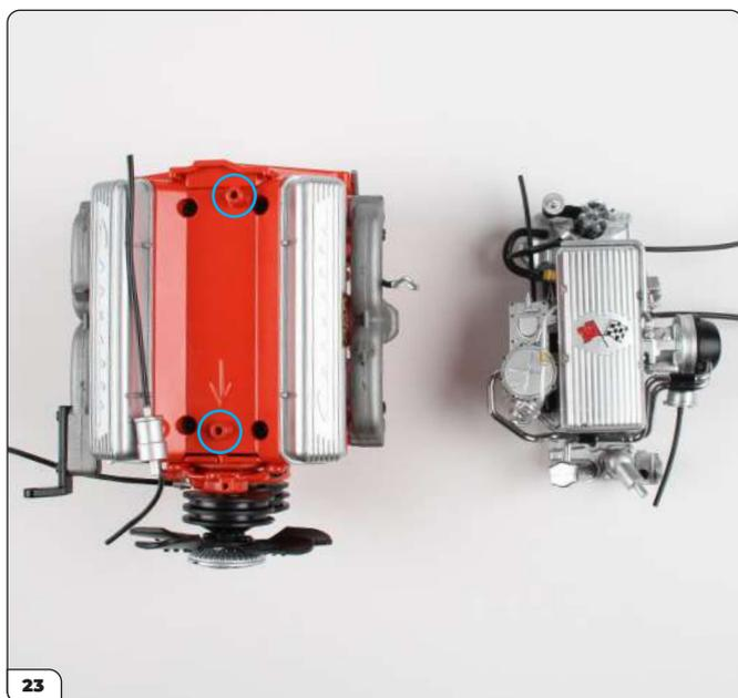
Richten Sie die Kraftstoffeinspritzanlage aus Bauphase 11 wie gezeigt auf die Baugruppe aus. Suchen Sie die beiden Löcher am Motorblock (eingekreist), die für die Montage der Kraftstoffeinspritzanlage vorgesehen sind.
