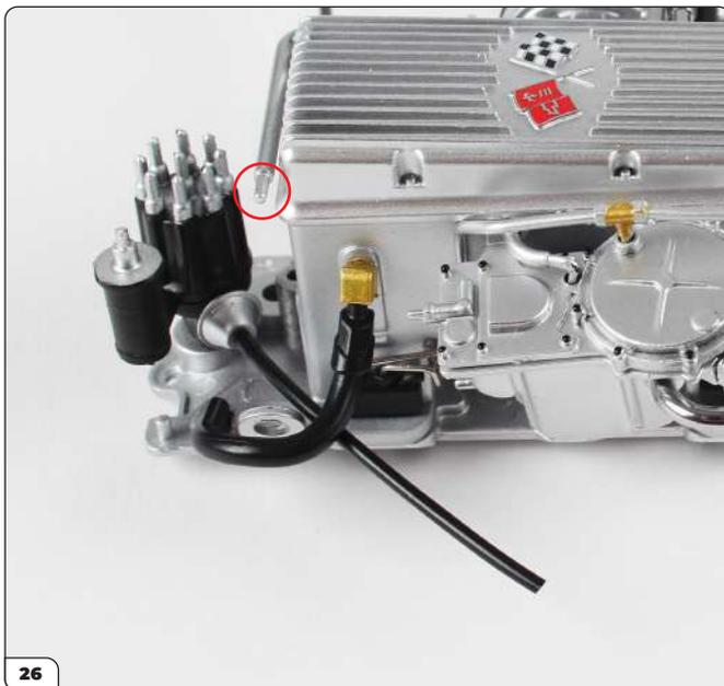
Bringen Sie den Kraftstoffschlauch an. Beachten Sie den silbernen Stift am Kraftstoffrohr (eingekreist).
