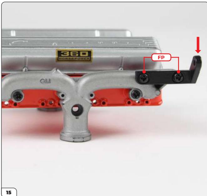
Legen Sie die Halterung an und befestigen Sie sie dann mit 2 FP-Schrauben. Beachten Sie, dass die Lasche der Halterung nach oben zeigt (siehe Pfeil).
