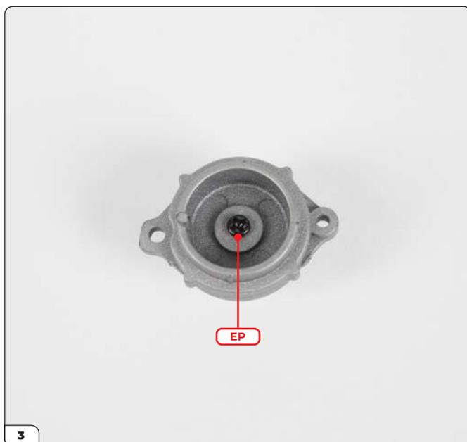
Befestigen Sie die Lichtmaschine mit einer EP-Schraube.
