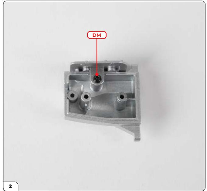
Legen Sie die Lasche über das Schraubloch und befestigen Sie die Abdeckung dann mit einer DM-Schraube.
