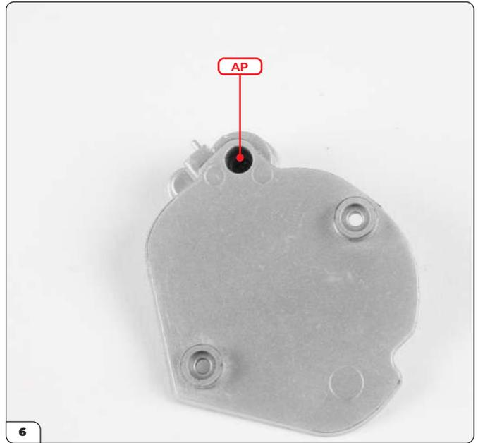
Stecken Sie die beiden Teile zusammen und verschrauben Sie sie mit einer AP-Schraube.
