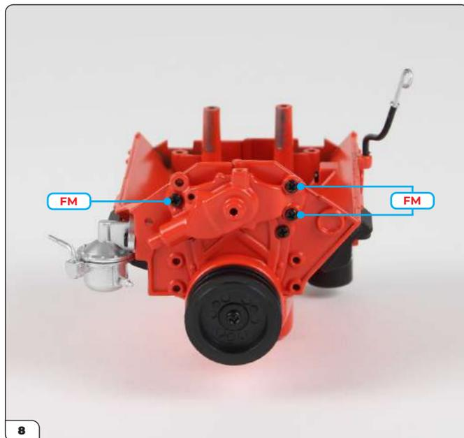
8 Bringen Sie die Pumpe an und befestigen Sie sie mit 3 FM-Schrauben.
