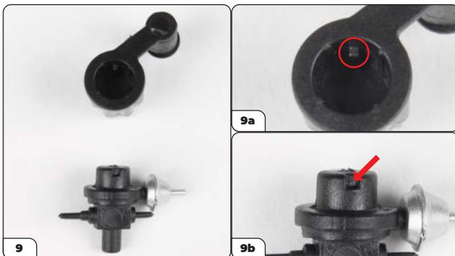
9 Suchen Sie die Vorwölbung im Inneren der Spule (eingekreist, 9a). Sie passt in die Kerbe am oberen Rand des Verteilers (siehe Pfeil, 9b).
