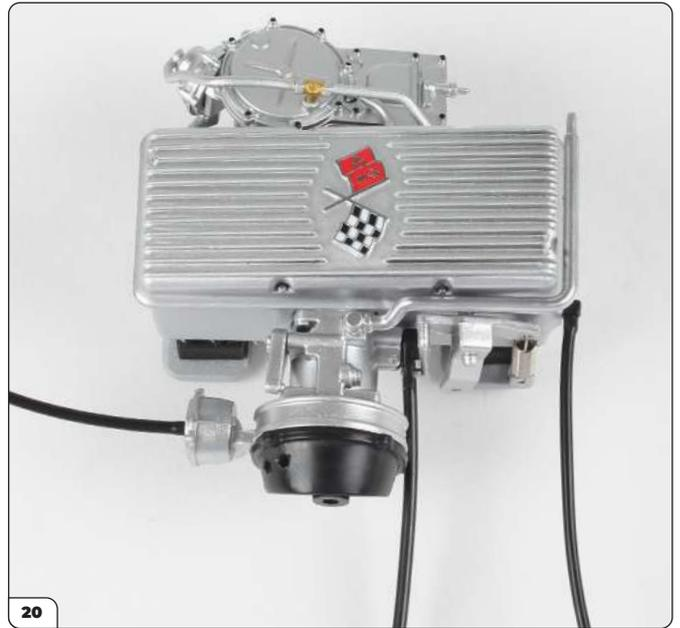
In diesem Bild ist das angebaute lange Kraftstoffrohr zu sehen.
