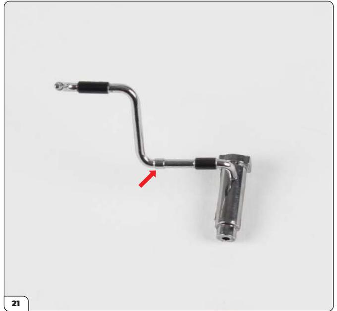
Bauen Sie das kurze Kraftstoffrohr und den Kraftstoffeinfüllstutzen wie gezeigt zusammen. Das Detail am Rohr (siehe Pfeil) muss näher am Einfüllstutzen sein.
