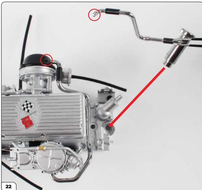
Stecken Sie den Kraftstoffeinfüllstutzen in das vertiefte Schraubloch (siehe Pfeil). Stecken Sie dann den Stift in das verbleibende Loch im Diffuserkegel (eingekreist).
