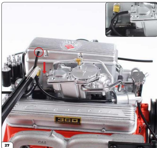
Suchen Sie das Ende des längeren Schlauches, der am Kraftstofffilter (eingekreist) angeschlossen ist. Stecken Sie dieses Ende auf den Stift am Kraftstoffmesser (siehe Pfeil).
