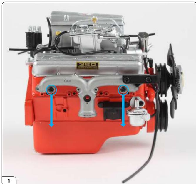
Nehmen Sie die Motorblock-Baugruppe aus der vorherigen Bauphase und entfernen Sie die DM-Schrauben vom rechten Auspuffkrümmer.
