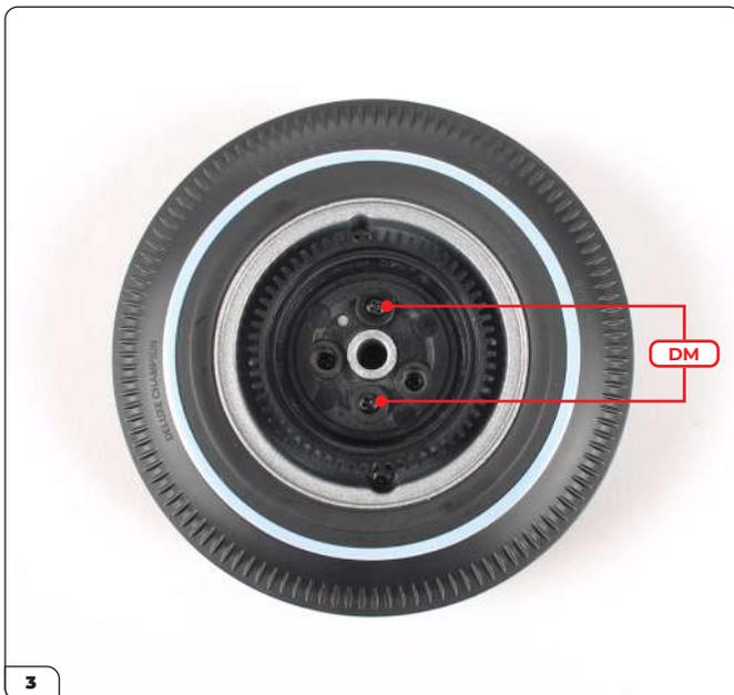
3 Legen Sie die Trommel auf die Felge und befestigen Sie sie mit 2 DM-Schrauben.
