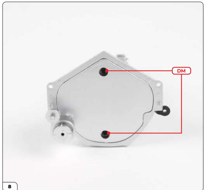
Legen Sie die Abdeckung auf und befestigen Sie sie dann mit 2 DM-Schrauben.
