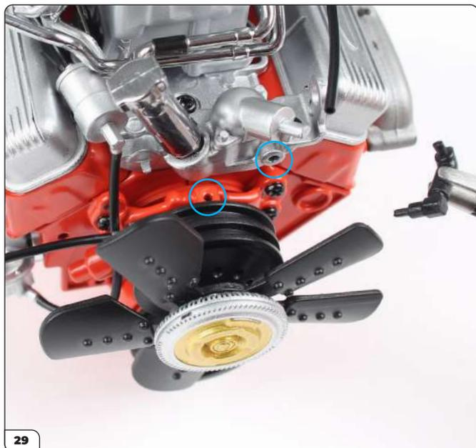
Der kurze Schlauch passt in die beiden Löcher an der Vorderseite der Baugruppe (eingekreist).
