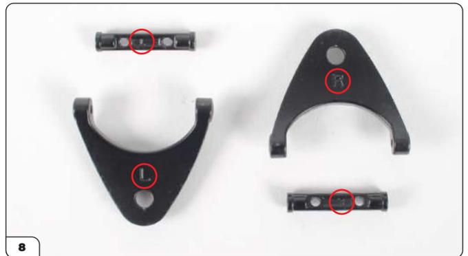
Sortieren Sie die Querlenker und die Querlenker-Wellen in links und rechts, indem Sie das auf jedem Teil aufgedruckte „L“ und „R“ (eingekreist) suchen.
