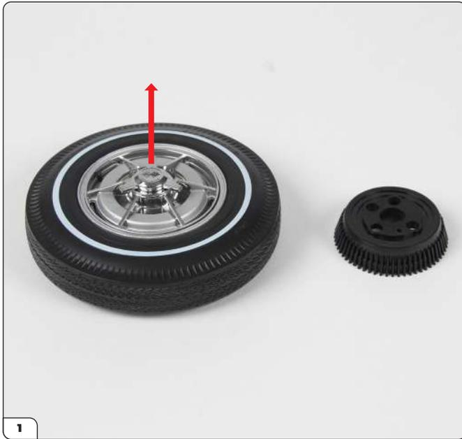
1 Nehmen Sie die linke Bremstrommel sowie das in Bauphase 4 zusammengebaute Rad. Entfernen Sie den Spinner (siehe Pfeil).
