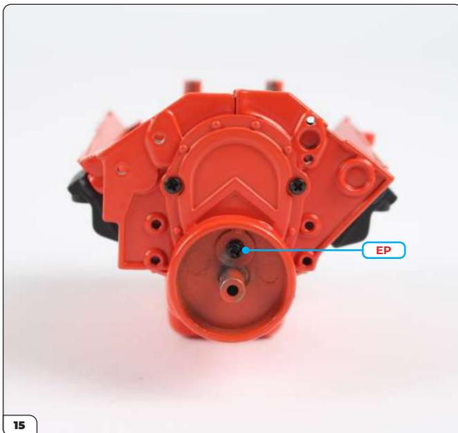
Setzen Sie die Riemenscheibe an die richtige Stelle und befestigen Sie sie dann mit einer EP-Schraube. Schmieren Sie die Schraube bei Bedarf mit Öl.
