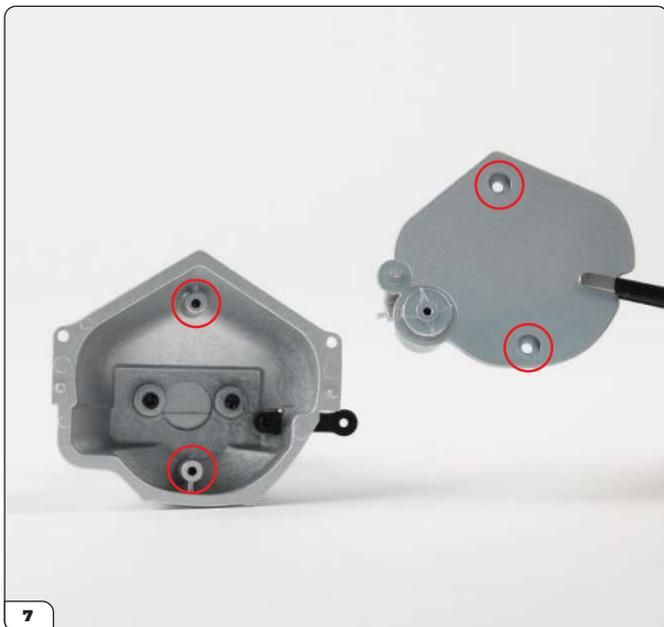
Richten Sie die Schraublöcher der Abdeckung für die Kupplungsglocke wie gezeigt (eingekreist) auf die Baugruppe aus.
