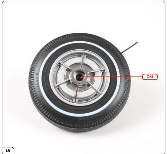
Verschrauben Sie die Koppelstange und das Rad, indem Sie eine CM-Schraube durch die Unterlegscheibe eindrehen. Vergewissern Sie sich, dass die Räder sich ungehindert drehen. Ziehen Sie andernfalls die Schrauben der Radfelgen und der Trommel-Staubabdeckung an.
