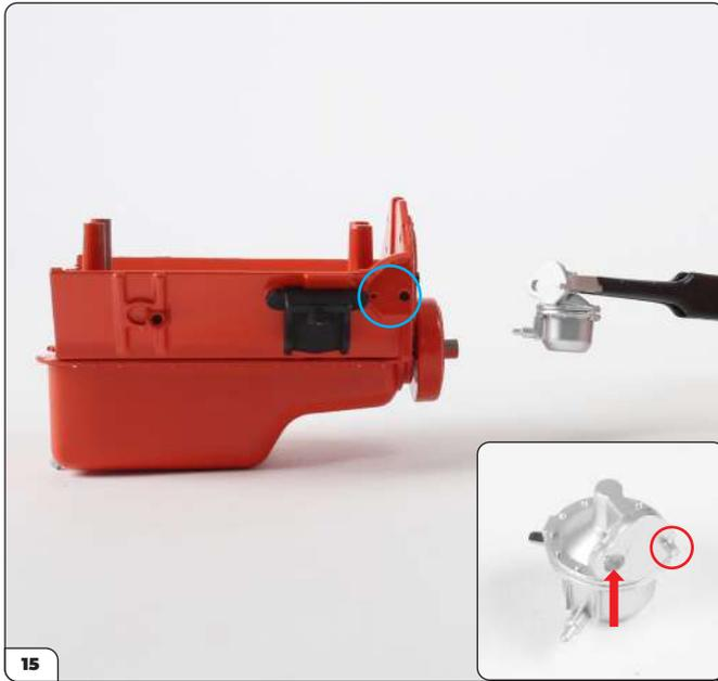
Richten Sie die Halterung für die Kraftstoffpumpe und die Ölwanne (Bauphase 6) aufeinander aus. Beachten Sie den Stift (siehe kleines Bild, eingekreist) und das große Loch (siehe kleines Bild, Pfeil) an der Halterung. Über sie wird die Halterung an der Ölwanne (blauer Kreis) angebracht.
