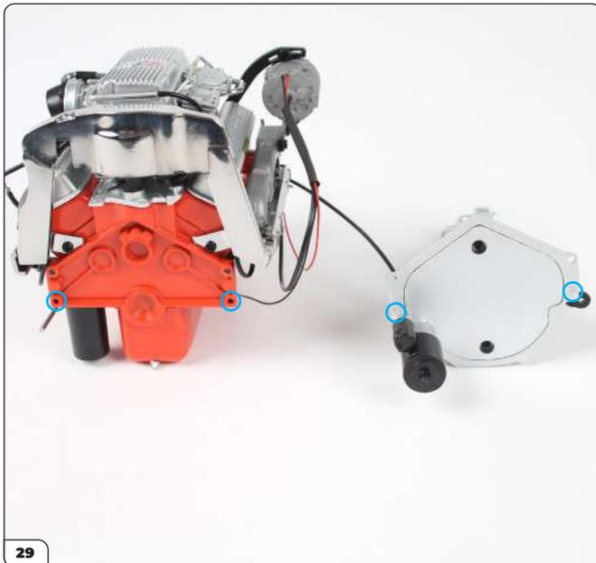
Nehmen Sie die Getriebe-Baugruppe und die Motorblock-Baugruppe und suchen Sie die Befestigungspunkte – zwei Stifte am Getriebe und zwei kleine Löcher im Block (eingekreist).
