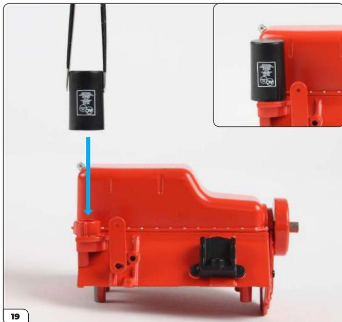
Richten Sie den Ölfilter so auf die Ölwanne (siehe Pfeil) aus, dass der Text nach außen zeigt. Bringen Sie den Ölfilter dann an (siehe kleines Bild).
