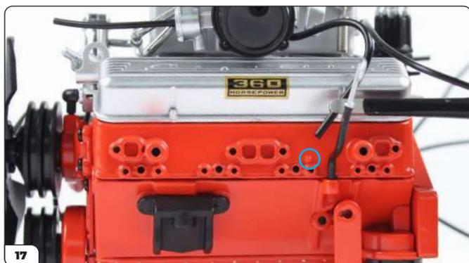
Nehmen Sie das Ende des Schlauches, der von der Kraftstoffeinspritzanlage hervorsticht, und stecken Sie es auf den kleinen Stift (eingekreist).
