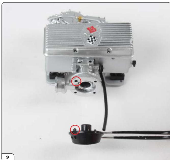
Richten Sie den Diffuserkegel auf das Gehäuse aus. Ein Loch und ein Stift sind größer (eingekreist) – richten Sie den Kegel anhand dieses Loches und dieses Stiftes richtig herum aus.
