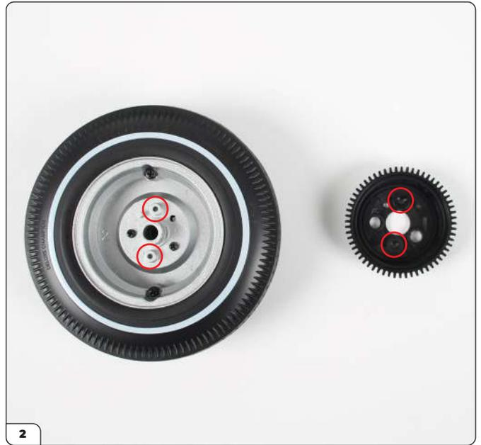
2 Richten Sie die Teile wie gezeigt aus. Die Schraublöcher der Trommel passen über die Schraublöcher der Felge (eingekreist).
