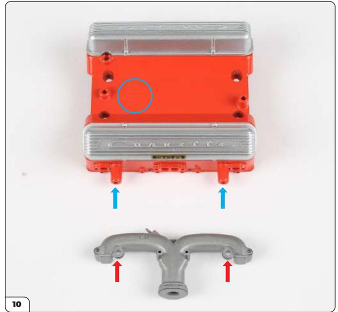
Legen Sie die Baugruppe so vor sich hin, dass der Pfeil nach links zeigt (eingekreist). Richten Sie die Löcher des linken Auspuffkrümmers (rote Pfeile) auf die erhöhten Schraublöcher an der Abdeckung (blaue Pfeile) aus.
