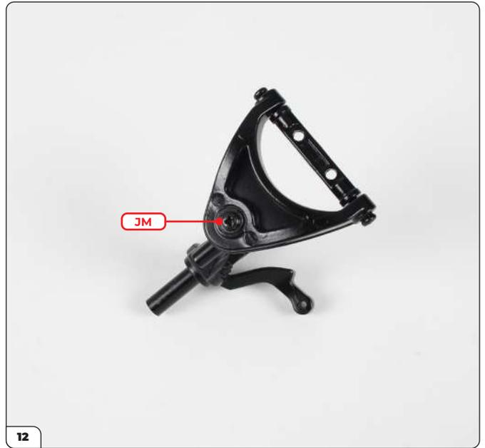
Stecken Sie den Querlenker auf den Schraubzapfen und befestigen Sie ihn mit einer JM-Schraube.
