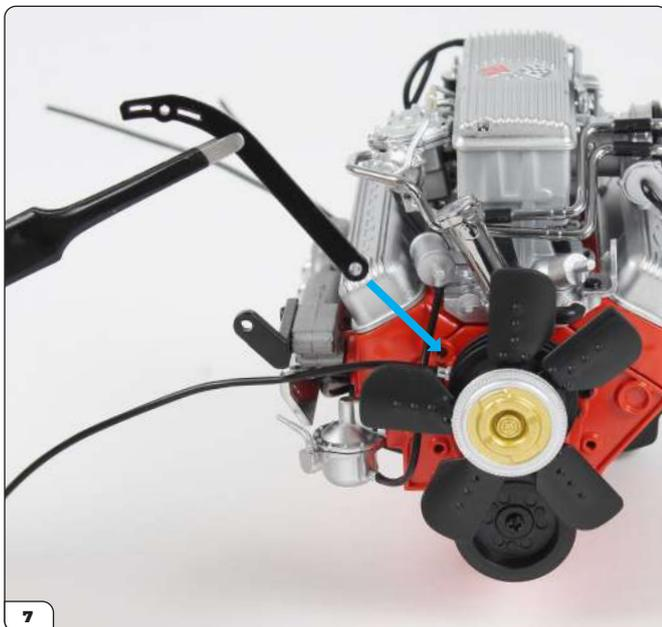
Nehmen Sie die Motorblock-Baugruppe und legen Sie sie so vor sich hin, dass die Frontpartie zu Ihnen zeigt. Richten Sie die Halterung für die Lichtmaschine auf das Loch hinter dem Kühlerlüfter (siehe Pfeil) aus.
