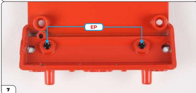
Legen Sie den Zylinderkopf richtig an und befestigen Sie ihn dann mit 2 EP-Schrauben.
