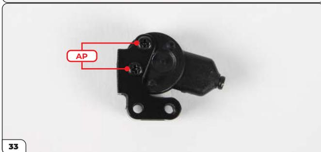
Legen Sie die Kappe für die Lenkungspumpe so hin, dass die beiden Stifte nach oben zeigen (eingekreist). Richten Sie dann die Halterung für die Lenkungspumpe auf die Kappe aus (siehe Pfeile). Legen Sie die Halterung an und befestigen Sie sie dann mit 2 AP-Schrauben.
