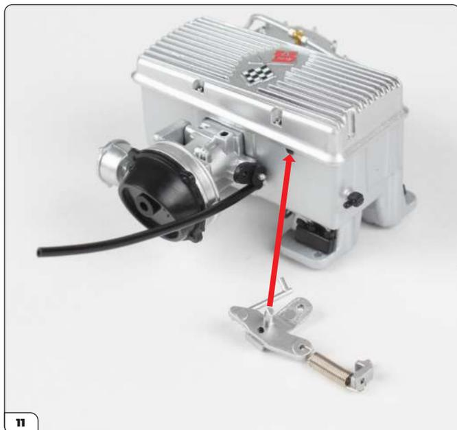
Richten Sie das Drosselklappengestänge auf die Baugruppe aus. Stecken Sie zuerst den gebogenen Stift in das Loch an der Seite der Baugruppe (roter Pfeil).
