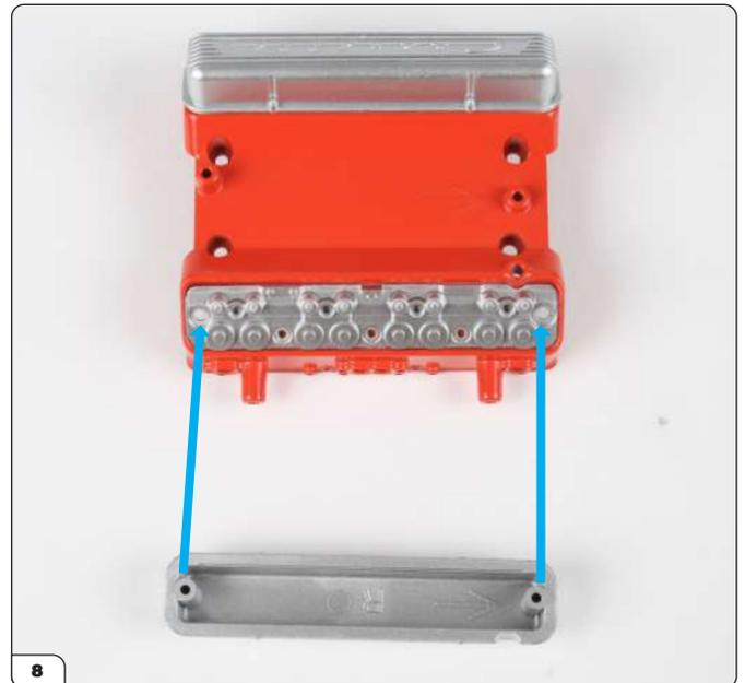
Richten Sie die rechte Ventilabdeckung auf den Zylinderkopf (siehe Pfeile) aus.
