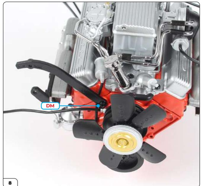
Legen Sie die Halterung über das Loch und befestigen Sie sie dann mit einer DM-Schraube. Ziehen Sie die Schraube nicht bis zum Anschlag fest, da die Halterung beweglich bleiben muss.
