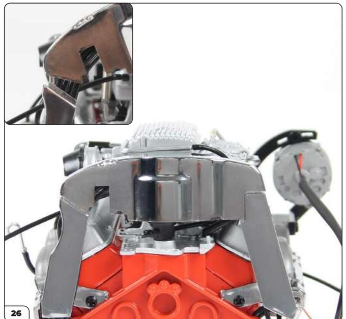
Bringen Sie die obere Abschirmung über den Kabeln an. Führen Sie dazu zuerst die Kabel ordentlich in die linke Seite (siehe kleines Bild), senken Sie dann die rechte Seite und drücken Sie dann die Abschirmung fest auf.
