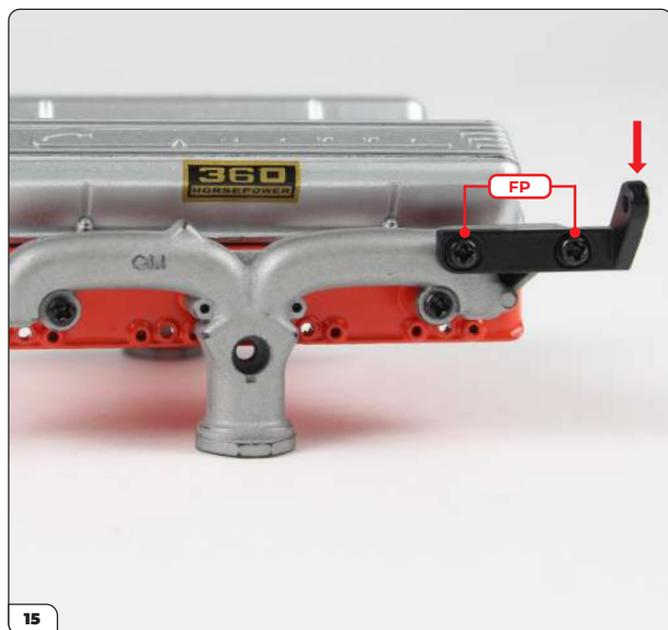
Installez le support et fixez-le avec 2 vis FP. Notez que la languette du support est orientée vers le haut (cf. flèche).
