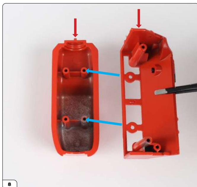
Alignez les deux trous du bloc moteur droit avec ceux du carter d'huile (cf. flèches bleues). Notez l'orientation des pièces (cf. flèches rouges).
