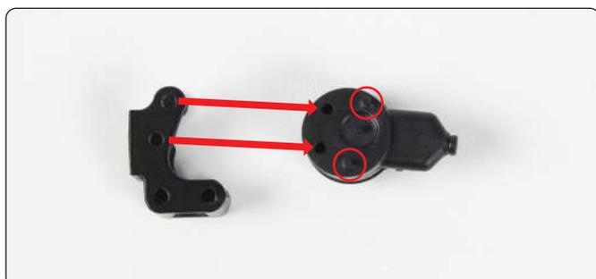
Placez le bouchon de la pompe de direction de sorte que les deux broches soient orientées vers le haut (entourées sur la photo), puis alignez le support de la pompe de direction avec celui-ci (cf. flèches). Mettez le support en place avec 2 vis AP.
