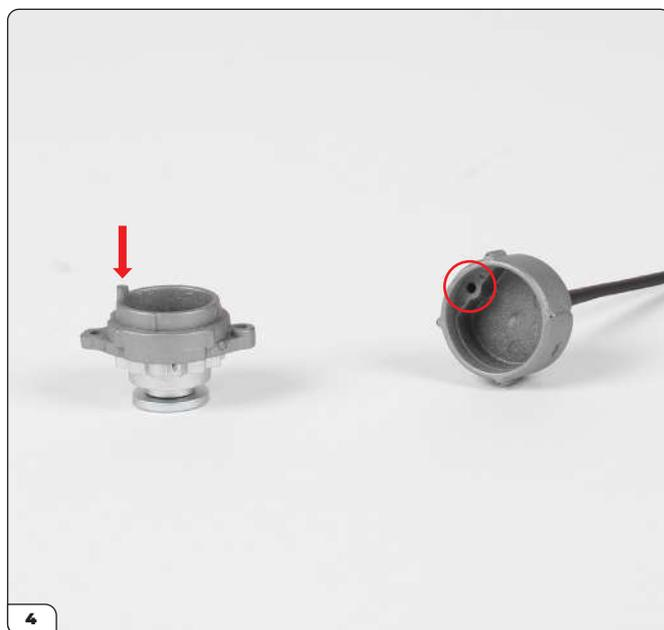
Prenez l'alternateur arrière, puis repérez le trou à l'intérieur (entouré sur la photo) et la broche sur l'assemblage (cf. flèche).
