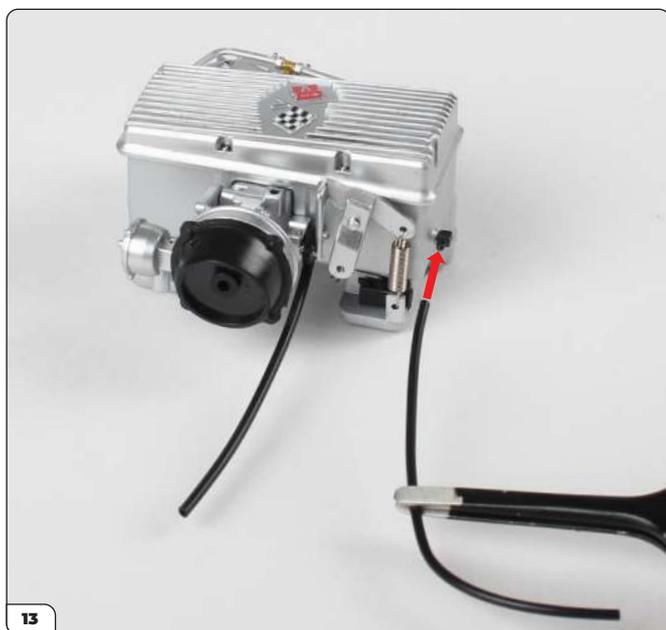
Alignez le tuyau long avec la broche noire de l'assemblage (cf. flèche).
