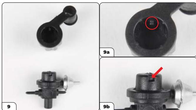
Repérez la protubérance à l'intérieur de la bobine (entourée sur la photo, 9a). Celle-ci s'insère dans le logement situé sur le dessus du distributeur (cf. flèche, 9b).
