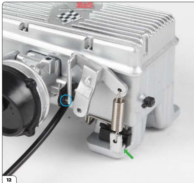
Poussez ensuite la broche à l'extrémité de la tringlerie dans le trou du support (entouré en bleu), puis insérez la broche de retour d'accélérateur dans le trou à la base de l'assemblage (cf. flèche verte).
