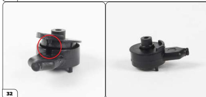
Prenez le bouchon de la pompe de direction ainsi que son cache (32a). Repérez l'encoche du bouchon qui s'insère dans la protubérance du cache (entourée sur la photo). Pressez fermement les deux parties l'une contre l'autre.
