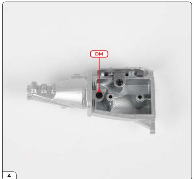
Insérez sa languette dans le pas de la vis et fixez avec une vis DM.
