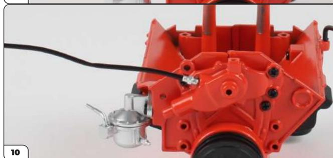
Localisez le trou de la pompe à eau (entouré sur la photo, 10a) et mettez le connecteur de tuyau en place.
