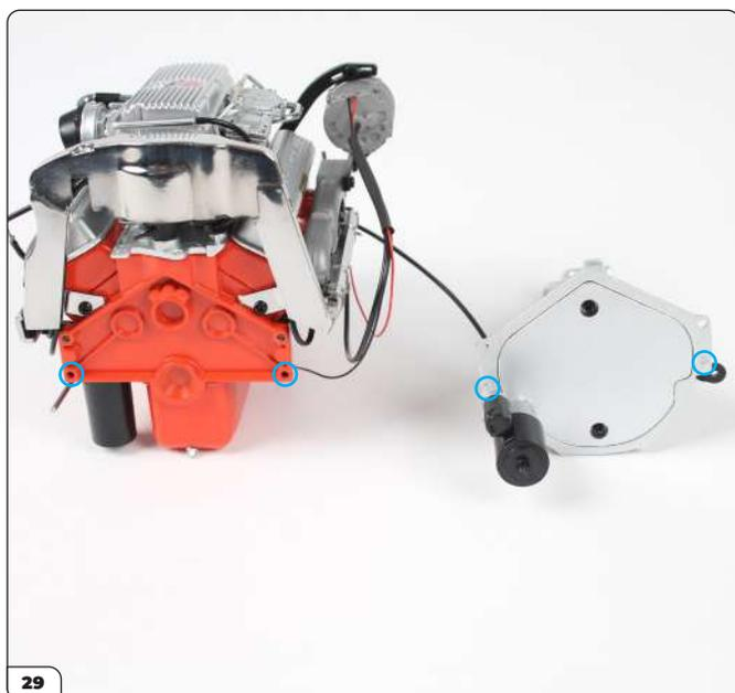
Prenez la boîte de vitesse et le bloc moteur, puis repérez les points de fixation - deux broches sur la boîte de vitesse et deux petits trous dans le bloc (entourés sur la photo).
