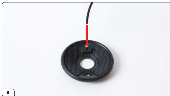
Montez l'autre prise d'air (« L1 ») sur le cache, puis alignez le flexible de frein avec la petite broche noire (cf. flèche).
