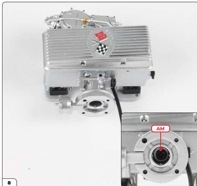
Poussez pour mettre en place et fixez avec une vis AM (cf. encadré).
