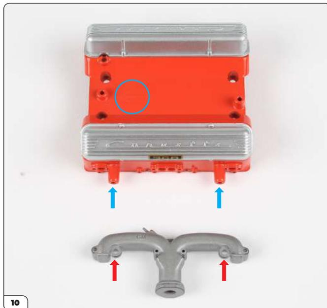
Placez l'assemblage de sorte que la flèche pointe vers la gauche (entourée sur la photo). Alignez les trous du collecteur d'échappement gauche (cf. flèches rouges) avec les pas de vis en saillie du cache (cf. flèches bleues).
