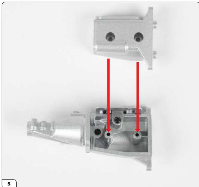
Alignez la boîte de vitesse inférieure avec l'assemblage tel qu'indiqué (cf. flèches).
