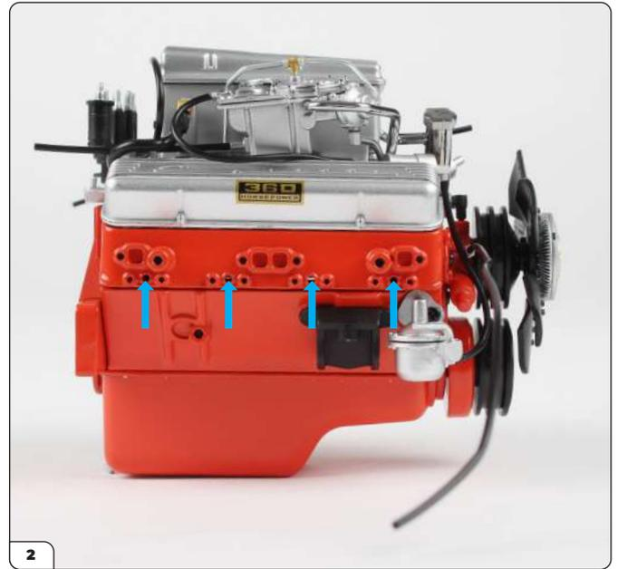
Retirez le collecteur d'échappement droit et mettez-le de côté. Notez les quatre trous pour l'installation des bougies d'allumage.
