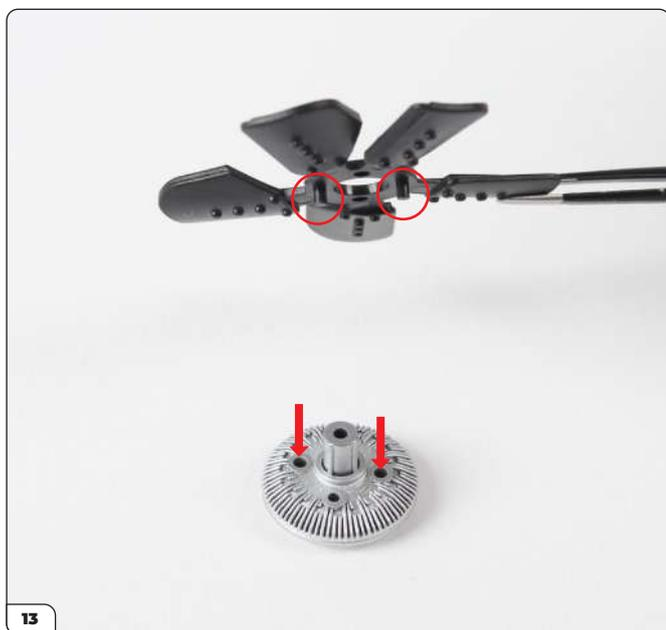
Saisissez le ventilateur et alignez les deux broches (entourées sur la photo) avec les trous de l'embrayage (cf. flèches). Testez l'ajustement des pièces (notez que les trous et les broches sont de tailles différentes).
