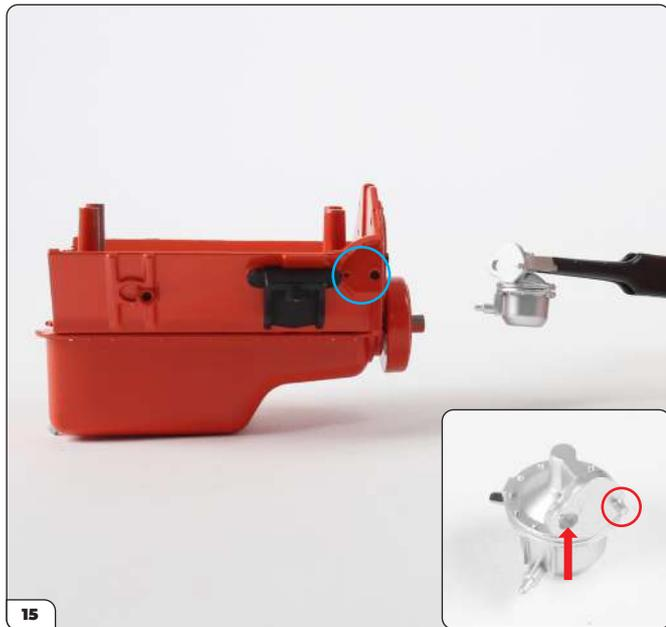
Alignez le support de la pompe à carburant avec le carter d'huile (étape 6). Notez la broche (entourée sur la photo) et le grand trou (cf. encadré, flèche) sur le support pour le fixer sur le carter d'huile (cercle bleu).
