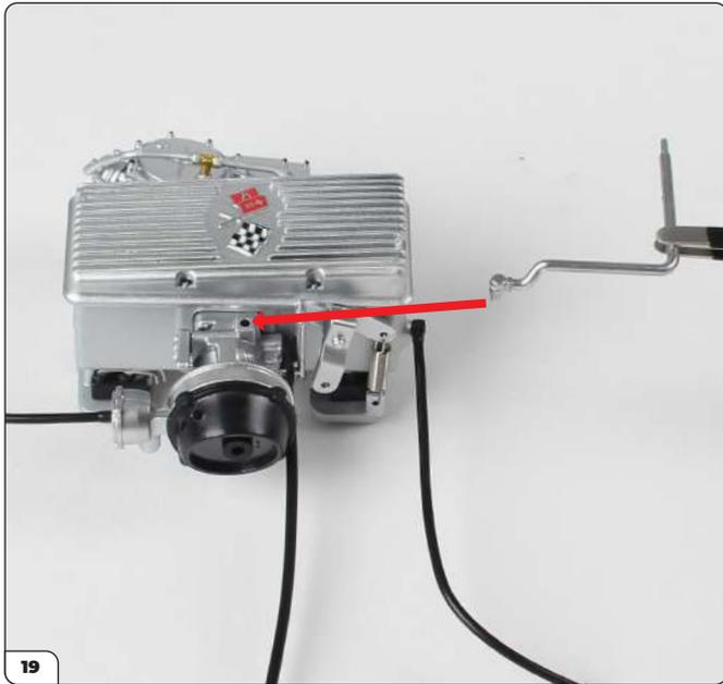
Insérez la broche de l'extrémité courbée du long tuyau de carburant dans le corps du débitmètre d'air, tel qu'indiqué (cf. flèche).
