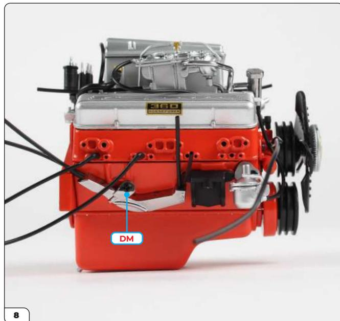
8 Installez le blindage et fixez-le avec une vis DM.
