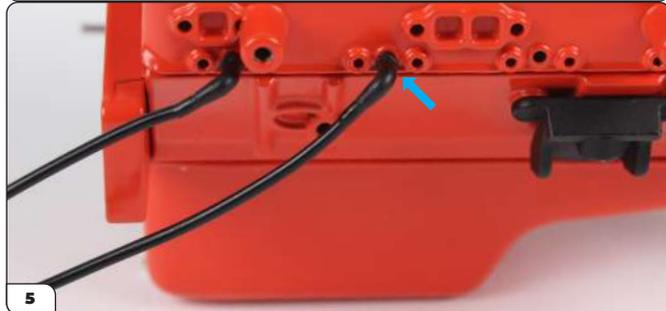
5 Insérez une bougie d'allumage dans le câble de 100 mm, puis enfoncez-la dans le trou suivant (cf. flèche).
