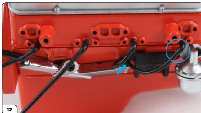
Placez l'extrémité du câble extérieur (cf. flèche) sur la quatrième bougie d'allumage (entourée sur la photo).
