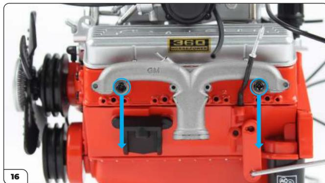
Orientez le côté gauche de l'assemblage vers vous. Dévissez les deux vis DM du collecteur d'échappement gauche (cf. flèches) et retirez-le.
