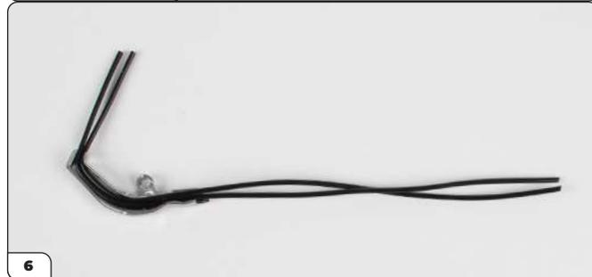
6 Prenez deux des câbles d'allumage les plus longs (165 mm) et le blindage de câble inférieur droit (marqué « R », entouré sur la photo). Enfoncez les deux câbles dans le renforcement du bouclier (image du bas).
