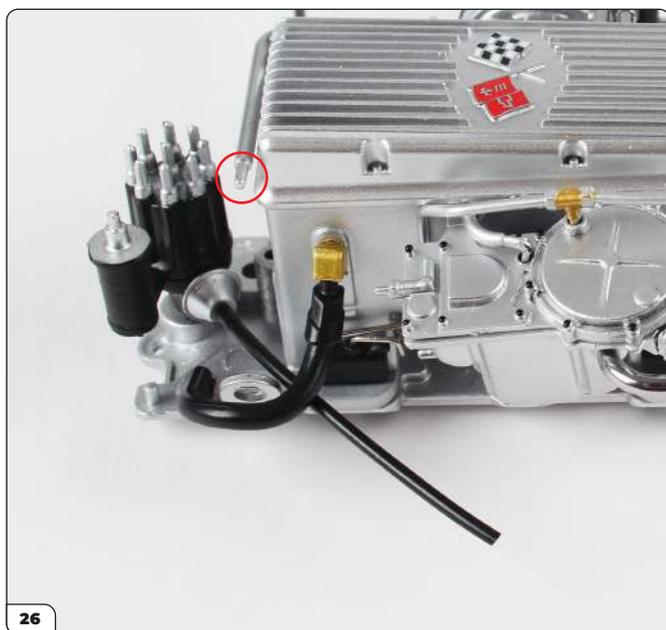
Mettez le tuyau de carburant en place. Notez la broche argentée sur le tuyau de carburant (entourée sur la photo).
