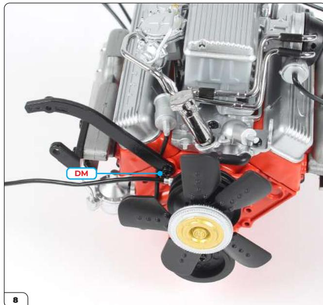
Placez le support sur le trou et fixez-le avec une vis DM - ne serrez pas complètement la vis car le support doit pouvoir bouger.
