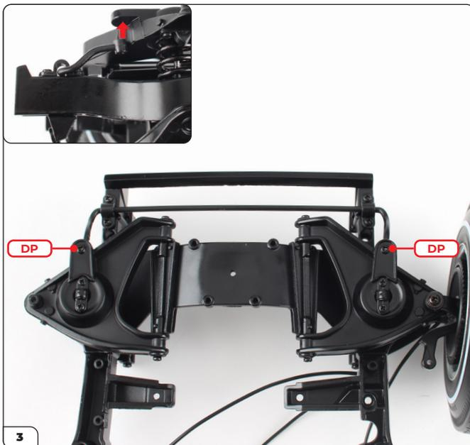
Heben Sie die Enden des Überrollbügels nach oben zu den Löchern in den unteren Querlenkern (siehe kleines Bild, Pfeil). Drücken Sie die unteren Querlenker nach unten und befestigen Sie den Bügel vorsichtig mit 2 DP-Schrauben. Ziehen Sie die Schrauben nicht zu fest an, da hierdurch der Bügel beschädigt werden könnte.
