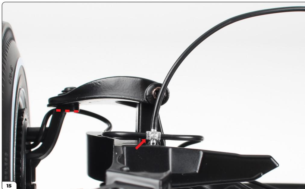
Nehmen Sie das lose Ende des Bremsschlauchs des linken Rades und führen Sie den Schlauch hinter der Koppelstange (gestrichelte Linie) vorbei und dann weiter durch, um ihn wie gezeigt am Bypass (siehe Pfeil) anzubringen.
