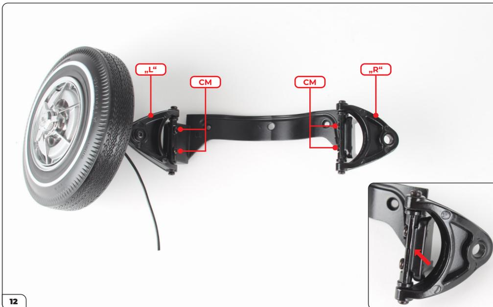
Legen Sie die Verkleidung für das vordere Chassis in der gezeigten Ausrichtung auf Ihre Arbeitsplatte. Bringen Sie dann die Querlenker (mit „L“ und „R“ gekennzeichnet) aus Bauphase 15 an und befestigen Sie sie mit 4 CM-Schrauben an der Verkleidung. Die Wellen der Querlenker liegen etwas tiefer, damit die Verkleidung problemlos passt (siehe kleines Bild, Pfeil).
