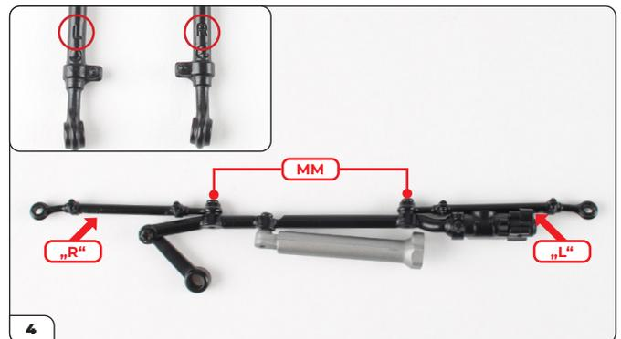
4 Bringen Sie die Lenkgestänge (mit „L“ und „R“ gekennzeichnet, siehe kleines Bild, eingekreist) an der Lenkstange an und befestigen Sie sie mit 2 MM-Schrauben. Es ist wichtig, dass die mit „L“ und „R“ gekennzeichneten Lenkgestänge an den durch die Pfeile angegebenen Stellen angebaut werden.
