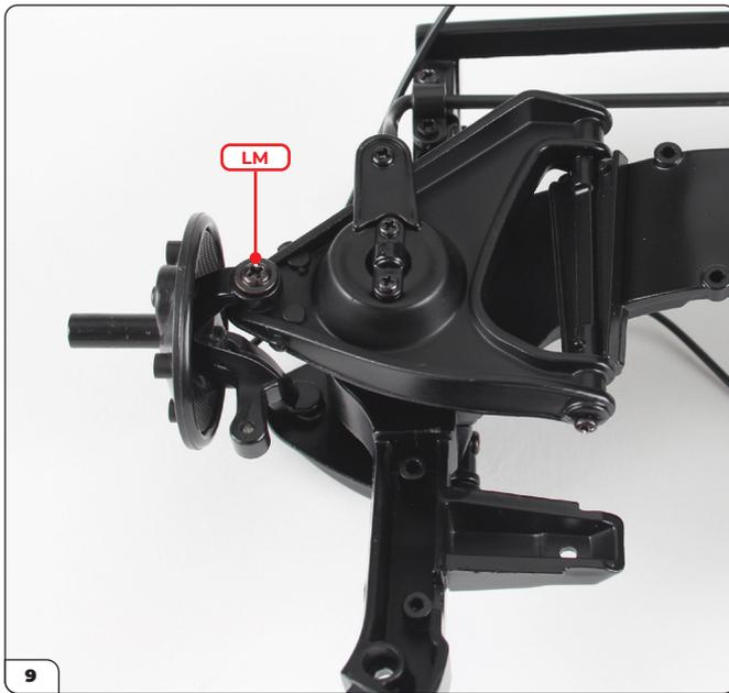
Drehen Sie die Baugruppe um und befestigen Sie den unteren Querlenker mit einer LM-Schraube.
