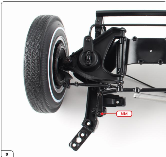
Befestigen Sie das Ende des Lenkzwischenhebels mit einer NM-Schraube an der Halterung.
