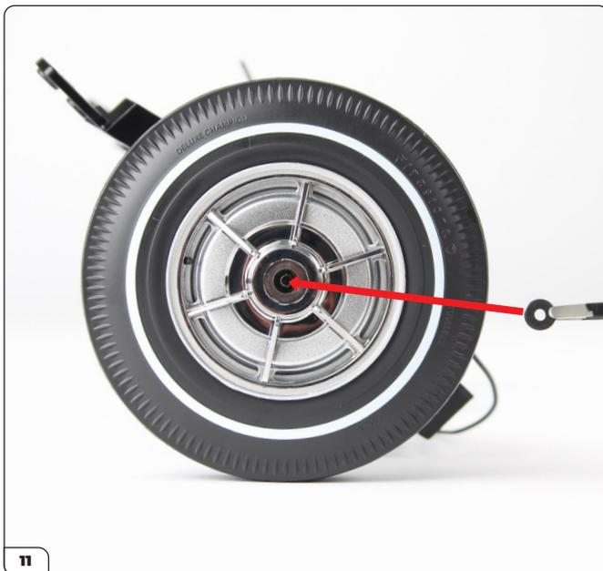
Entfernen Sie den Spinner und stellen Sie dann das Rad wie gezeigt neben die Koppelstange. Vergewissern Sie sich, dass das äußere Rad von der Koppelstange weg zeigt. Legen Sie die Unterlegscheibe in die Radabdeckung (siehe Pfeil).
