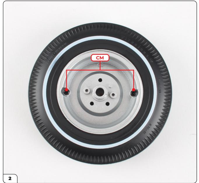
Drehen Sie das Rad um und stecken Sie die innere Felge wie gezeigt von der Innenseite in das Rad. Richten Sie die äußeren Löcher aus und befestigen Sie die Baugruppe dann mit 2 CM-Schrauben.
