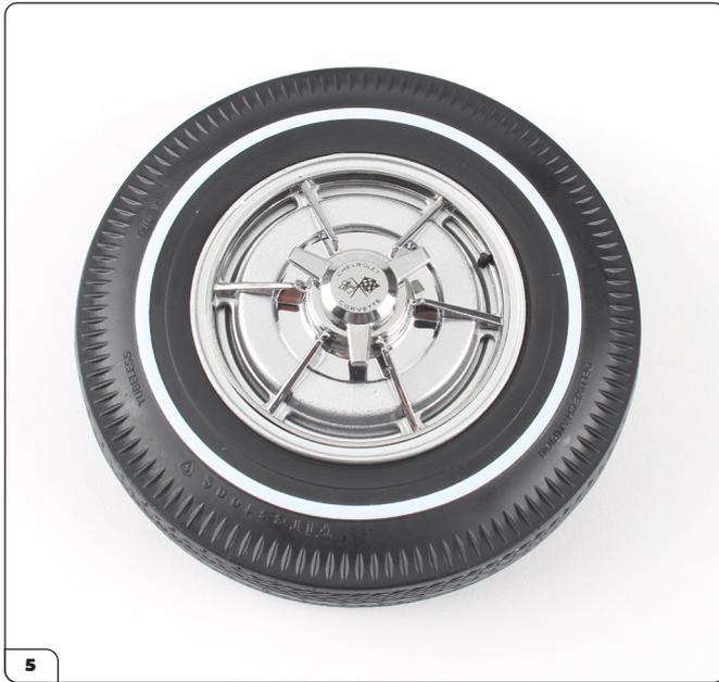
Stecken Sie den Spinner auf die Radabdeckung. Alternativ können Sie warten, bis das Rad in der nächsten Bauphase montiert wird.
