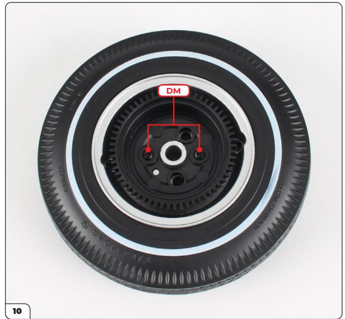
Bringen Sie die Bremstrommel im rechten Vorderrad aus Bauphase 18 an und befestigen Sie sie mit 2 DM-Schrauben.
