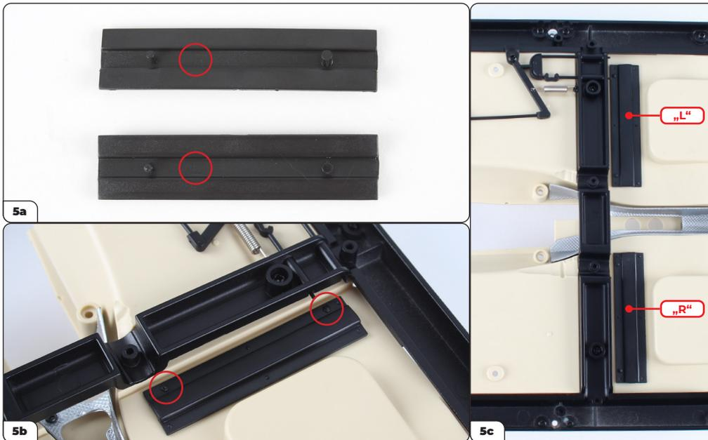
Die Chassis-Verstärkungen sind mit „L“ und „R“ gekennzeichnet, um links und rechts voneinander zu unterscheiden (5a, eingekreist). Achten Sie beim Anbringen der Chassis-Verstärkungen darauf, dass die Bolzen neben der Querstrebe des Rahmens sind (5b, eingekreist). Stecken Sie die linke und die rechte Verstärkung wie gezeigt auf (5c).
