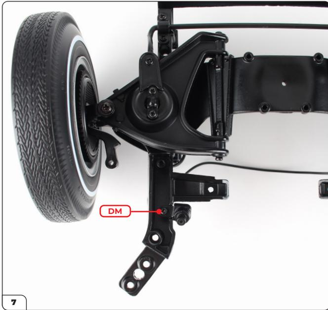
Bringen Sie die Gestänge-Halterung in der Vertiefung am vorderen Chassis an und befestigen Sie sie mit einer DM-Schraube.
