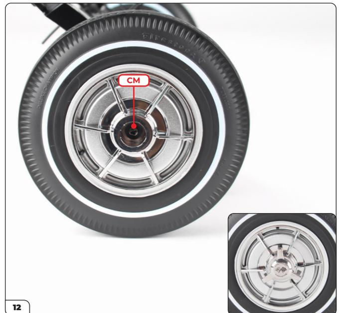
Befestigen Sie das Rad mit einer CM-Schraube. Stecken Sie den Spinner in die Radabdeckung (siehe kleines Bild).
