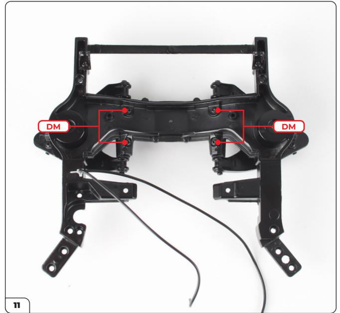
Drehen Sie die Baugruppe um und befestigen Sie die Wellen mit 4 DM-Schrauben am Chassis.
