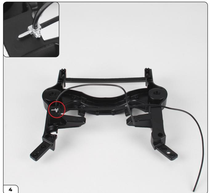
Stecken Sie den Bypass in das Loch im vorderen Chassis (eingekreist).
