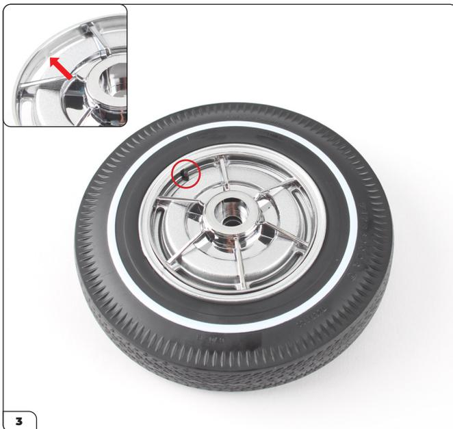
Drehen Sie die Baugruppe wieder um und stecken Sie die Radabdeckung mit 6 Speichen auf. Richten Sie hierbei die Kerbe in der Abdeckung (siehe kleines Bild, Pfeil) auf das Luftventil aus (eingekreist).
