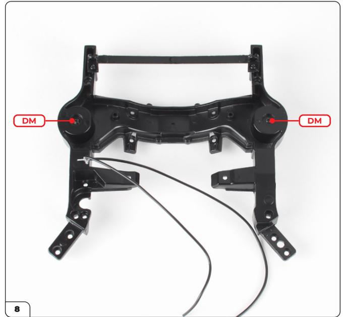
Drehen Sie die Baugruppe um und befestigen Sie die Stangen mit 2 DM-Schrauben.
