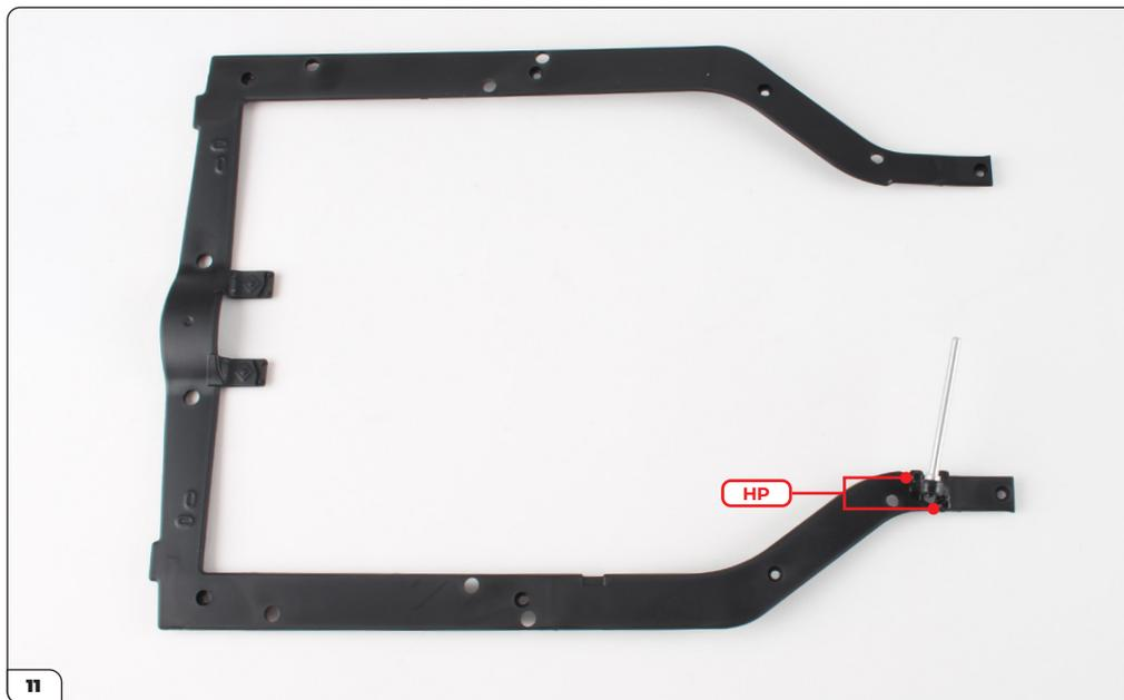
Bringen Sie die Hülsen-Halterung wie gezeigt an der Chassisverkleidung an und befestigen Sie sie mit 2 HP-Schrauben.
