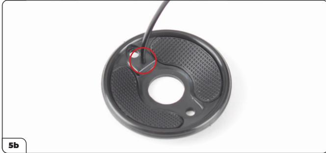
Ziehen Sie den längeren Bremsschlauch vom Bypass ab (5a, siehe Pfeil) und stecken Sie den Schlauch dann auf den Stift auf der Abdeckung für die Bremstrommel (5b, eingekreist).
