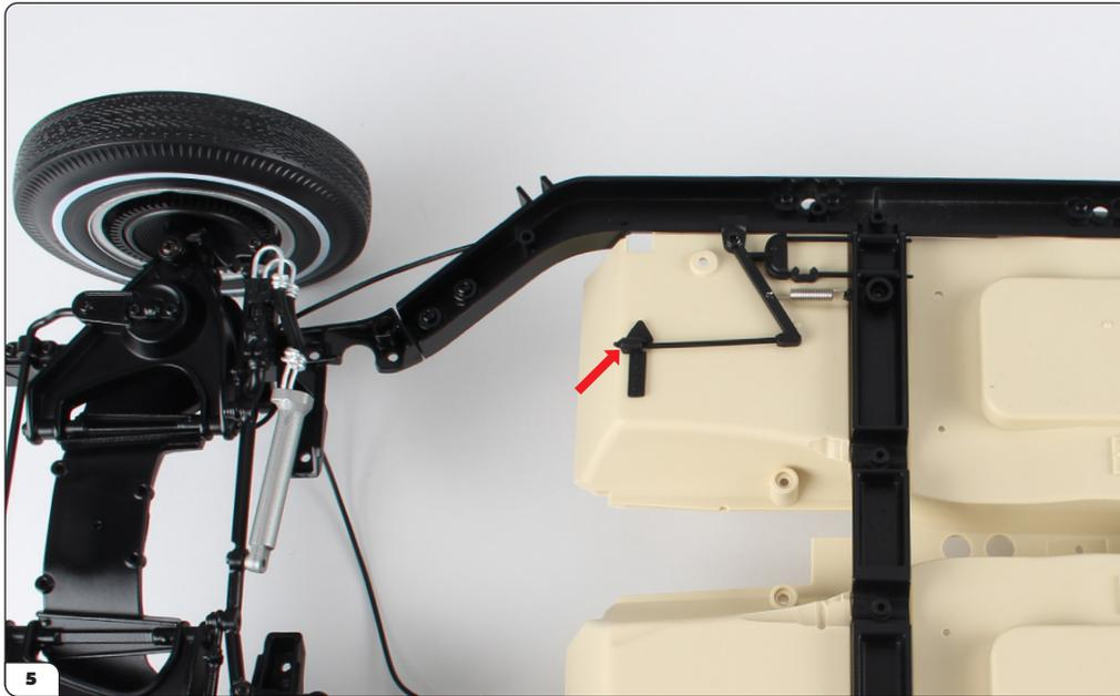
Legen Sie die Durchführung über das Handbremsseil (siehe Pfeil) und stecken Sie dann die Durchführung auf den Cockpit-Boden.
