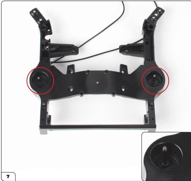
Stecken Sie die Hülstenstangen wie gezeigt in die halbrunden Löcher in den Vertiefungen im vorderen Chassis (eingekreist).
