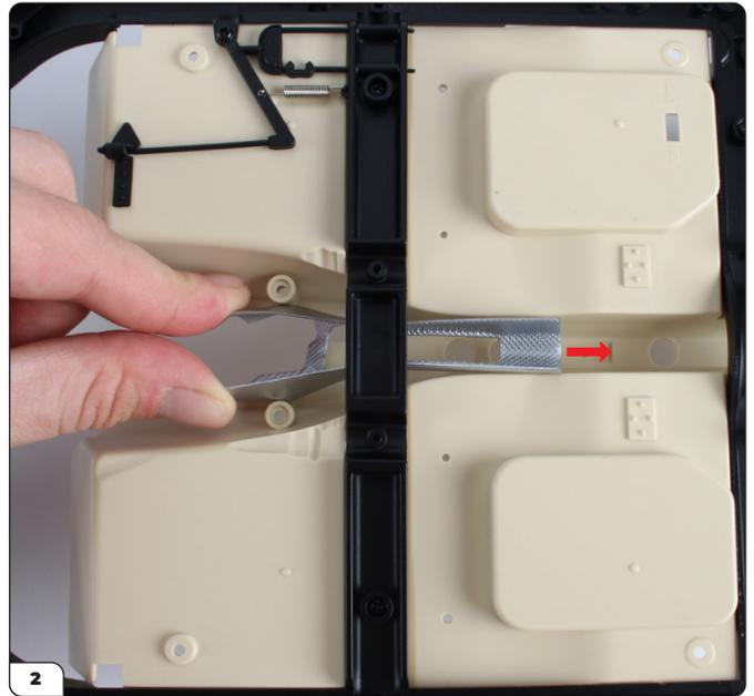
Um das Hitzeschutzblech anzubringen, drücken Sie das breite Ende vorsichtig zusammen und schieben das Hitzeschutzblech wie gezeigt unter der Querstrebe und zwischen den Schraubzapfen durch.
