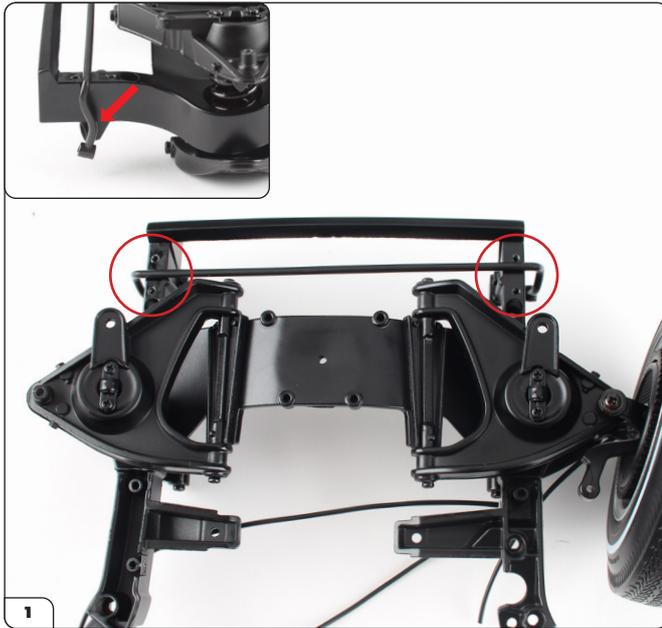
Legen Sie den Überrollbügel zwischen die Löcher am vorderen Chassis (eingekreist). Vergewissern Sie sich, dass die gebogenen Enden des Bügels richtig zur Koppelstange hin ausgerichtet sind (siehe kleines Bild).
