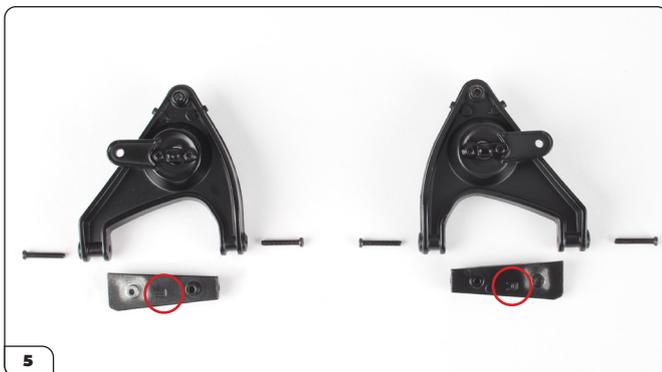
Richten Sie die Wellen (mit „L“ und „R“ gekennzeichnet, eingekreist) wie gezeigt auf die Querlenker aus. Legen Sie dann 4 KM-Schrauben zurecht. Mit diesen Schrauben befestigen Sie gleich die Wellen von der Außenseite der Querlenker.
