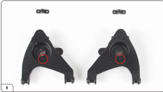
Legen Sie die unteren Querlenker und die Halterungen wie gezeigt hin. Die Querlenker sind mit „L“ und „R“ gekennzeichnet, um links und rechts voneinander zu unterscheiden (eingekreist).
