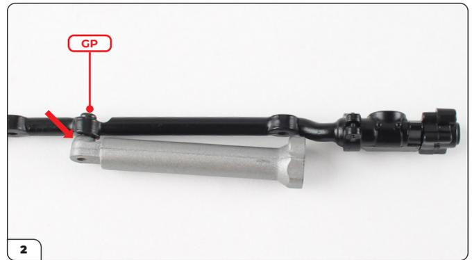
2 Legen Sie die Hülse wie gezeigt neben die mittige Lenkstange. Die abgerundete Seite der Hülse muss die Stange berühren (siehe Pfeil). Befestigen Sie das Ganze dann mit einer GP-Schraube.
