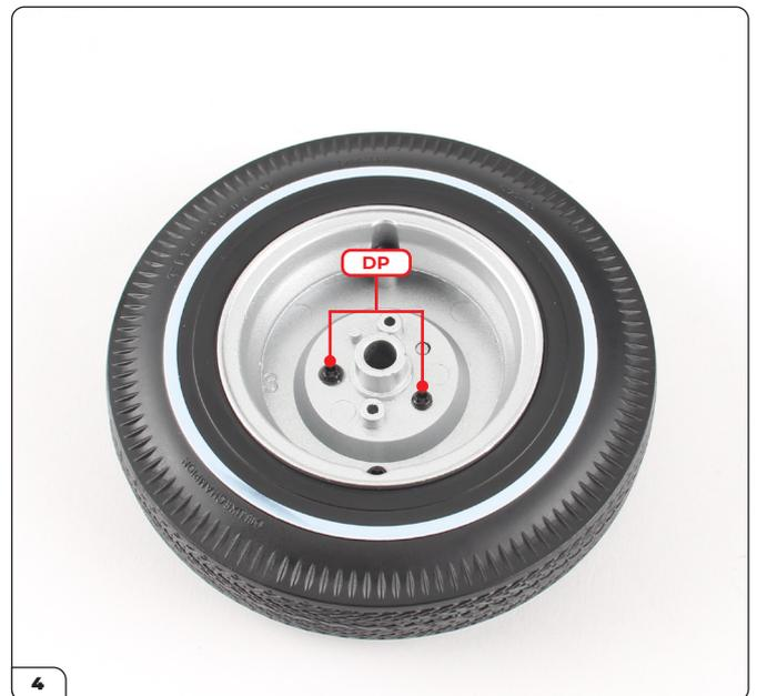
Befestigen Sie die Radabdeckung, indem Sie 2 DP-Schrauben durch die innere Felge hineindrehen.
