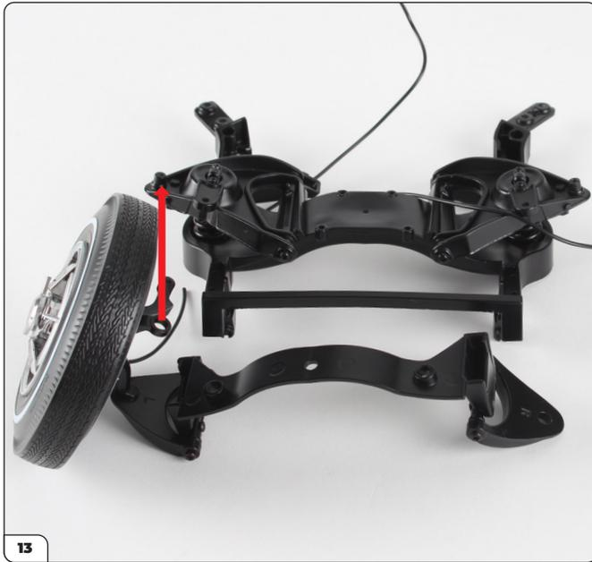
Richten Sie die Baugruppe auf das vordere Chassis aus. An der linken Koppelstange befindet sich eine Öse, die über den erhöhten Schraubzapfen des linken unteren Querlenkers passt (siehe Pfeil).
