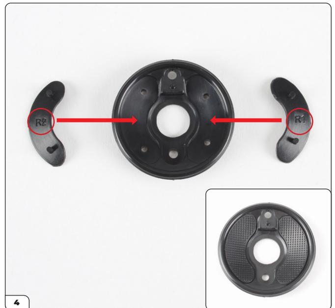
Richten Sie die Abdeckung für die Bremstrommel wie gezeigt aus und stecken Sie dann die Lufthutzen (mit „R1“ und „R2“ gekennzeichnet, eingekreist) an ihren Platz (siehe Pfeile).
