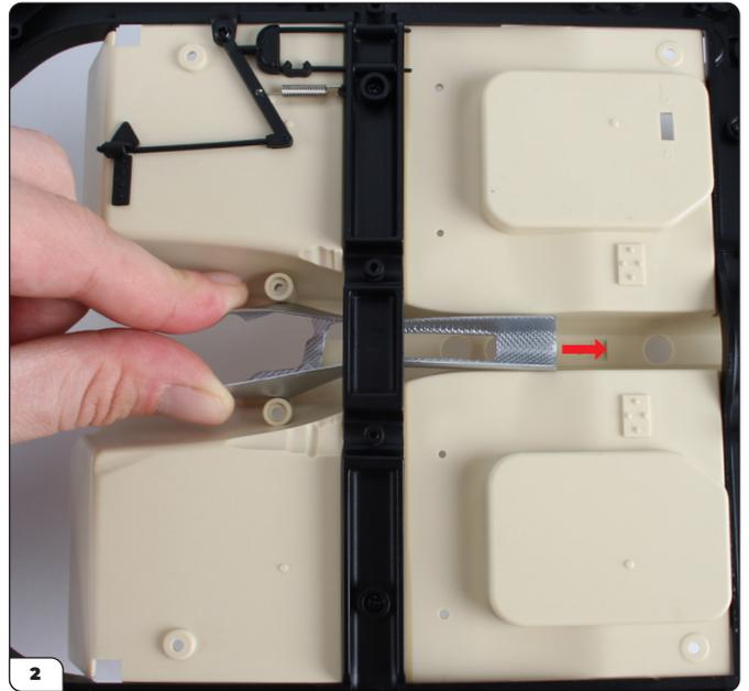
Pour installer le bouclier d'isolation thermique, serrez délicatement l'extrémité la plus large et faites-la passer sous la traverse, en passant entre les colonnes de vis, tel qu'indiqué.
