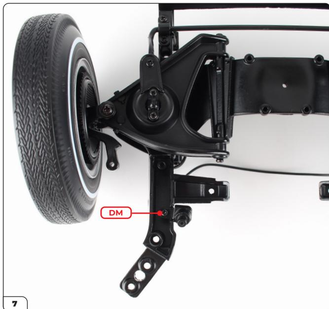
Placez le support de tringlerie dans le renforcement du châssis avant et fixez-le avec une vis DM.
