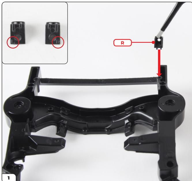
Les deux supports sont marqués d'un « L » et d'un « R » pour distinguer la gauche de la droite (cf. encadré, entouré). Installez le support droit sur le châssis avant (cf. flèche).
