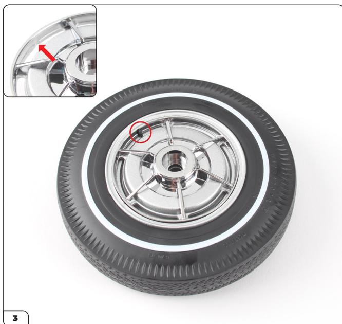
Retournez l'ensemble et appuyez sur l'enjoliveur à six rayons pour le mettre en place, en alignant l'encoche de l'enjoliveur (encadré, cf. flèche) sur la valve de pneu (entourée).
