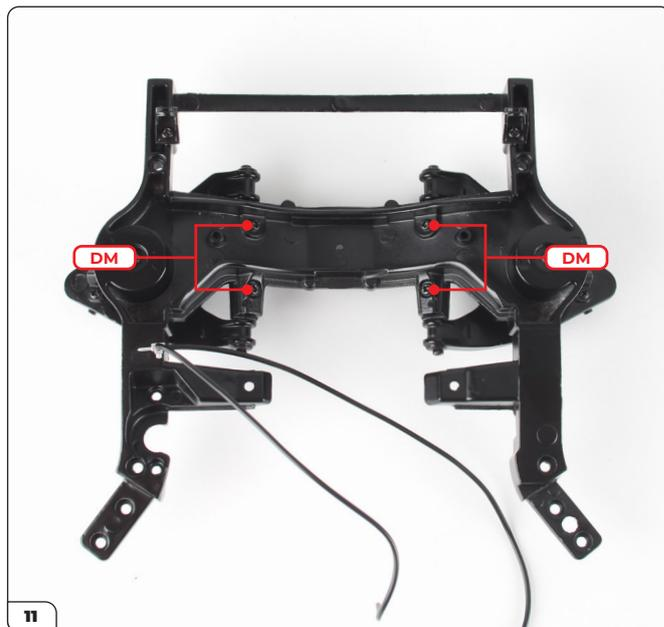
11 Retournez l'ensemble et fixez les arbres sur le châssis avec 4 vis DM.
