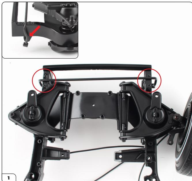
Placez la barre antiroulis entre les trous situés sur le châssis avant (entourés). Assurez-vous que les extrémités courbées de la barre sont bien orientées vers la suspension (cf. encadré).
