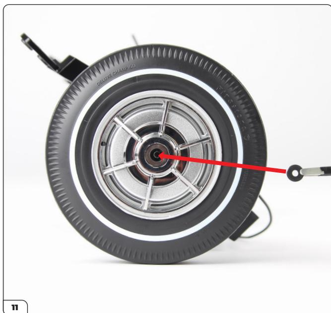
Retirez le tourniquet, puis positionnez la roue sur le montant tel qu'indiqué. Vérifiez que la roue extérieure est orientée à l'opposé du montant. Placez la rondelle à l'intérieur de l'enjoliveur (cf. flèche).
