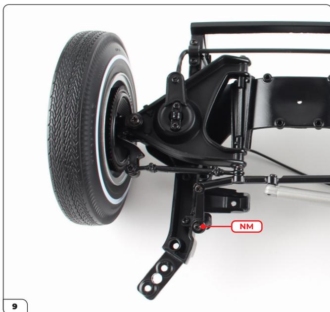
Fixez l'extrémité du bras de renvoi sur le support avec une vis NM.
