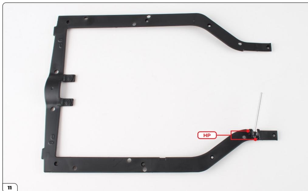
Montez le support du cylindre sur le couvercle du châssis tel qu'indiqué et fixez-le avec 2 vis HP.
