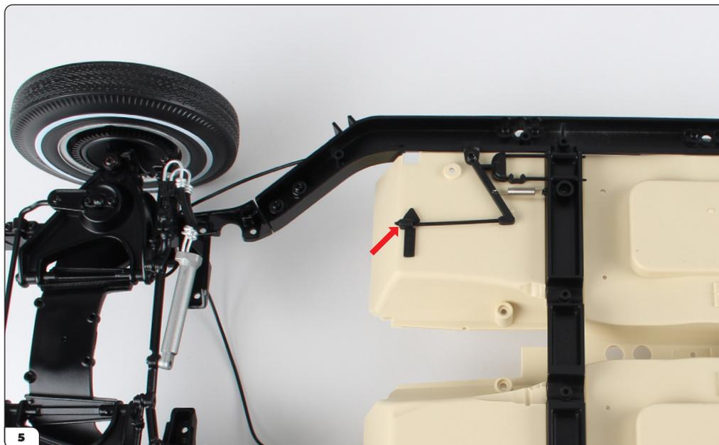
Placez la douille sur le câble de frein à main (cf. flèche) et enfoncez-la dans le plancher du cockpit.
