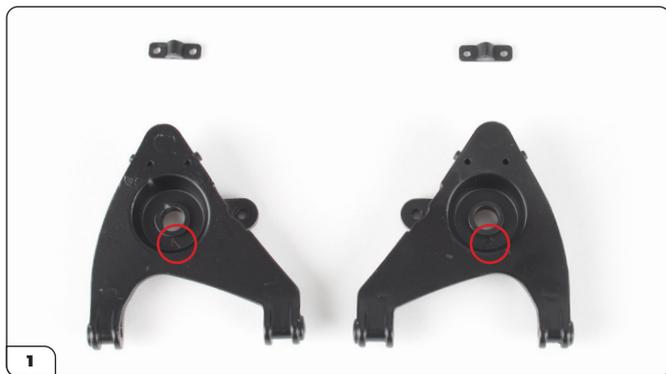
Disposez les bras de suspension inférieurs et les supports. Les bras de suspension sont marqués d'un « L » et d'un « R » pour distinguer la gauche de la droite (entourés).
