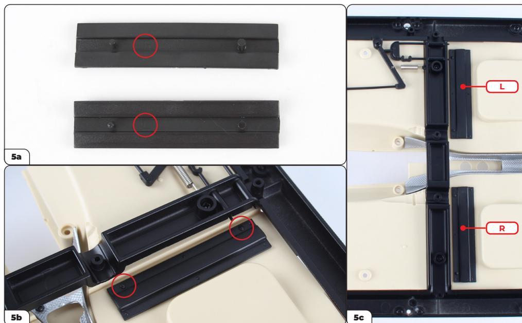
Les renforts de châssis sont marqués « L » et « R » pour distinguer la gauche de la droite (5a, entourés). Lorsque vous montez les renforts de châssis, assurez-vous que les boulons se trouvent bien à côté de la traverse du châssis (5b, entourés). Appuyez sur les renforts gauche et droit pour les mettre en place tel qu'indiqué (5c).
