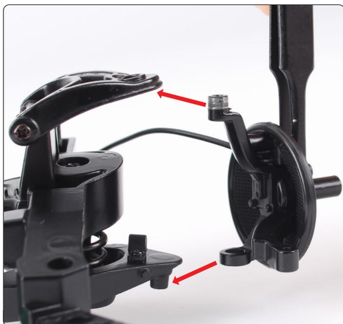
Alignez le montant avec le châssis tel qu'indiqué. Placez les montants filetés dans leurs points de fixation (cf. flèches).
