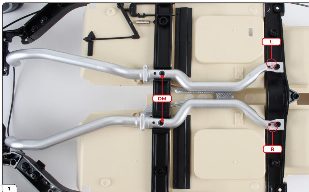
Les tuyaux d'échappement sont marqués « L » et « R » tel qu'indiqué. Montez-les sur le cadre du châssis tel qu'indiqué, puis fixez-les avec 2 vis DM.
