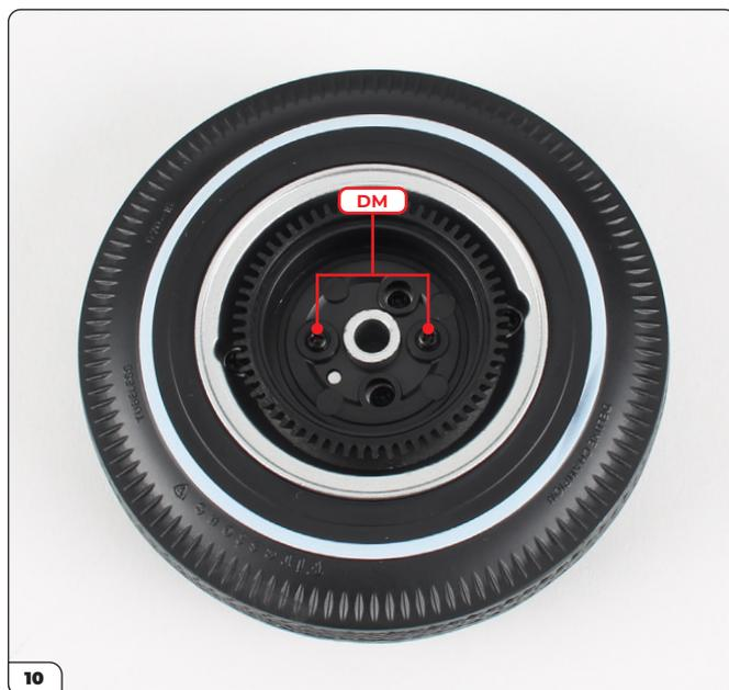
Insérez le tambour de frein dans la roue avant droite issue de l'étape 18 et fixez-le avec 2 vis DM.
