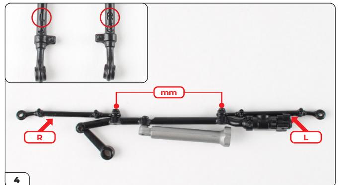
Installez les tringleries de direction (marquées « L » et « R », entourées) et fixez-les sur la barre de direction avec 2 vis MM. Notez que les marques « L » et « R » doivent se trouver dans les positions indiquées par les flèches.
