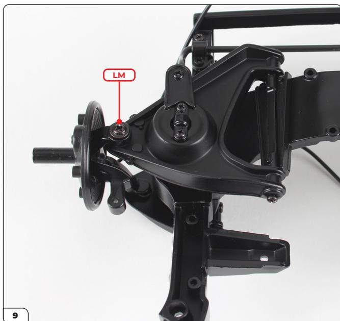
Retournez l'ensemble et fixez le bras de suspension inférieur avec une vis LM.
