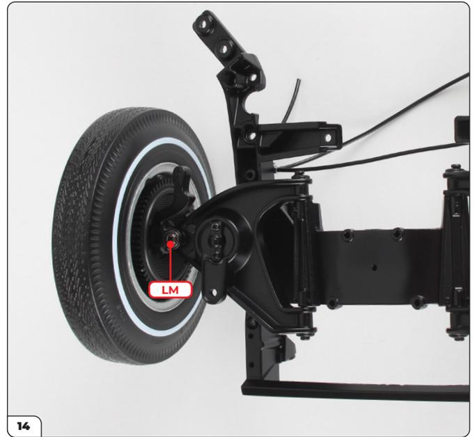
Placez l'ouverture sur le montant et fixez avec une vis LM.
