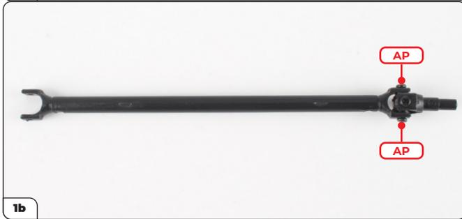
Introduisez le joint de cardan dans le connecteur de l'arbre de transmission et fixez-le avec 2 vis AP (1a), puis poussez le cardan dans l'extrémité de l'arbre de transmission et fixez-le avec 2 vis AP (1b).
