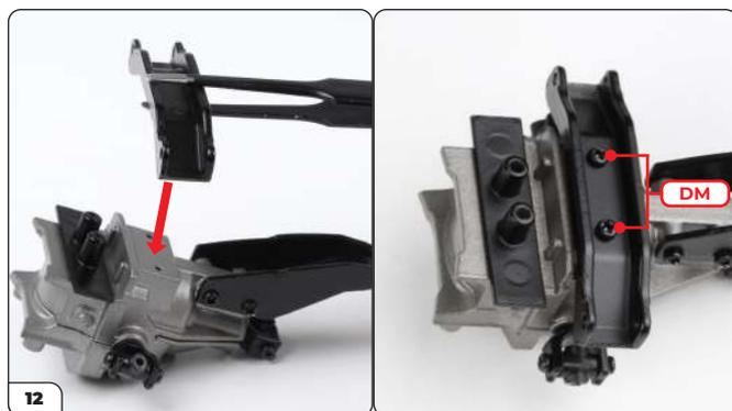
Legen Sie die Halterung über die zwei Löcher im unteren Gehäuse und befestigen Sie sie mit 2 DM-Schrauben.
