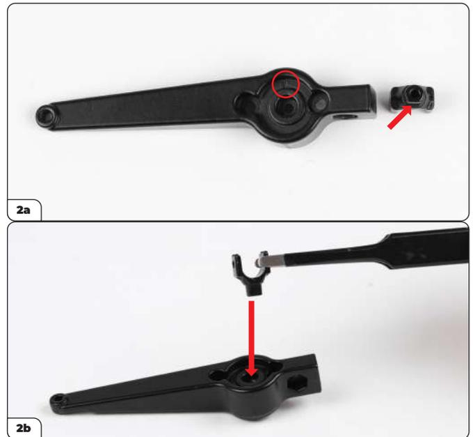
Nehmen Sie den linken oberen Querlenker (2a, mit einem „L“ gekennzeichnet, eingekreist) und einen Verbinders für die Antriebswelle. Beachten Sie, dass er einen halbrunden Zapfen hat (2a, siehe Pfeil). Stecken Sie den Verbinders in den Querlenker (2b).
