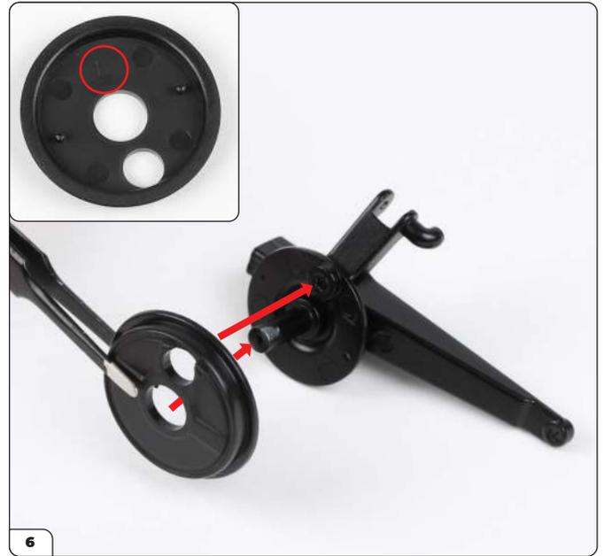
Stecken Sie die linke Abdeckung für die Bremstrommel, die mit einem „L“ gekennzeichnet ist (eingekreist, siehe kleines Bild), wie gezeigt auf den Achsschenkel.
