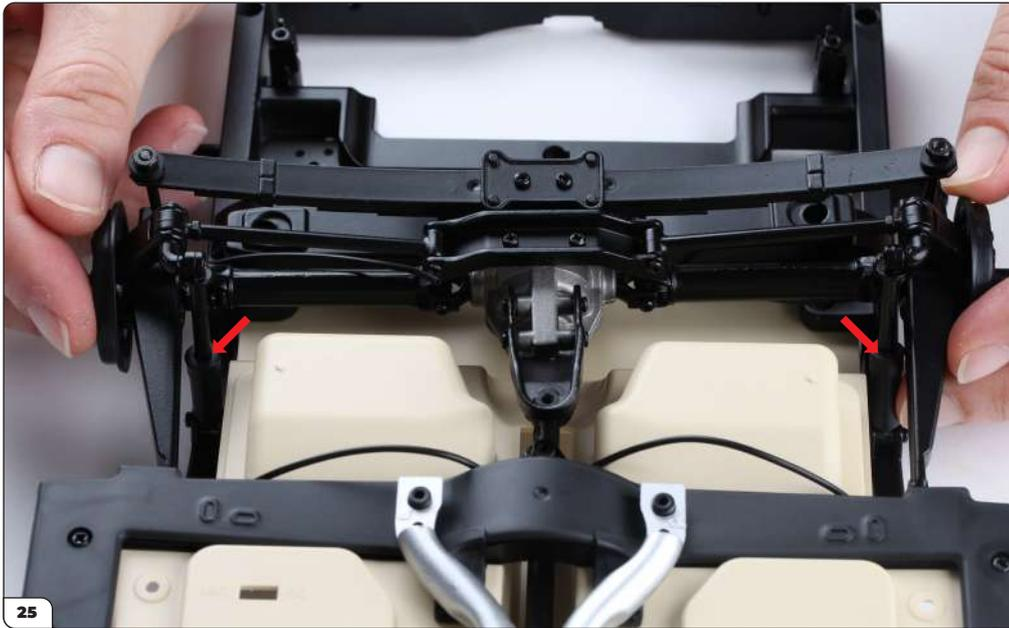
Stecken Sie beide Dämpferstangen in die Hülsen (siehe Pfeile) und stecken Sie dann die Enden der oberen Querlenker in die in Schritt 23 erwähnten Öffnungen.
