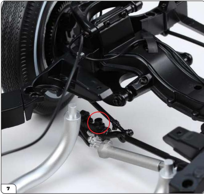
Das runde Loch des Verbindungsstücks passt auf den Zapfen der mittigen Lenkstange (eingekreist).
