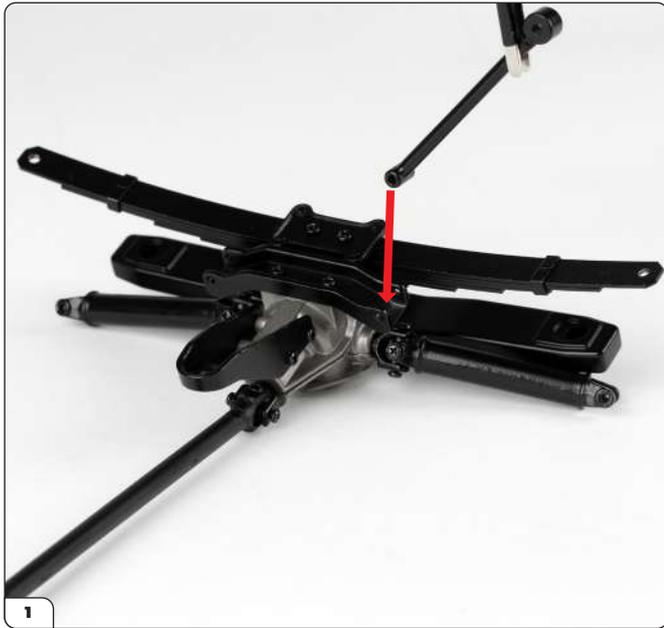
Stecken Sie das kleinere Ende einer unteren Schwingstange in die Halterung des hinteren Differentials (siehe Pfeil).
