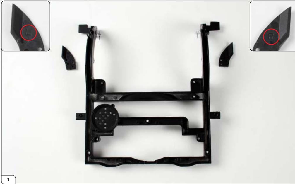
Richten Sie das linke und das rechte seitliche Schutzblech (mit „L“ und „R“ gekennzeichnet, eingekreist) wie gezeigt auf das Heckchassis aus.
