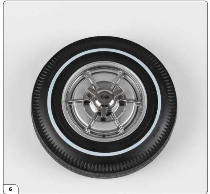
Stecken Sie den Spinner auf die Radabdeckung (siehe Pfeil). Alternativ können Sie warten, bis das Rad in Bauphase 32 montiert wird.
