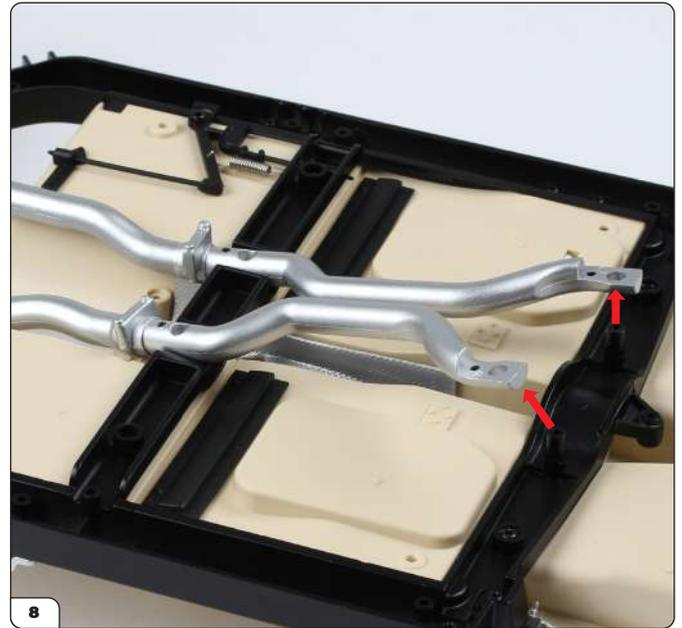
Heben Sie die Enden der Auspuffrohre vorsichtig von den Schraubzapfen des Chassisrahmens hoch (siehe Pfeile).
