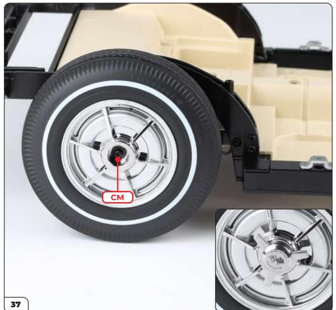
Bringen Sie das rechte Hinterrad auf die gleiche Weise an, legen Sie eine dünne Unterlegscheibe auf und befestigen Sie das Rad dann mit einer CM-Schraube. Stecken Sie den Spinner auf (siehe kleines Bild).
