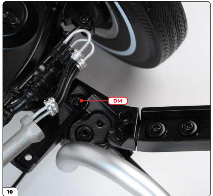
Drehen Sie die Baugruppe vorsichtig um und befestigen Sie das Getriebe mit einer DM-Schraube.
