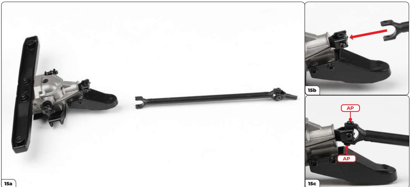
Richten Sie die Antriebswelle (Bauphase 23) auf das hintere Differentialgehäuse aus (15a). Stecken Sie den Verbinder auf das mittige Gelenk (15b, siehe Pfeil) und befestigen Sie ihn mit 2 AP-Schrauben (15c).
