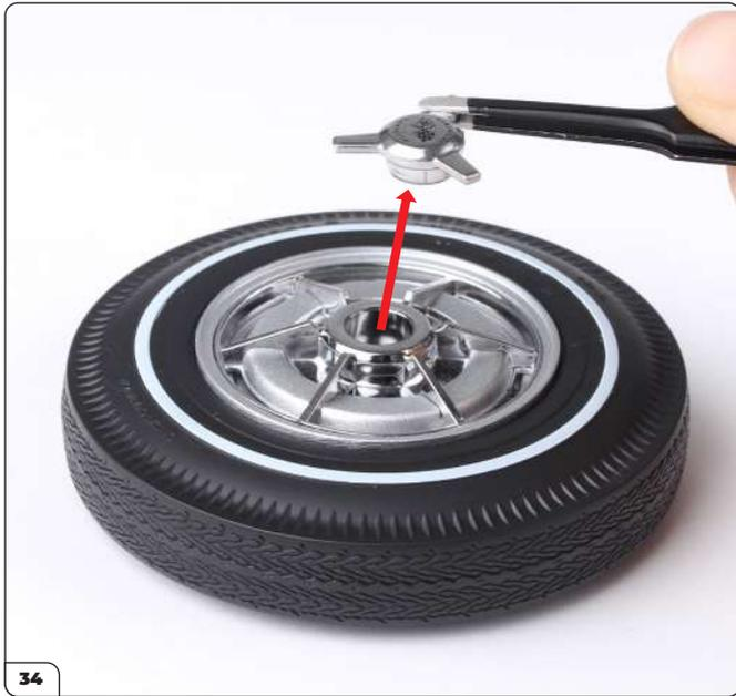
Entfernen Sie die Spinner von den in Bauphase 25 und 27 zusammengebauten Rädern, sofern erforderlich.
