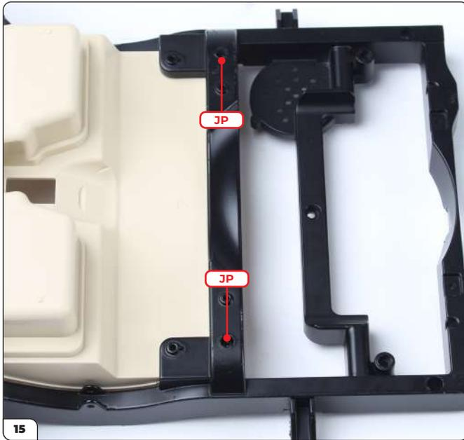
Drehen Sie 2 JP-Schrauben durch die Löcher im Heckchassis in den Cockpit-Boden.
