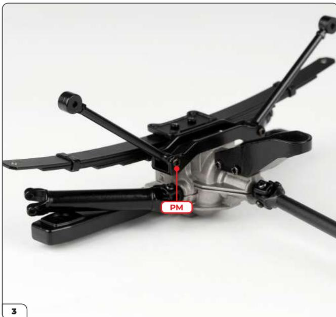
Bringen Sie die andere untere Schwingstange an und befestigen Sie sie mit einer PM-Schraube.
