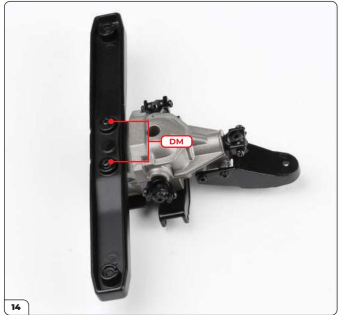
Befestigen Sie das Teil mit 2 DM-Schrauben.
