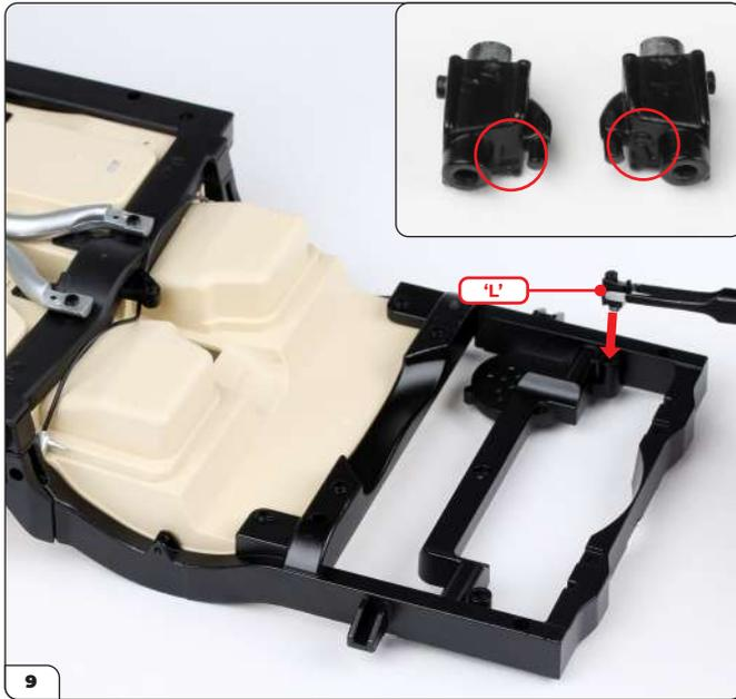
Die Auspuffrohrhalterungen sind mit „L“ und „R“ gekennzeichnet (siehe kleines Bild, eingekreist). Bringen Sie die linke Halterung „L“ am hinteren Chassis an (siehe Pfeil).
