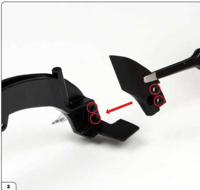
Legen Sie das rechte seitliche Schutzblech so an das Heckchassis an, dass die Schraublöcher aufeinander ausgerichtet sind (eingekreist).
