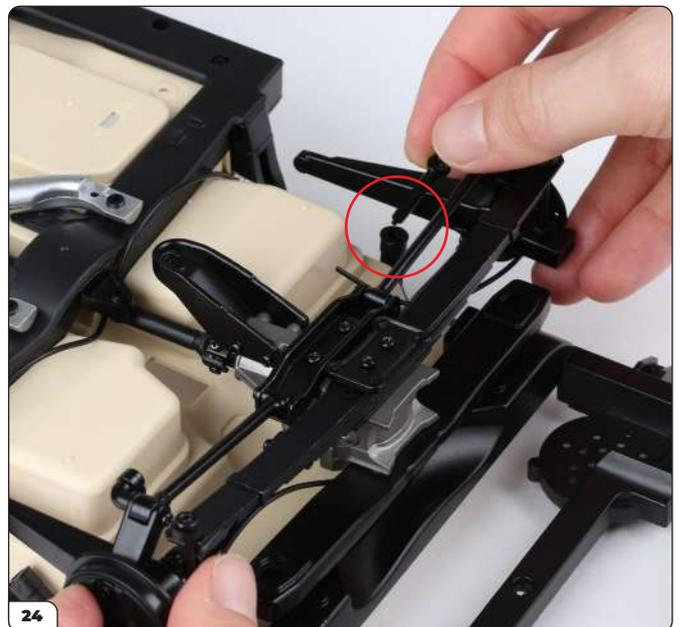
Führen Sie beim Anbringen der Baugruppe die Dämpferstangen in die Hülsen (eingekreist).
