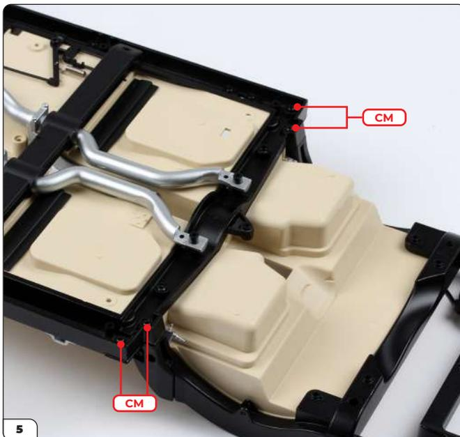
Befestigen Sie das Heckchassis mit 4 CM-Schrauben.
