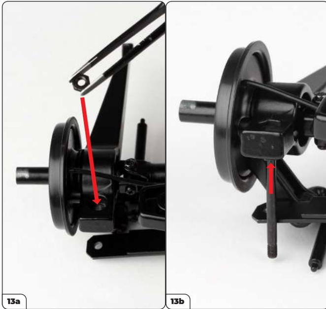
Drehen Sie die Baugruppe um und legen Sie eine Sechskantmutter in den linken oberen Querlenker (13a, siehe Pfeil). Schrauben Sie das lange Gewindeende der Strebenstange von unten in die eingelegte Sechskantmutter (13b, siehe Pfeil), bis die Spitze der Stange bündig mit der Mutter ist.
