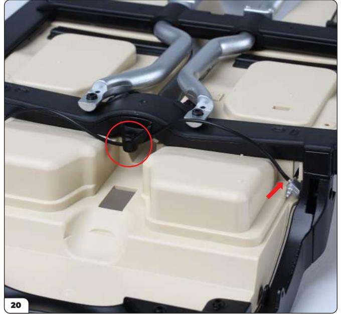
Führen Sie den Schlauch unter der Vorwölbung des Chassisrahmens (eingekreist) hindurch und stecken Sie das andere Ende auf den oberen Stift des linken Verbinders (siehe Pfeil).
