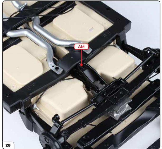
Beginnen Sie mit der Befestigung der Baugruppe, indem Sie eine AM-Schraube durch den Träger drehen.
