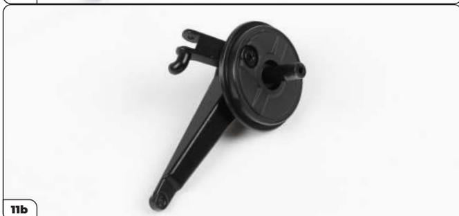
Stecken Sie die rechte Abdeckung für die Bremstrommel, die mit einem „R“ gekennzeichnet ist, auf den Achsschenkel.
