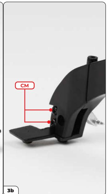
Befestigen Sie das rechte Schutzblech mit 2 CM-Schrauben (3a). Legen Sie das linke Schutzblech an und befestigen Sie es mit 2 CM-Schrauben (3b).
