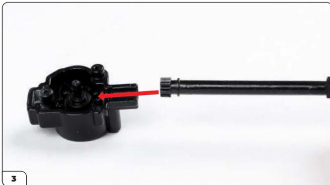
3 Stecken Sie die Getriebewelle so in das Getriebe, dass das Ende mit den Zähnen in das Antriebsrad greift (siehe Pfeil).
