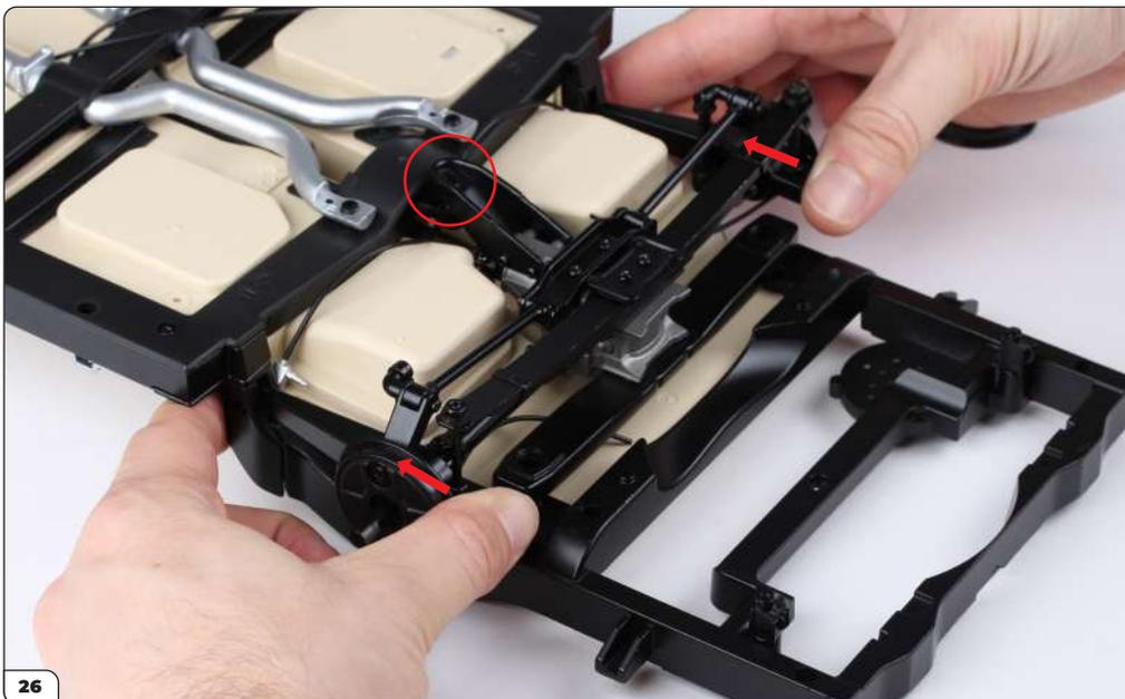
Drücken Sie fest auf die oberen Querlenker, bis der Träger auf das Schraubloch des Chassis ausgerichtet ist (eingekreist).
