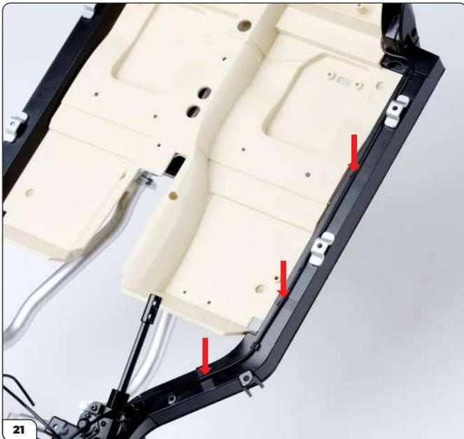
Befestigen Sie die Hauptbremseleitung mit den Klebebandstücken am Chassis (siehe Pfeile).
