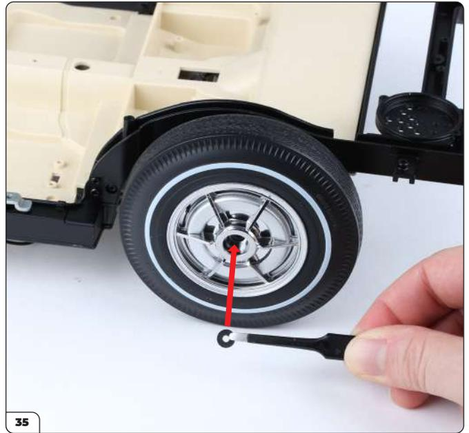
Bringen Sie das linke Hinterrad wie gezeigt am Achsschenkel an und legen Sie dann eine dünne Unterlegscheibe über das Ende des Zapfens (siehe Pfeil).
