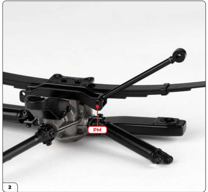
Befestigen Sie das Teil mit einer PM-Schraube.
