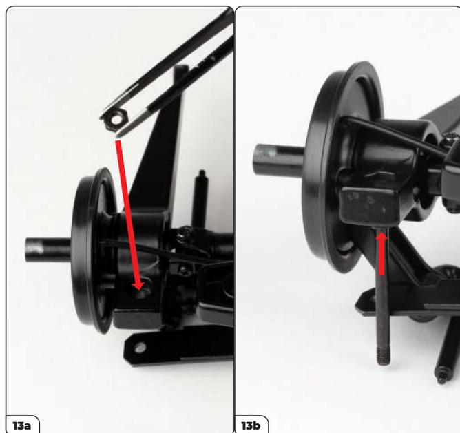
Retournez l'ensemble et placez un écrou hexagonal dans le bras de suspension supérieur gauche (13a, cf. flèche). Vissez par en dessous l'extrémité fileté longue de la tige de réaction dans l'écrou hexagonal que vous avez placé (13b, cf. flèche) jusqu'à ce que l'extrémité de la tige soit à niveau avec l'écrou.
