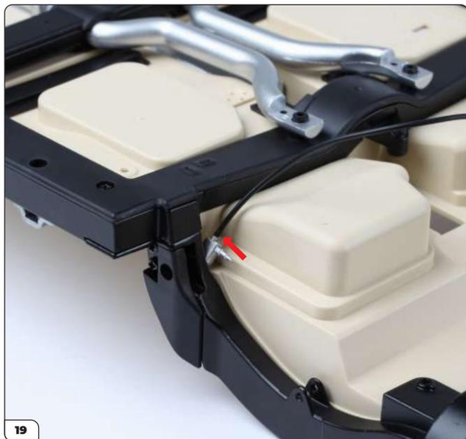
Branchez une extrémité du flexible de frein le plus long (130 mm) sur la broche supérieure du connecteur droit (cf. flèche).
