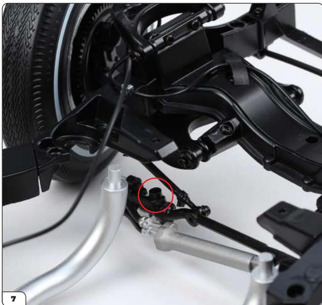
Le trou rond de la liaison s'adapte à la colonne de la barre de direction centrale (entourée).
