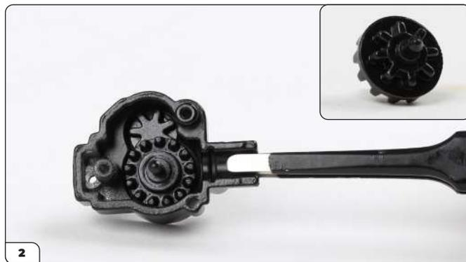
Installez l'engrenage moteur de sorte que le côté à huit dents (encadré) soit relié à l'engrenage de transmission.
