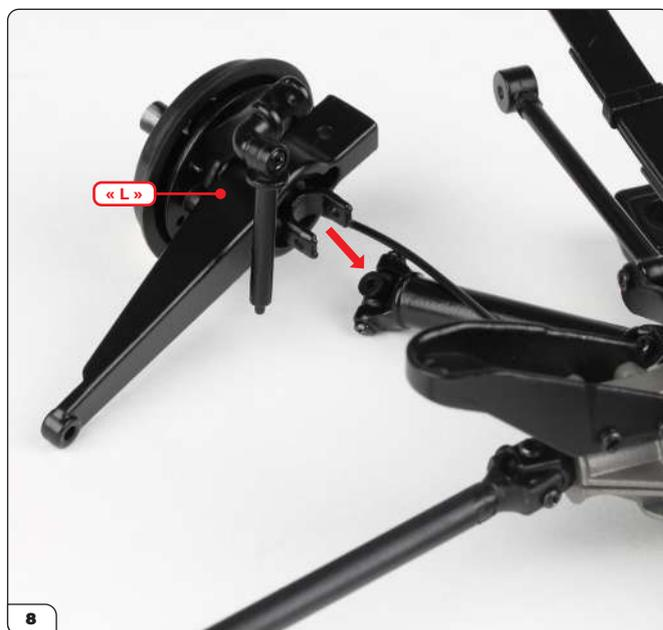
Alignez la rotule gauche avec l'arbre d'entraînement d'essieu sur le côté gauche du différentiel, tel qu'indiqué (cf. flèche).
