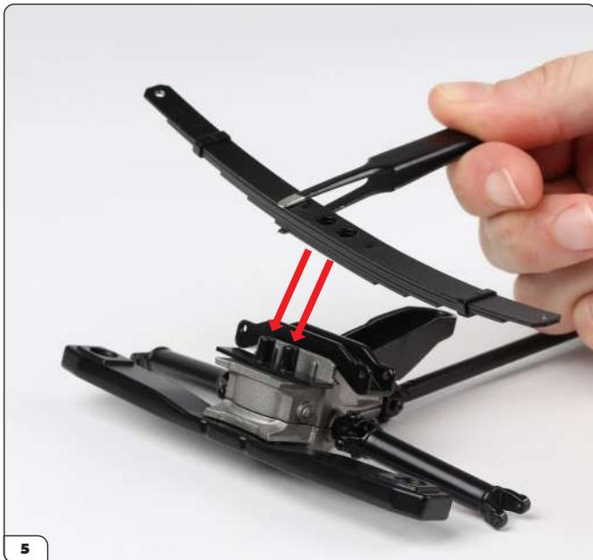
Montez le ressort à lames dans le sens indiqué sur les colonnes du montant de fixation (cf. flèches).
