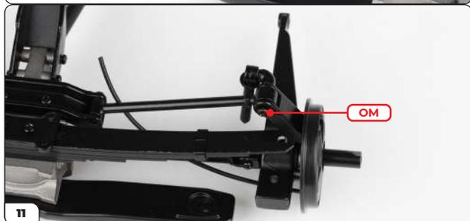
Insérez les grandes extrémités des barres stabilisatrices dans les bras de suspension inférieurs et fixez-les avec une vis OM.
