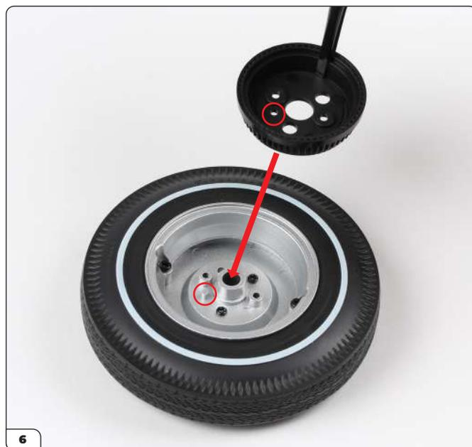
Montez le tambour de frein arrière droit sur la jante extérieure en utilisant la goupille de verrouillage et le trou pour bien aligner les pièces.
