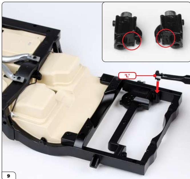
Les supports des tuyaux d'échappement sont marqués « L » (gauche) et « R » (droite) (encadré, entouré). Installez le support gauche (« L ») sur le châssis arrière (cf. flèche).
