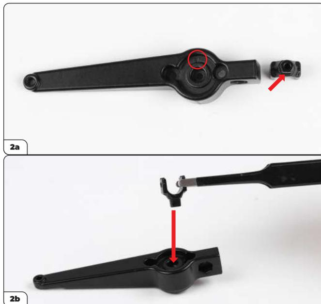
Prenez le bras de suspension supérieur gauche (2a, marqué d'un « L », entouré) ainsi qu'un connecteur d'arbre de transmission. Notez la colonne en forme de D (2a, flèche). Insérez le connecteur dans le bras de suspension (2b).
