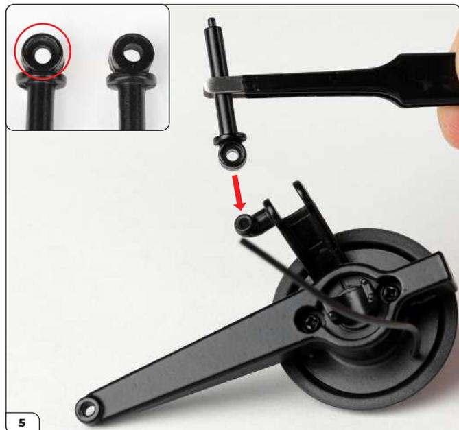
Positionnez une tige d'amortisseur arrière sur le bras de suspension inférieur de la rotule gauche (cf. flèche). Notez que la tige présente un renforcement d'un côté (encart, entouré) qui doit être orienté vers l'extérieur du bras de suspension.
