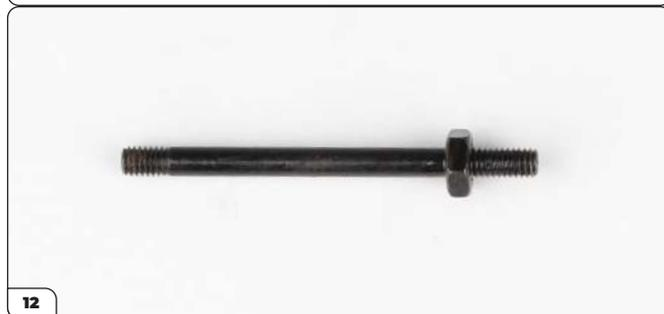
Vissez un écrou hexagonal sur l'extrémité fileté la plus longue d'une tige de réaction, tel qu'indiqué.
