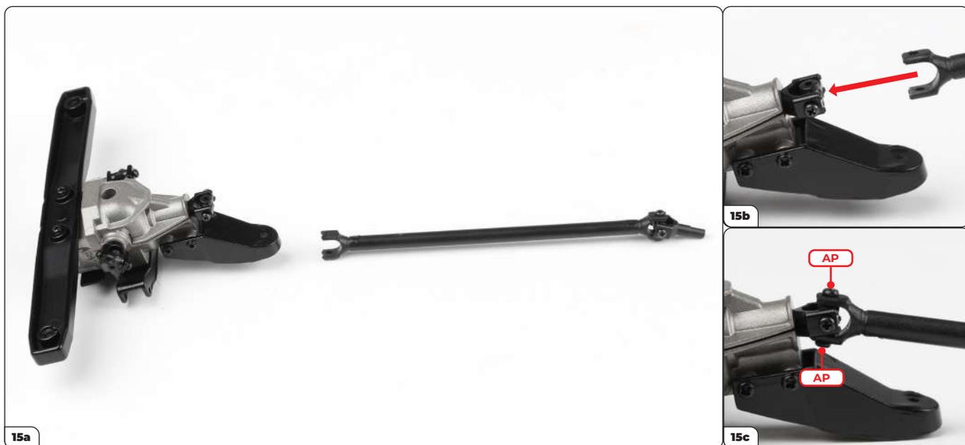
Alignez l'arbre de transmission (étape 23) avec le boîtier de différentiel arrière (15a). Placez le connecteur sur le joint central (15b, flèche) et fixez avec 2 vis AP (15c).
