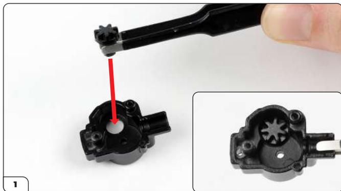
Placez l'engrenage de transmission à l'intérieur de la boîte de vitesses tel qu'indiqué (cf. flèche).
