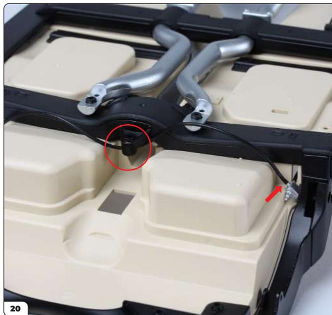
Faites passer le câble sous la protubérance du cadre du châssis (entourée) et enfoncez l'autre extrémité sur la broche supérieure du connecteur de gauche (cf. flèche).
