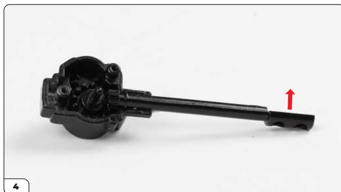
Tournez l'arbre de sorte que le côté plat de l'autre extrémité soit orienté dans le sens indiqué par la flèche. Les engrenages doivent tourner lorsque vous faites tourner l'arbre.
