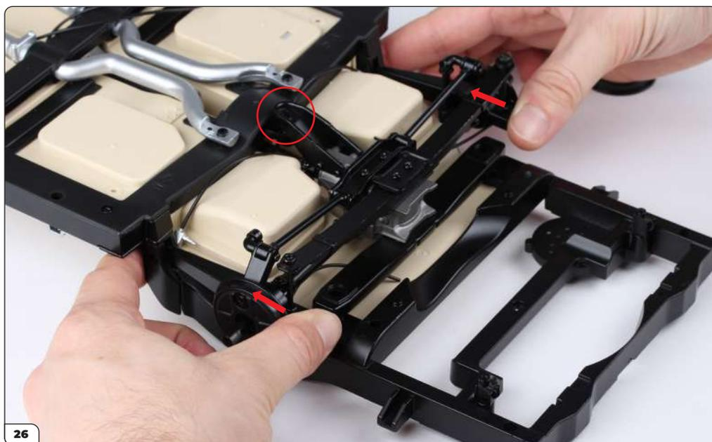
Poussez fermement jusqu'à ce que le support s'aligne avec le pas de vis du châssis (entouré).
