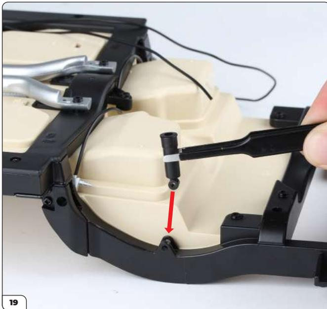
Montez un cylindre d'amortisseur arrière dans le châssis arrière tel qu'indiqué (cf. flèche).
