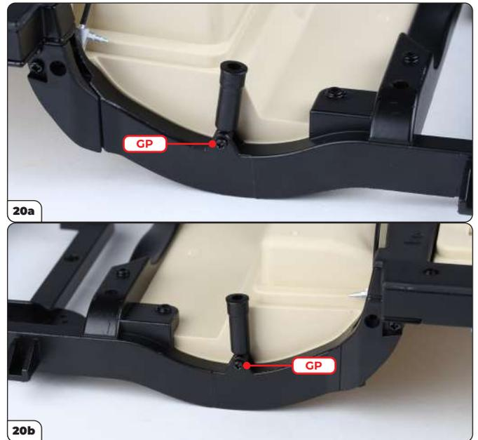
Fixez le cylindre avec une vis GP (20a). Montez l'autre cylindre de l'autre côté et fixez avec une vis GP (20b).
