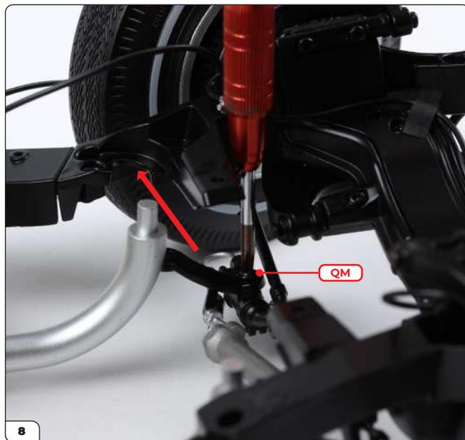
Fixez la liaison sur la colonne avec une vis QM, sans trop serrer, de sorte que l'autre extrémité de la liaison remonte vers le renforcement au niveau du châssis (cf. flèche).
