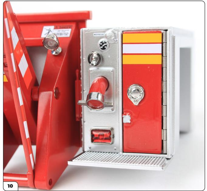
Empuja el compartimento eléctrico dentro de la sección media del cuerpo hasta que las muescas se asienten firmemente dentro de los agujeros de fijación.
