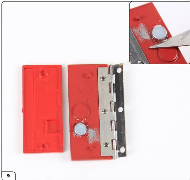
Gira la puerta del compartimento para que el lado inverso quede hacia arriba y alíneala con la puerta interior del compartimento. Los dos pines en el reverso de la puerta corresponden a los dos agujeros en el panel de la puerta interior. Prueba a encajar las piezas. Nota: es posible que necesites recortar el exceso de rebaba alrededor del imán utilizando una cuchilla (insertada) para encajar el imán en el hueco cuadrado en el panel de la puerta.
