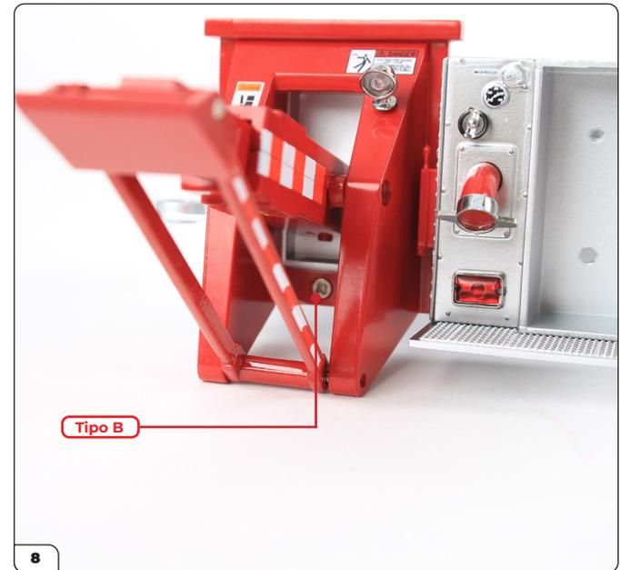
Con el estabilizador en posición vertical, inserta otro tornillo Tipo B a través del par inferior de agujeros para tornillos.
