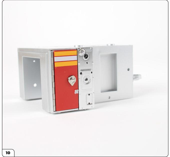
Presiona las muescas en el lado posterior del panel de suministro de agua en los orificios de la sección media del cuerpo.
