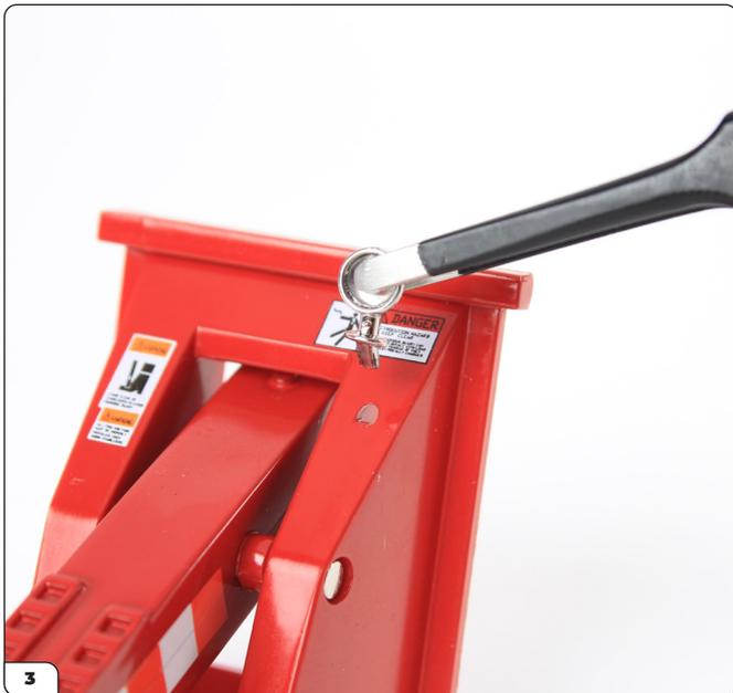
Alinea la luz de suelo con el agujero en forma de D en el estabilizador. La luz, por supuesto, debe apuntar hacia el suelo. Aplica una gota de pegamento al pasador de la luz de suelo.
