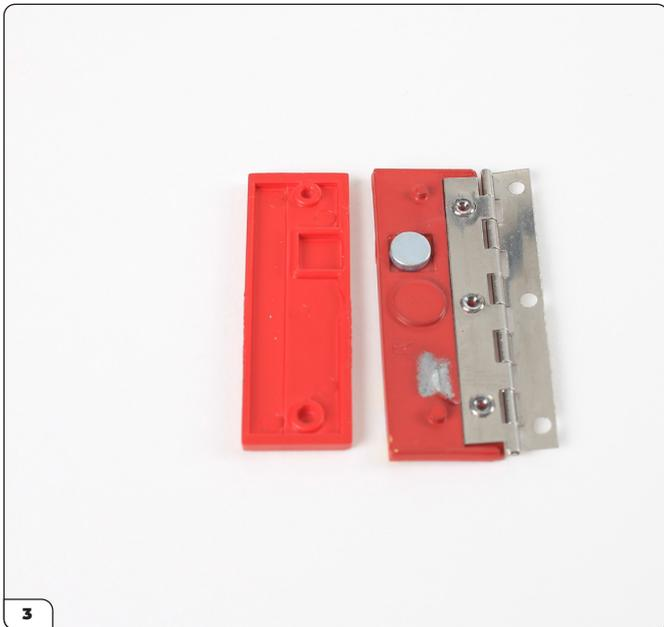
Coloca la puerta del compartimento de manera que el lado inverso quede hacia arriba, y alíneala con la puerta interior del compartimento. Los dos pines en el reverso de la puerta corresponden a los dos agujeros en el panel de la puerta interior. Prueba a encajar las piezas. Nota: puede que necesites recortar el exceso de rebaba alrededor del imán con una cuchilla, para encajar el imán en el hueco cuadrado en el panel de la puerta.
