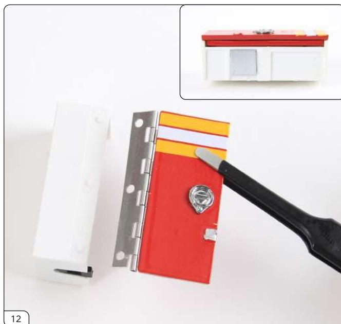
コンパートメント外扉のヒンジを電装コンパートメントの3つの突起に合わせて合わせます。開口部の縁(外扉と電装コンパートメント)をぴったりと合わせましょう(右上小写真)。しっかりと押さえて固定します。
