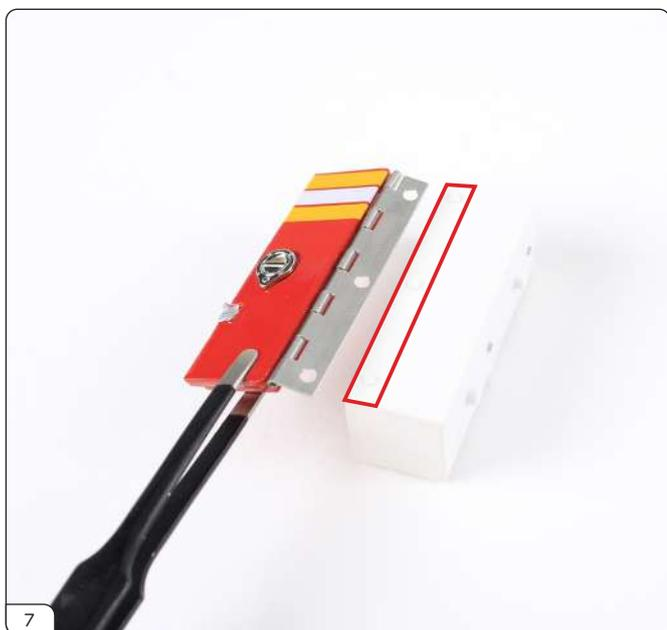
コンパートメント外扉を電装コンパートメントに取り付けます。突起がある右側の平らな面（赤線部分）に瞬間接着剤を少量塗布します。
