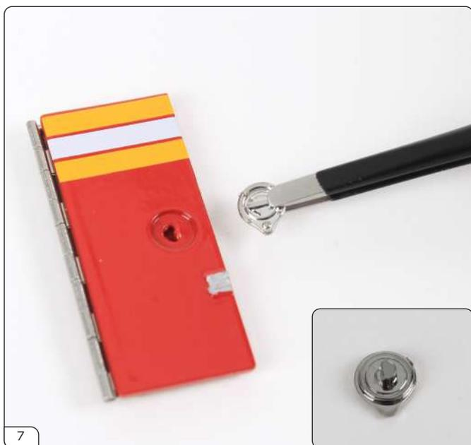
D型の切り欠き突起 (右下小写真) に合わせて、コンパートメントドアハンドルを押し込んで固定します。
