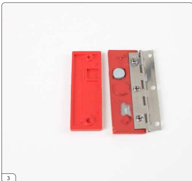
コンパートメント外扉を裏返し、コンパートメントインナーダアパネルと合わせます。コンパートメント外扉の2つの突起が、コンパートメントインナーダアパネルの穴に対応しています。写真のようにマグネットを接着されています。2つのパーツがうまくはまらなければ、マグネットの周りの余分な接着剤などを削ってみましょう。
