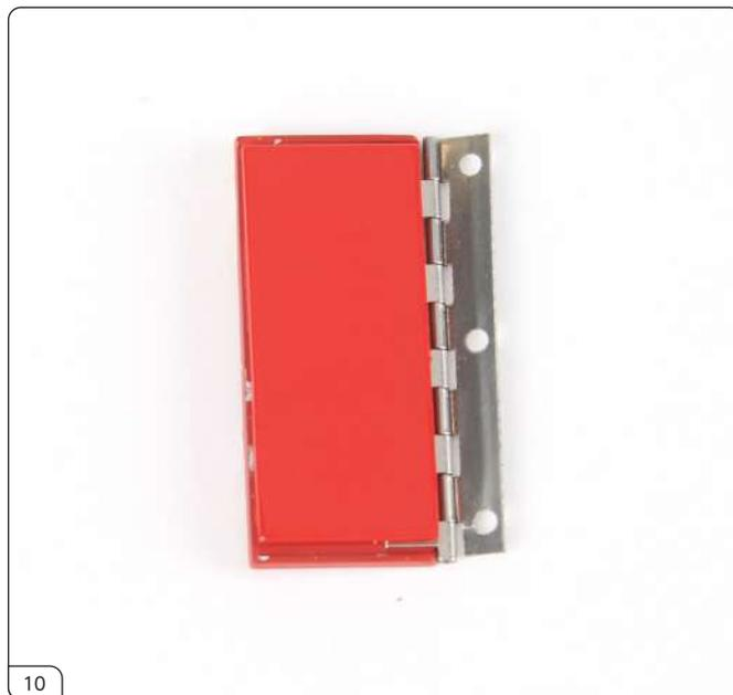
うまくはまったら、コンパートメントインナードアパネルの2つの穴に瞬間接着剤を少量塗布して、パーツを合わせて固定します。
