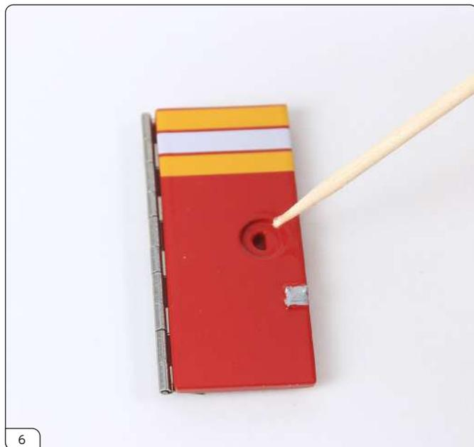
コンパートメント外扉にコンパートメントドアハンドルを取り付けます。凹部に瞬間接着剤を少量塗布します。
