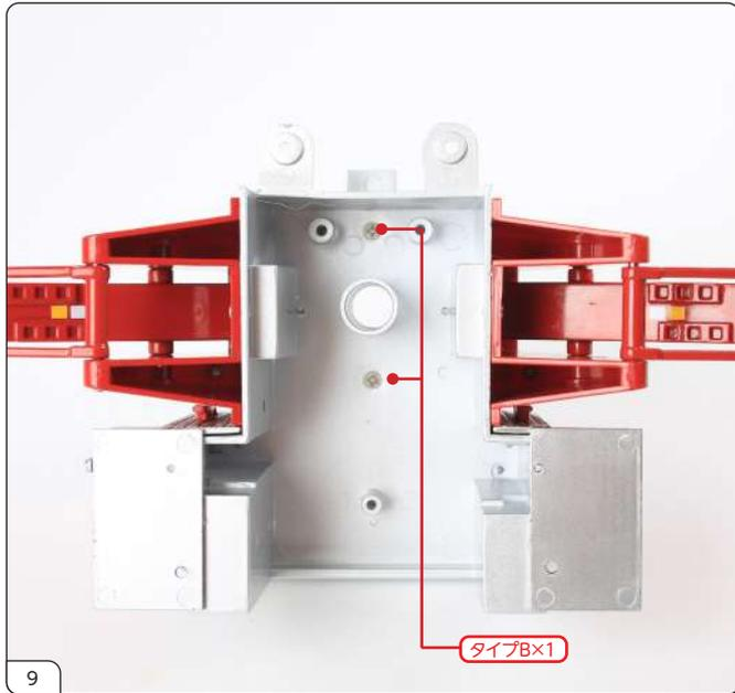
ルーフを固定したままボディミッドセクションを裏返し、タイプBのネジ2本で固定します。
