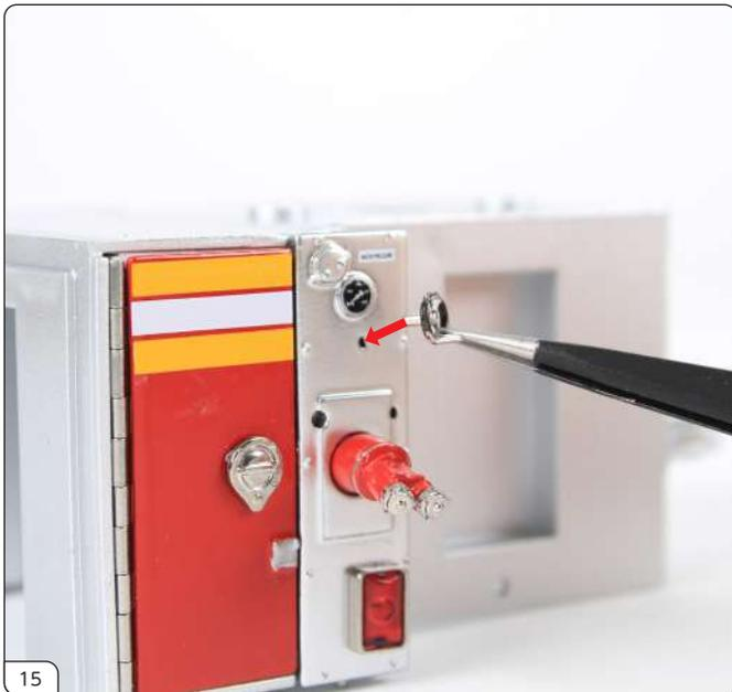
供給バルブを左給水パネルのD型の切り欠き穴に合わせます。しっかりと押し込んで固定します。
