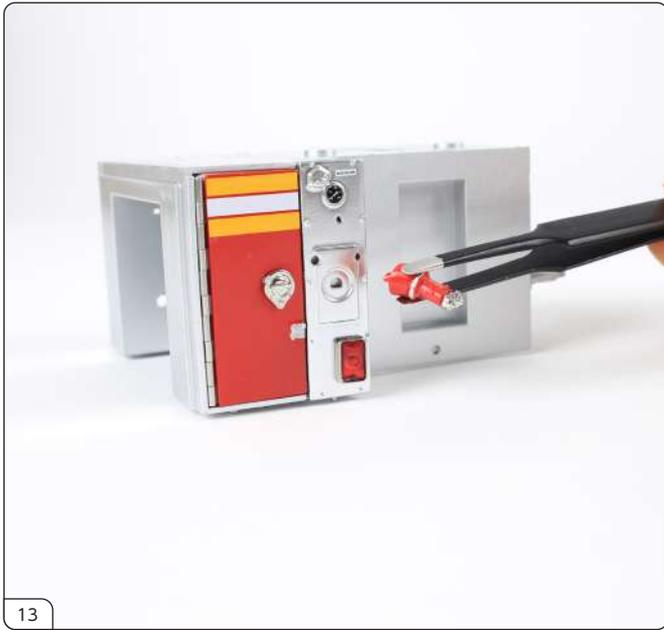
供給コネクションの突起を、左給水パネルのD型切り欠き穴に合わせて、しっかりと押し込んで固定します。
