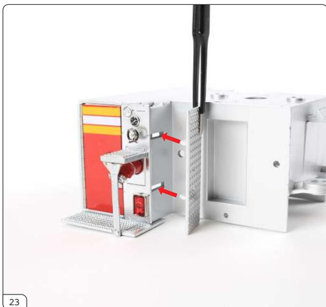
ボディミッドセクションの左給水パネル横の2つのスロット（長さが異なります）に、左サイドパネルのラグを合わせます。
