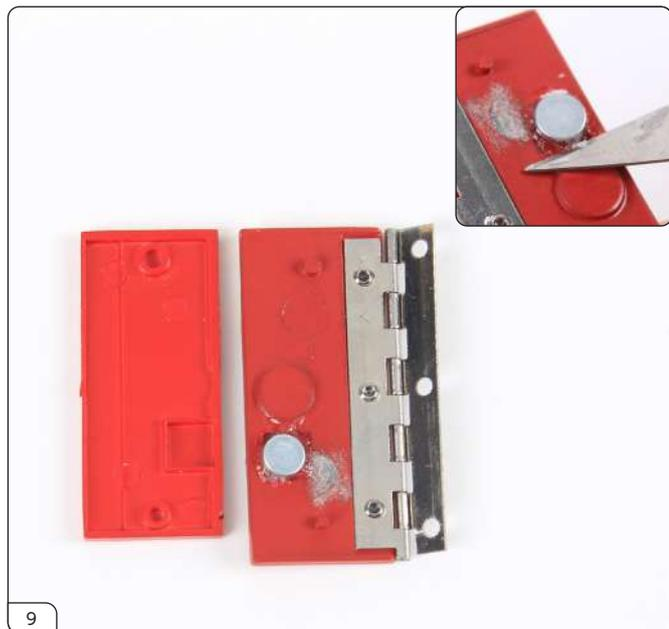
コンパートメント外扉を裏返し、コンパートメントインナードアパネルと合わせます。コンパートメント外扉の2つの突起が、コンパートメントインナードアパネルの穴に対応しています。写真のようにマグネットが接着されています。2つのパーツがうまくはまらなければ、マグネットの周りの余分な接着剤などを削ってみましょう(右上小写真)。
