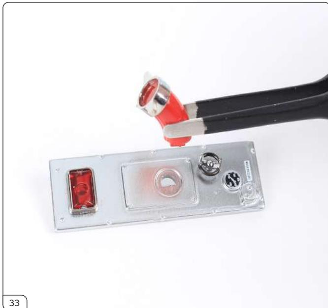
大供給キャップを付けた供給エルボーを、右給水パネルのD型切り欠き穴にはめ込みます。
