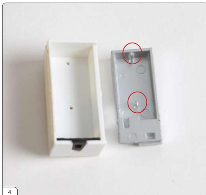
電装パネルを電装コンパートメントに取り付けます。裏面にある2つの突起(赤丸印)が、電装コンパートメントの穴に対応します。
