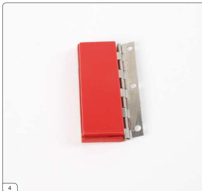
うまくはまったら、コンパートメントインナーダアパネルの2つの穴に瞬間接着剤を少量塗布して、パーツを合わせて固定します。
