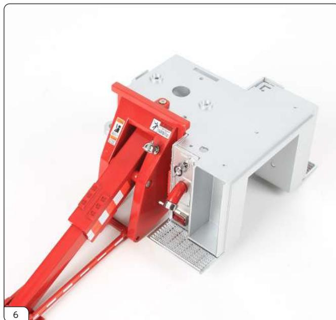
写真5の右アウトリガー1の部分の穴を、ボディミッドセクション上面の1の穴に合わせてます。これで自ずから下方の2の穴も合うはずですが。
