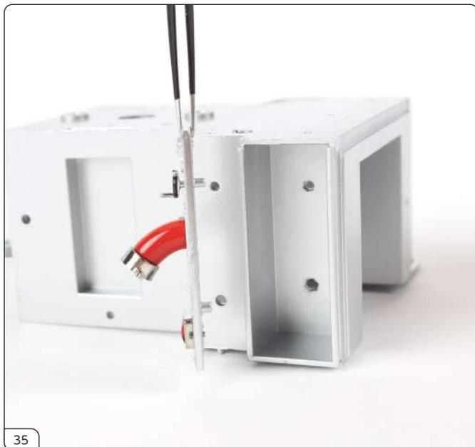
右給水パネルをボディミッドセクションに取り付けます。右給水パネルの突起を穴に合わせます。
