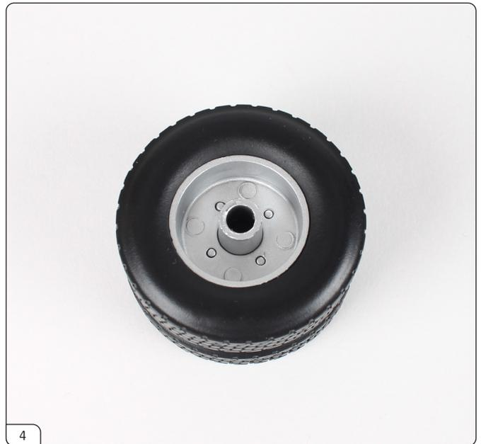
アウターホイールの4つの突起をインナーホイールの穴に合わせて、しっかりと押し付けます。
