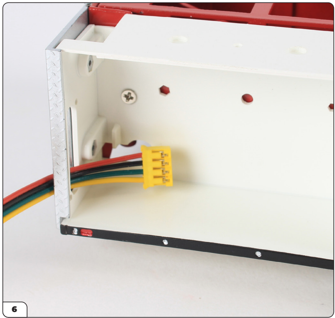
Pasa el extremo del enchufe de la placa de circuito a través del panel trasero, y a través de la apertura en el compartimento.
