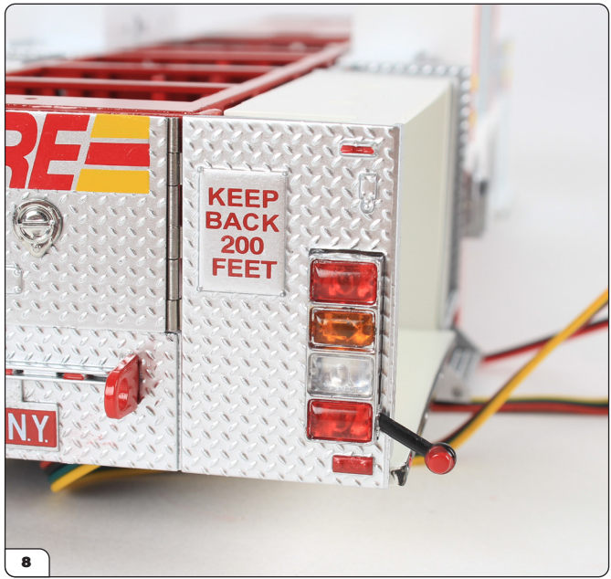
Tira del cable tanto como sea posible hasta que la placa de circuito esté sujeta contra el panel trasero. Empuja el conjunto de luces firmemente en su lugar para que quede al ras.
