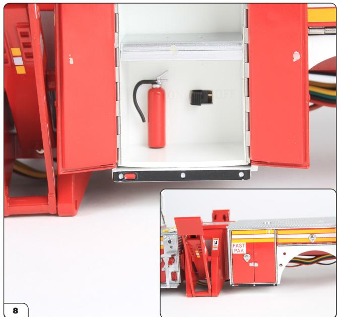
È una buona idea controllare i collegamenti elettrici a questo punto. Inizia installando 3 batterie AAA nel vano batterie (immagine 7) prima di spostare l'interruttore ON/OFF sulla posizione 'ON' (immagine 8). L'interruttore si trova sul lato sinistro, nell'armadietto accanto al poggiapiedi contrassegnato con 'FAST PAK' (inserimento).
