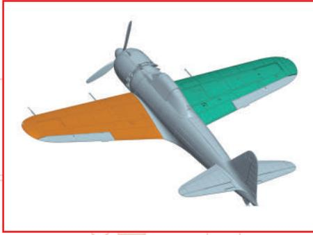
Fixez le revêtement supérieur de l'aile gauche 090-01 fourni avec l'étape 90 dans l'aile gauche et vissez-le avec deux vis 090-02. Fixez le revêtement supérieur de l'aile droite 092-01 fourni avec l'étape 92 dans l'aile droite et vissez-le avec deux vis 092-02. Vérifiez que les 9 tenons, grands et petits, des revêtements supérieurs s'insèrent bien dans les trous.
