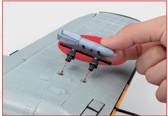
1 Insérez le réservoir largable assemblé à l'étape 81 dans les trous (un grand et un petit) du caisson central, puis insérez les deux ergots des suspensions de bombes 070-02 et 080-03 dans les trous correspondants des ailes.
