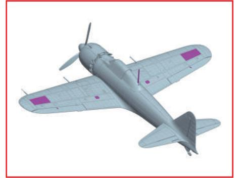
Fixez les panneaux 094-05 et 094-08 sur la surface supérieure de l'aile gauche et fixez les panneaux 094-06 et 094-09 sur la surface supérieure de l'aile droite. Insérez l'antenne 094-10 dans le trou situé à l'arrière du cockpit. Placez les caches de tringlerie 094-07 sur les ailerons de gauche et de droite.
