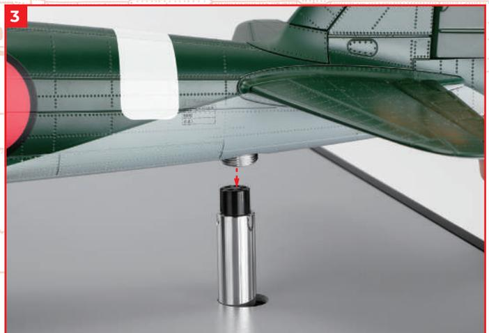
3 Placez les ailes gauche et droite du Zéro sur les deux barres de maintien à l'avant du socle, puis raccordez le connecteur à l'arrière de l'avion au tuyau de connexion d'alimentation situé à l'arrière du socle.
