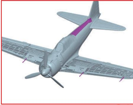
Montez les revêtements de fuselage 094-01 et 094-02 sur le dessus du fuselage. Insérez la mitrailleuse de 20 mm 094-03 dans l'aile droite. Puis insérez une autre mitrailleuse de 20 mm 094-03 ainsi que le tube de Pitot 094-04 dans l'aile gauche. Faites attention à ne pas casser les mitrailleuses ni les tubes de Pitot pendant cette opération.
