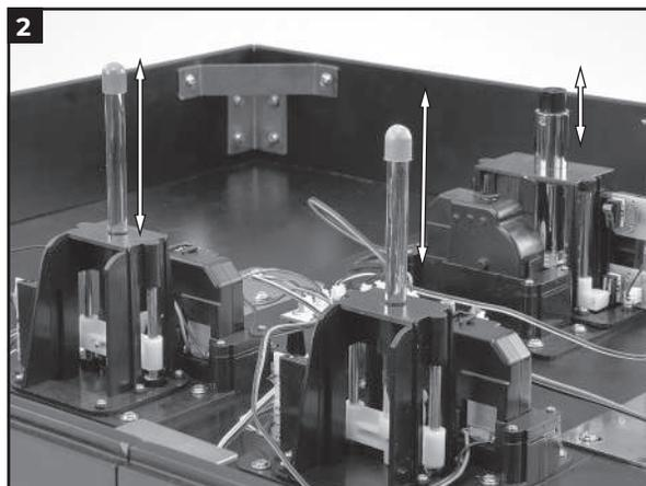
L'initialisation devrait commencer peu après : les barres du mécanisme d'élévation montent et descendent une fois, puis s'arrêtent en position de veille. Attendez environ 10 secondes avant de déclencher les différents effets. Une fois le bon fonctionnement vérifié, appuyez de nouveau sur le bouton d'alimentation de la télécommande pour éteindre l'appareil, puis éteignez le socle.
