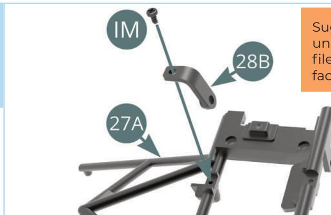
Suggerimento: utilizza una goccia d'olio sulla filettatura della vite per facilitarne l'inserimento.
