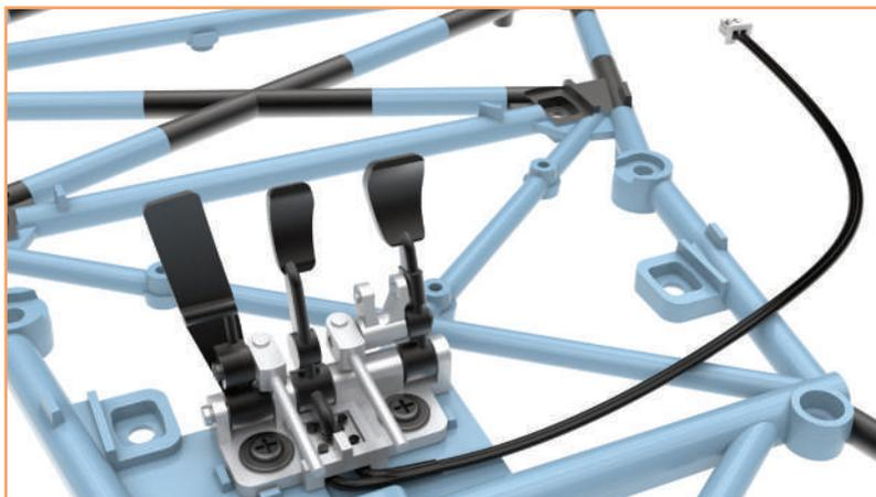
La pedaliera installata sul telaio.
