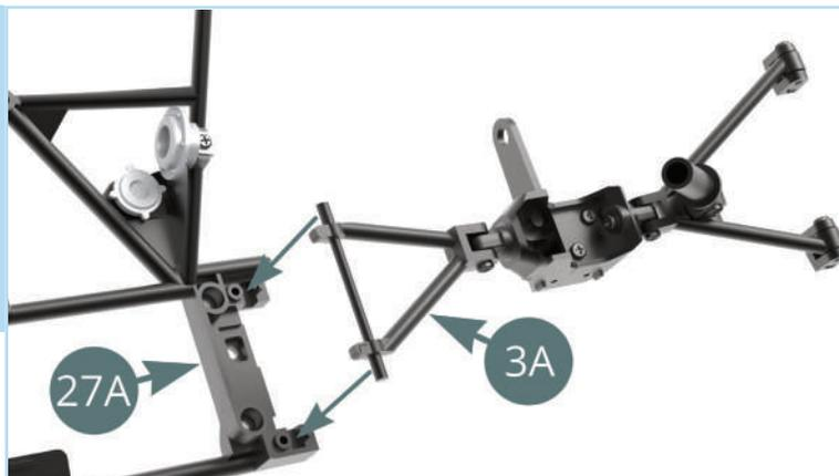
Fissa il gruppo della sospensione anteriore sinistra al telaio inserendo le due **piastre (27B)** sul **braccio di controllo superiore (3A)** e fissandole con una vite **BM**.
