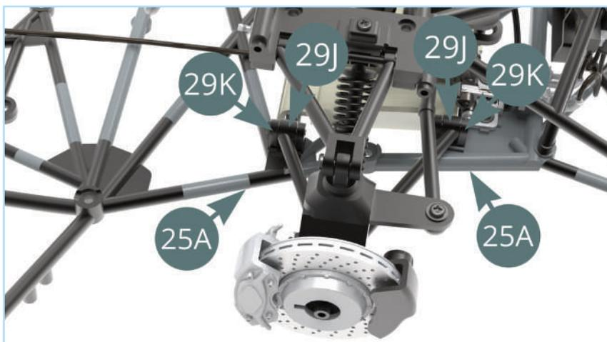
Verifica che le due staffe dei **bracci di comando inferiori** (29K) siano posizionate correttamente nei fori del **telaio** (25A).
