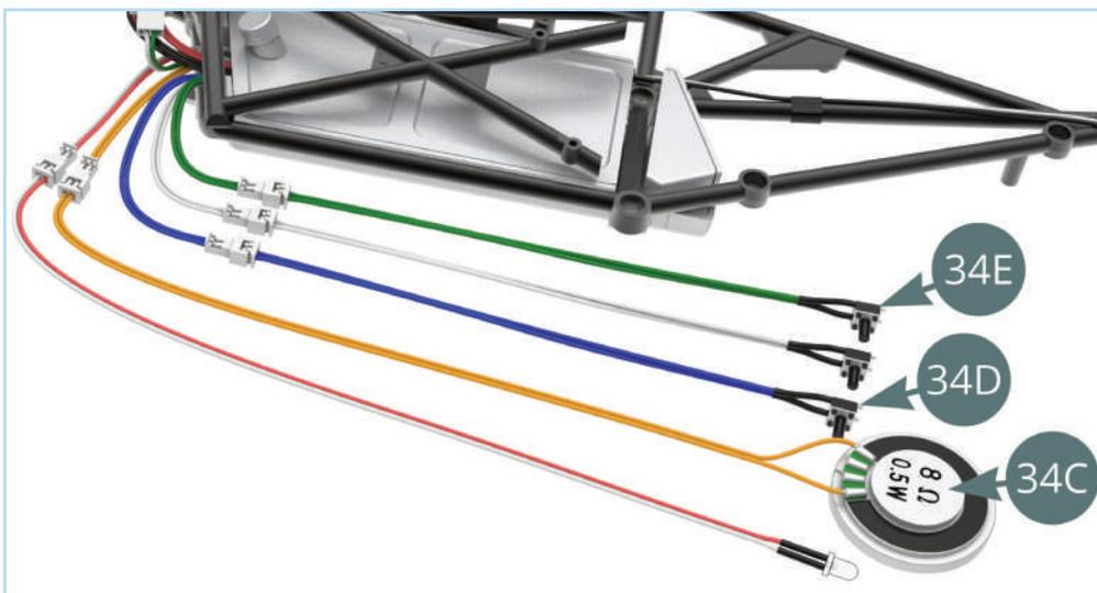
Premi l'interruttore del clacson (verde) **(34E)**: si dovrebbe sentire il suono del clacson attraverso l'altoparlante **(34C)**. Premi **l'interruttore del suono del motore (blu) (34D)**: si dovrebbe sentire il suono del motore attraverso **l'altoparlante (34C)**.
