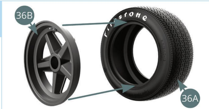
Premi il **cerchione interno della ruota anteriore (36C)** nello **pneumatico anteriore (36A)**, facendo attenzione ad allineare i fori delle viti con il **cerchione esterno (36B)**. Inserisci tre viti **BM** per fissare le parti tra di loro.
