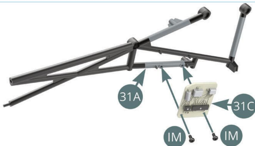
チューブラーフレーム (31B) を画像のようにチューブラーフレーム (31A) に合わせ、IMネジで固定します。
