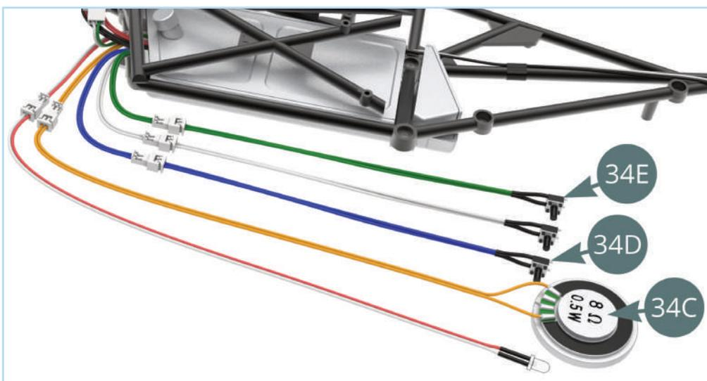
ホーンスイッチ(緑/34E)を押すと、スピーカー(34C)からホーンの音が聞こえます。エンジンサウンドスイッチ(青/34D)を押すと、スピーカー(34C)からエンジン音が聞こえます。
