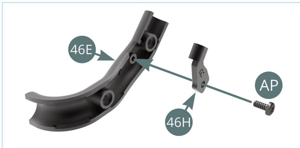
Posiziona la **staffa di supporto (46H)** sulla **linea di raffreddamento della trasmissione (46E)** e fissala con una vite **AP**.
