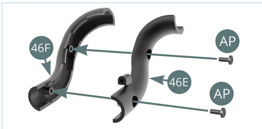
Monta le due metà della **linea di raffreddamento della trasmissione (46E e 46F)** e fissale con due viti **AP**.
