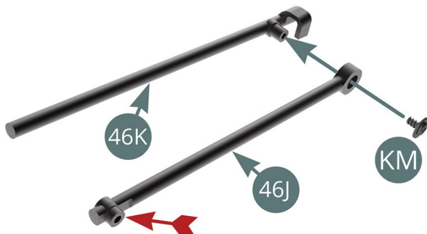
Assembla le due parti del **braccio di sollevamento del cofano (46J e 46K)** facendo attenzione all'orientamento del foro della vite indicato dalla freccia rossa. Tieni saldamente le parti e uniscile con una vite **KM**.
