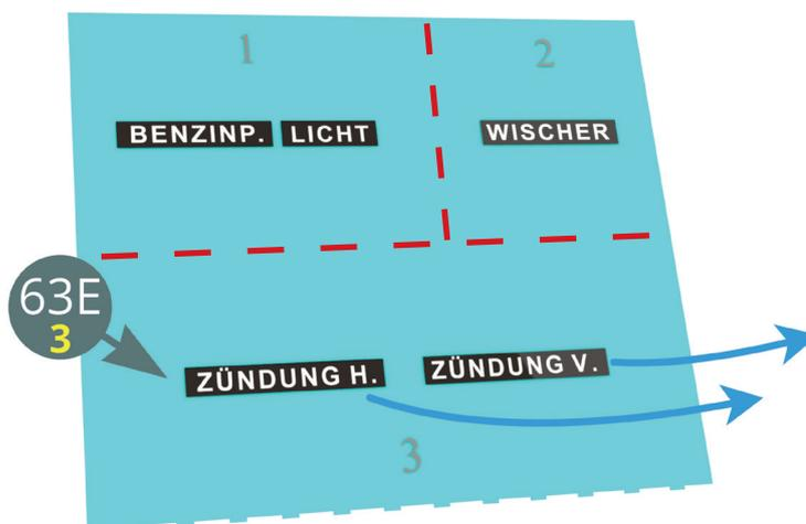
Applica le **decalcomanie (63E-3)** sopra i quattro fori del **cruscotto (63A)** come mostrato. Usa il pennello per regolare la posizione delle decalcomanie.
