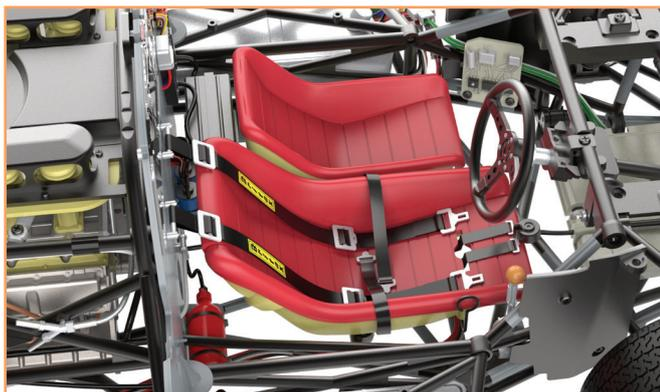
Il sedile del passeggero e quello del pilota sono stati fissati al telaio.
