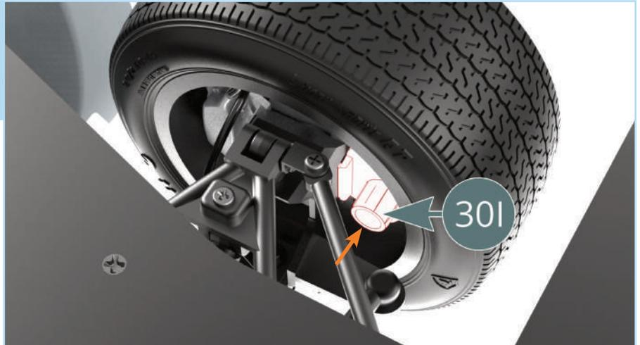
Positionner la gaine de refroidissement du frein droit 78B sur la prise d'air de l'écope de frein droit 30I (ici vue par au-dessus).
