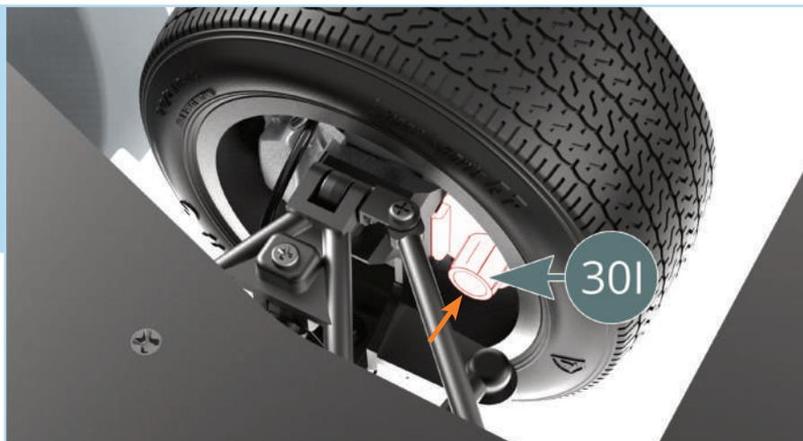
Con il gruppo in posizione verticale sulla superficie di lavoro, monta l'estremità curva del **tubo di raffreddamento del freno anteriore destro (78B)** sulla presa d'aria.
