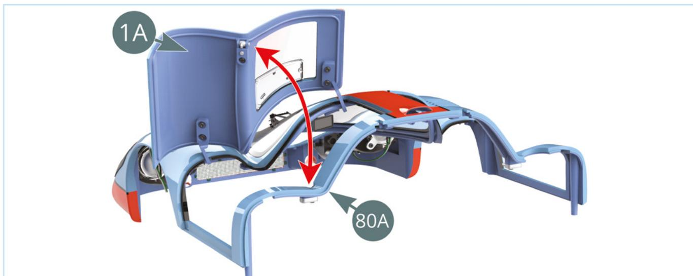
La portiera dovrebbe rimanere in posizione una volta aperta. In caso contrario, regola la vite **NM** che tiene al suo posto il morsetto assemblato allo step 2.
