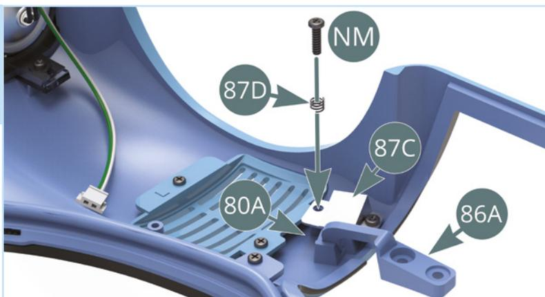
Non stringere eccessivamente la vite **NM**: deve esserci spazio sufficiente affinché la molla si comprima quando si apre la porta. Controlla muovendo la cerniera.
