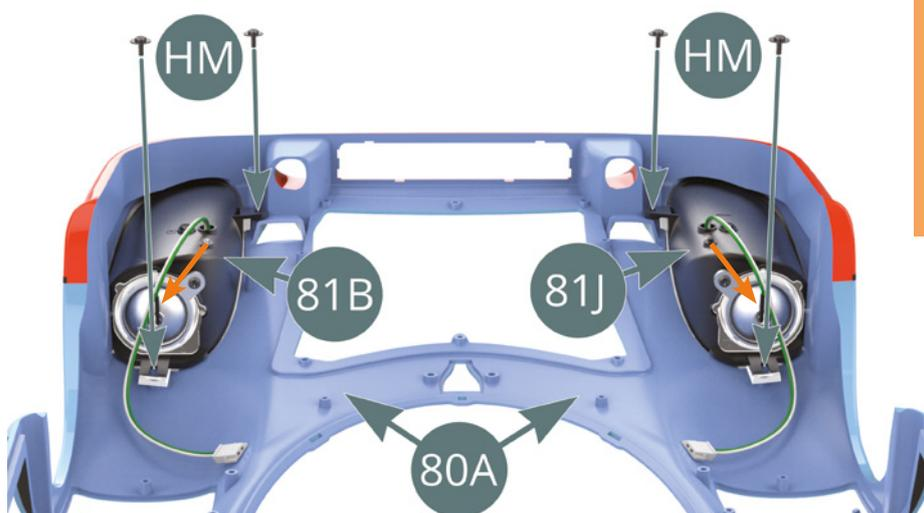
Sposta con attenzione i cavi LED fari dai fori delle viti prima di fissare gli alloggiamenti (freccie arancioni).
