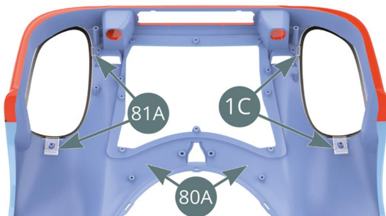
Prendi la **carrozzeria anteriore (80A)** e posizionala capovolta sul piano di lavoro. Ricordati di utilizzare una superficie protettiva ogni volta che lavori sulla carrozzeria. Inserisci gli **schermi dei fari sinistro e destro (1C e 81A)** come mostrato.
