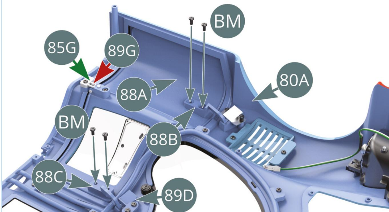
Tenendo la **carrozzeria anteriore (80A)** capovolta, monta la **portiera destra (88A)** e inserisci il **gancio di chiusura (89G)** nella serratura della **portiera destra (85G)**, come mostrato dalle frecce rossa e verde. Fissa le **cerniere inferiore e superiore (88B e 88C)** alla portiera con quattro viti **BM**.
