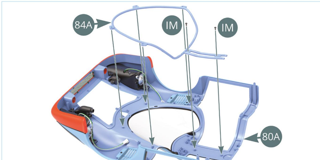
Posiziona la **carrozzeria anteriore (80A)** capovolta sul piano di lavoro. Monta il **rollbar superiore (84A)** sulla carrozzeria come mostrato dalle frecce verdi. Fissa la parte posteriore del rollbar con due viti **IM**.
