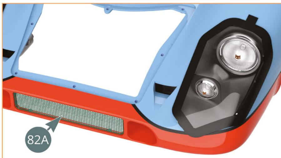
La griglia presa d'aria frontale è stata installata sulla carrozzeria anteriore.
