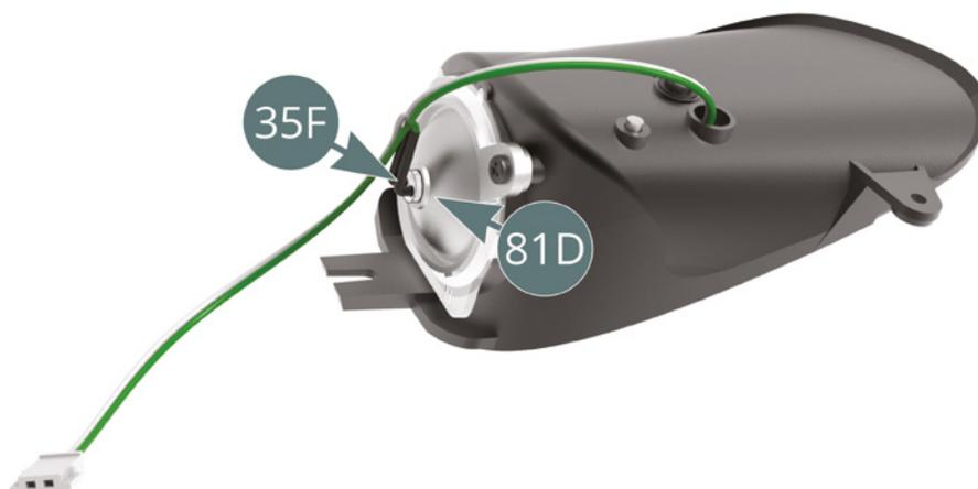
Inserisci il **LED fari (35F)** con il cavo più corto nel foro del **riflettore del faro (81D)**.
