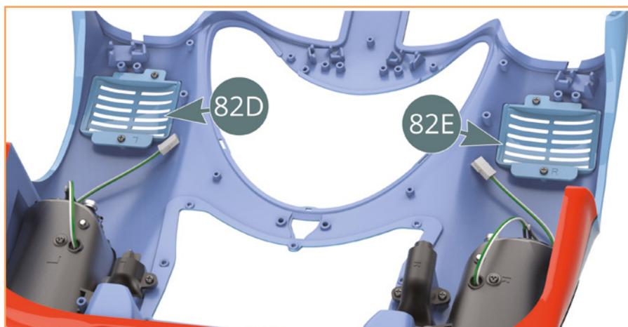
Una volta fissati alla carrozzeria anteriore, gli sfiati passaruota dovrebbero avere il seguente aspetto.
