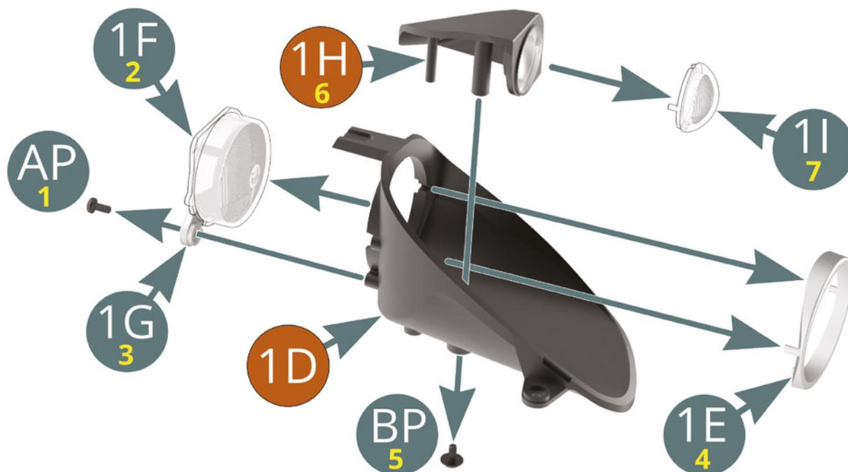
Alcune parti del faro sinistro sono state migliorate, quindi il faro sinistro assemblato nella Fase 1 deve essere smontato per sostituire alcuni alloggiamenti con le nuove parti fornite in questa fase. L'ordine di smontaggio è contrassegnato dalle cifre gialle nell'immagine qui sopra.
