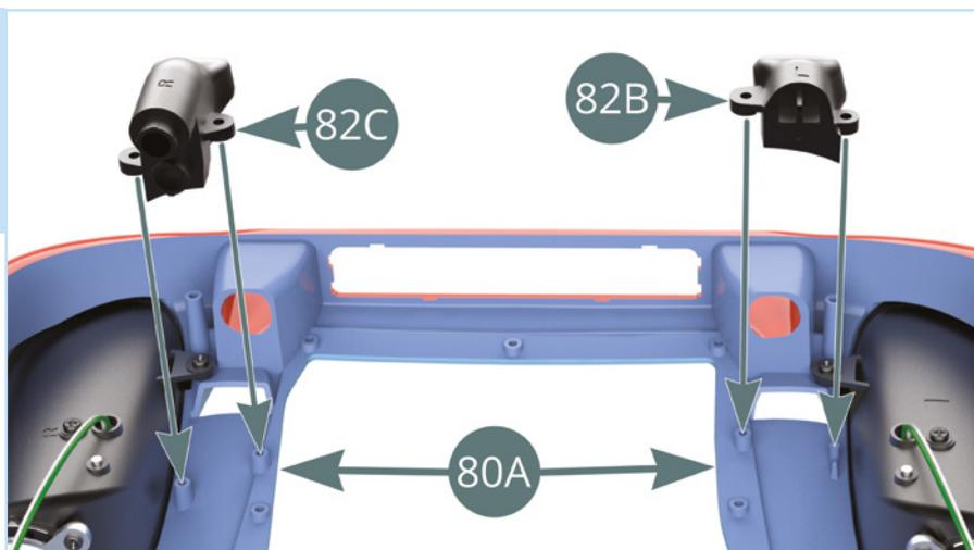
Utilizza tre viti **IM** per fissare le prese d'aria alla carrozzeria: due viti per la destra e una vite per la sinistra, come mostrato.
