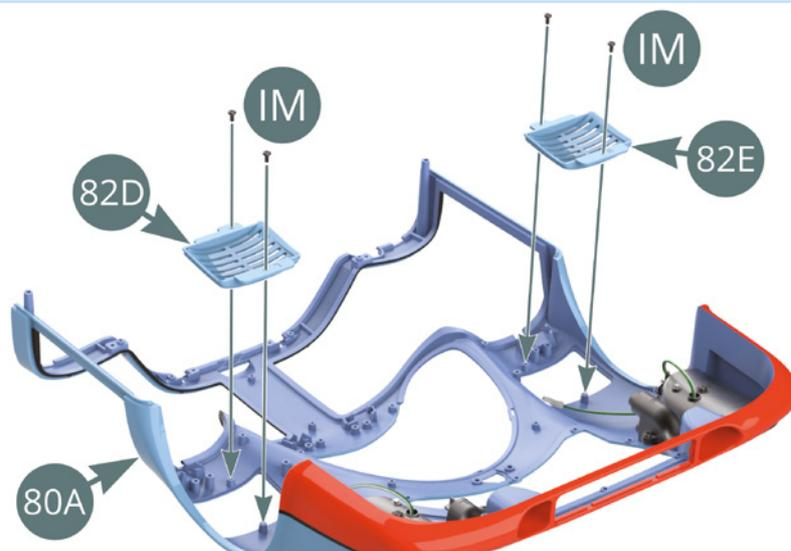
Monta gli **sfiati passaruota sinistro e destro (82D e 82E)** sulla parte interna della **carrozzeria anteriore (80A)**, quindi fissali utilizzando quattro viti **IM**.
