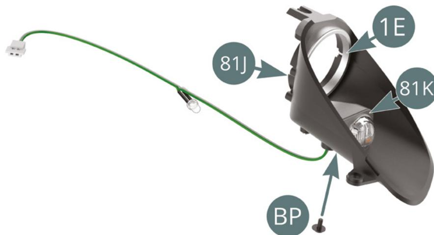
Inserisci l'**alloggiamento del faro sinistro piccolo (81K)** nell'**alloggiamento del faro sinistro (81J)** e fissalo con una vite **BP**. Una volta posizionata, inserisci la **mascherina del faro (1E)** nell'alloggiamento.
