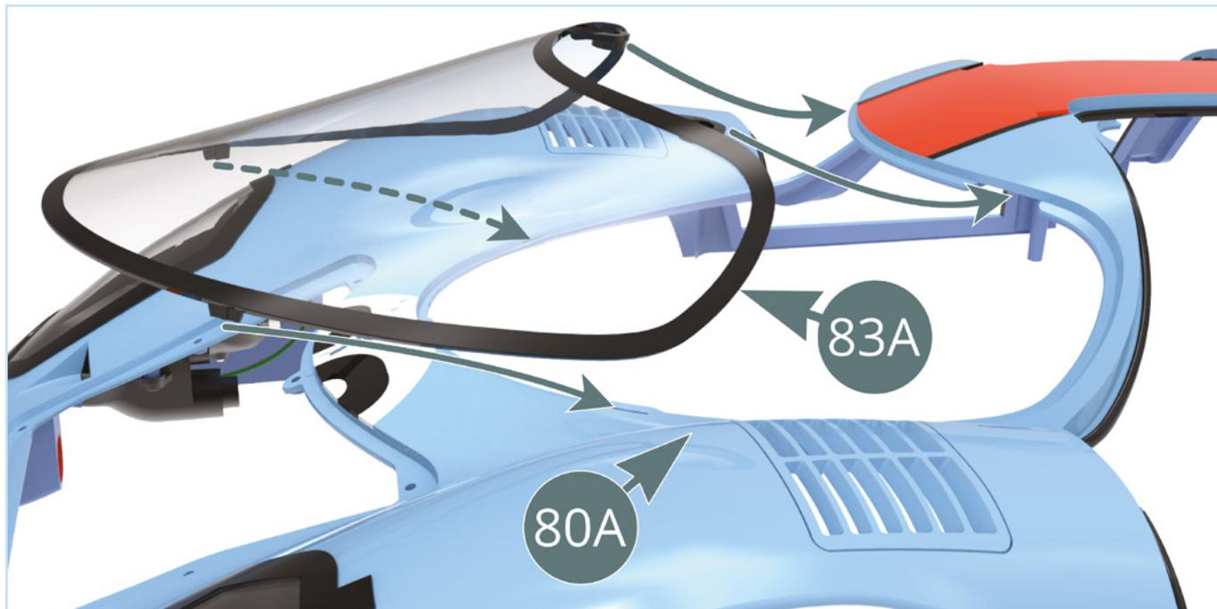
Individua i fori delle viti e le linguette sul **parabrezza (83A)** e i corrispondenti punti di fissaggio sulla **carrozzeria anteriore (80A)**, quindi monta il parabrezza come mostrato.
