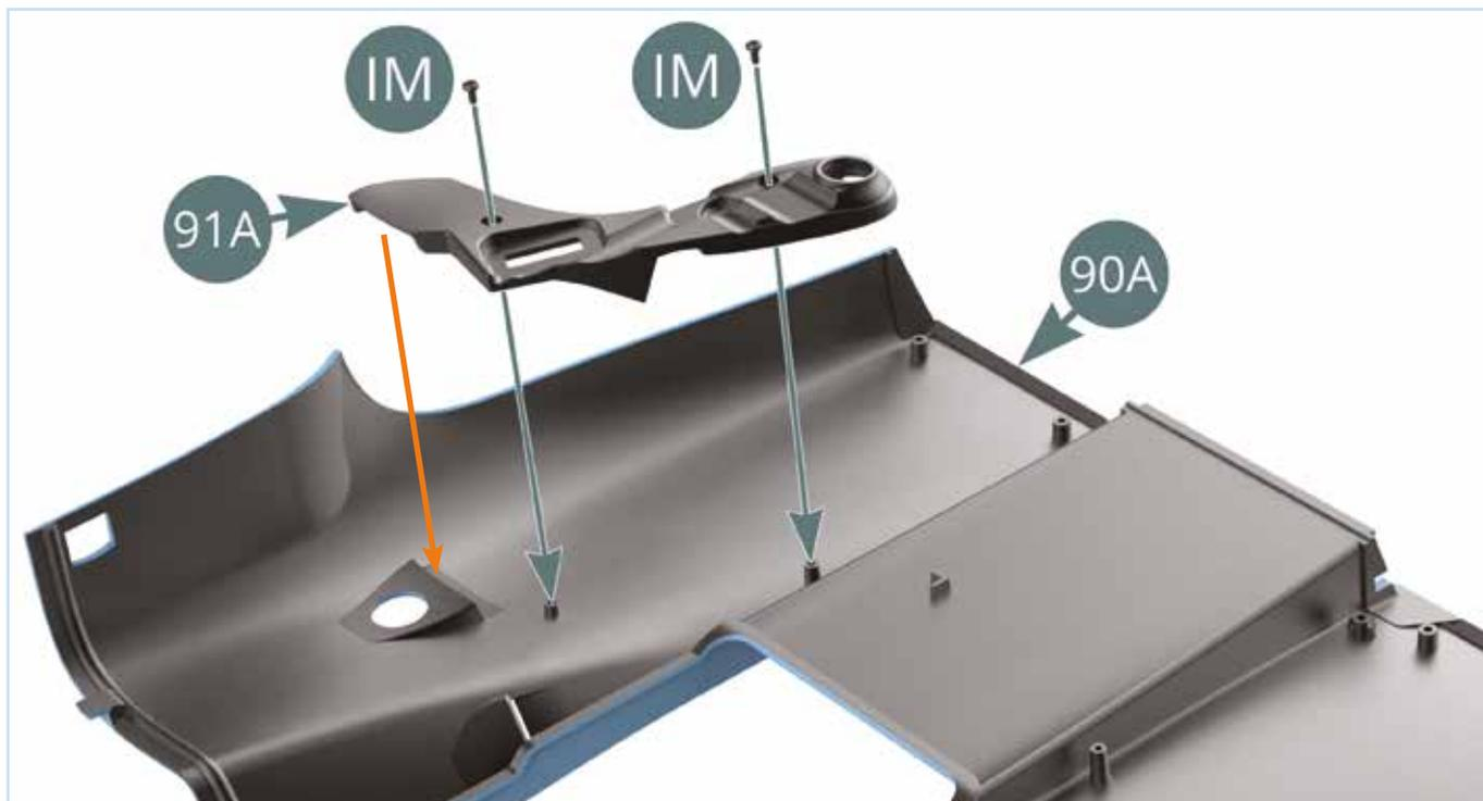
Monta il **condotto dell'aria sinistro (91A)**, contrassegnato con una "L", sul lato inferiore del **cofano posteriore (90A)** come mostrato e fissalo con due viti **IM**. Il bordo del condotto dell'aria deve essere allineato con la presa d'aria del cofano (freccia arancione).
