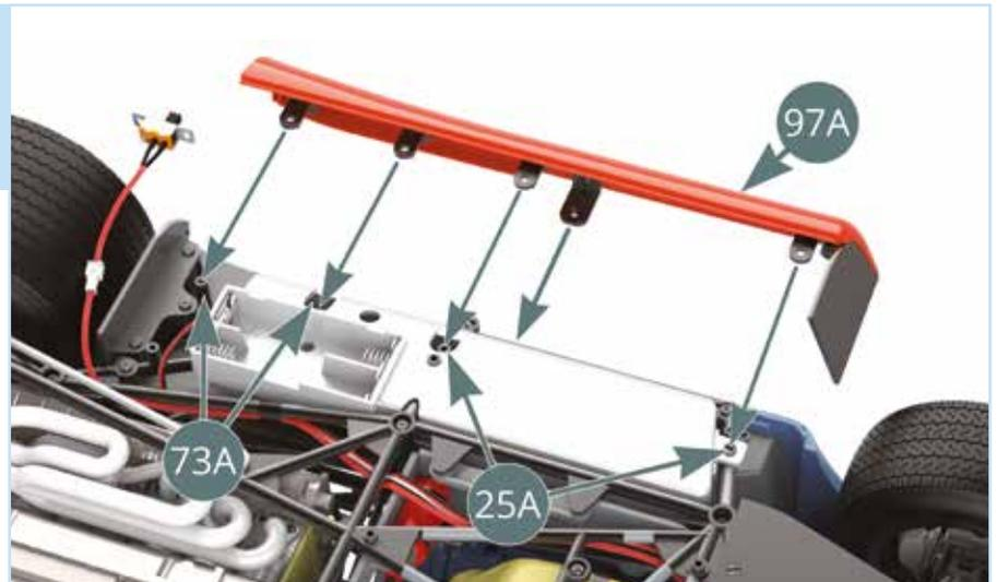
Inizia a fissare la **carenatura laterale destra (97A)** inserendo quattro viti **IM** attraverso le staffe (**97C, 97D e 97E**) (evidenziate in verde). Controlla che la carenatura laterale sia a filo con la carrozzeria anteriore e, se necessario, regola le viti e le staffe.
