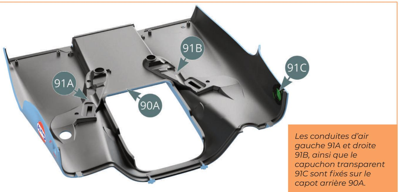
Les conduites d'air gauche 91A et droite 91B, ainsi que le capuchon transparent 91C sont fixés sur le capot arrière 90A.
