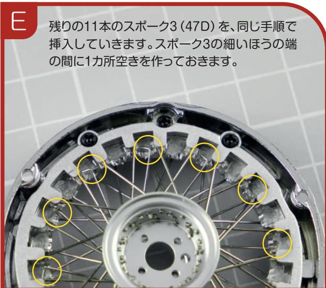
残りの11本のスポーク3 (47D) を、同じ手順で挿入していきます。スポーク3の細いほうの端の間に1カ所空きを作っておきます。
