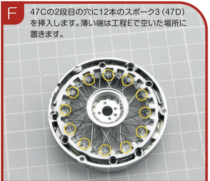
47Cの2段目の穴に12本のスポーク3 (47D) を挿入します。薄い端は工程Eで空いた場所に置きます。
