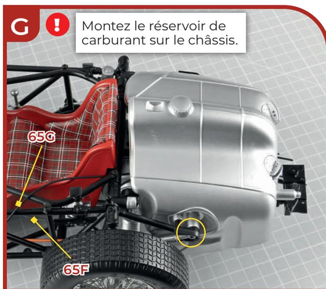
Montez le réservoir de carburant sur le châssis.
