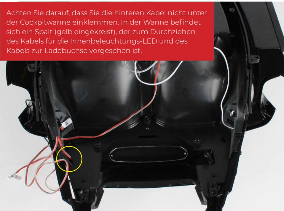
Stecken Sie das weiße und graue Kabel des Motors für die linke Tür in den Spalt (gelb eingekreist), damit das Kabel unter dem Fußraum auf der Fahrerseite verborgen ist und nach vorne herausragt.
