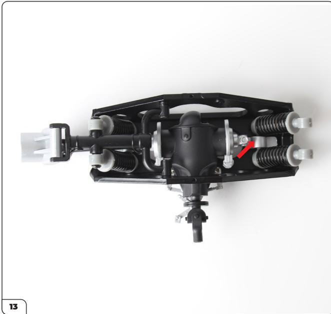
Stecken Sie die Montageplatte in die Löcher am Boden des Hilfsrahmens. Der gewölbte Teil muss die Stange am Stoßdämpfer abdecken (Pfeil).
