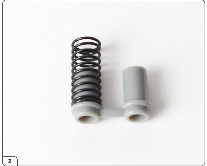
Stecken Sie die Schraubenfeder wie gezeigt auf eine der Stoßdämpferhülsen.
