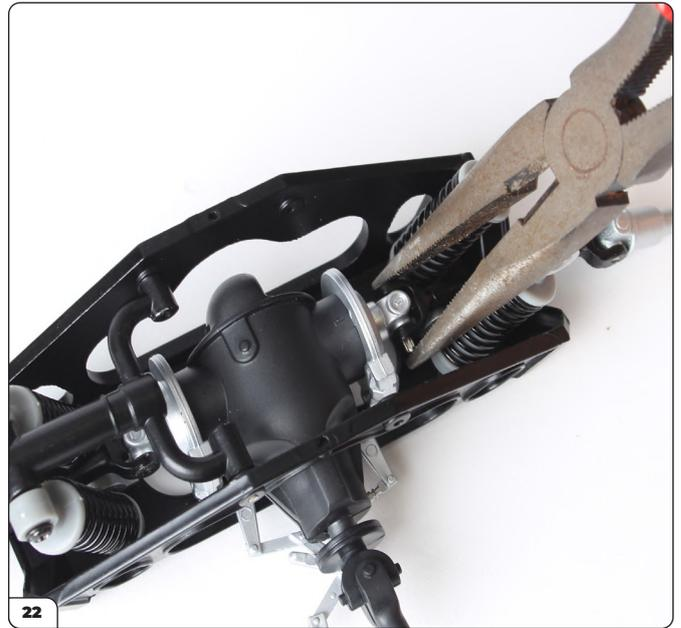
Drücken Sie die Enden des Splints in seine endgültige Position. Der Splint muss bündig anliegen.
