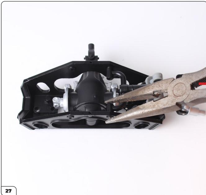
Drücken Sie den Splint in seine endgültige Position. Der Splint muss bündig am Hilfsrahmen anliegen.
