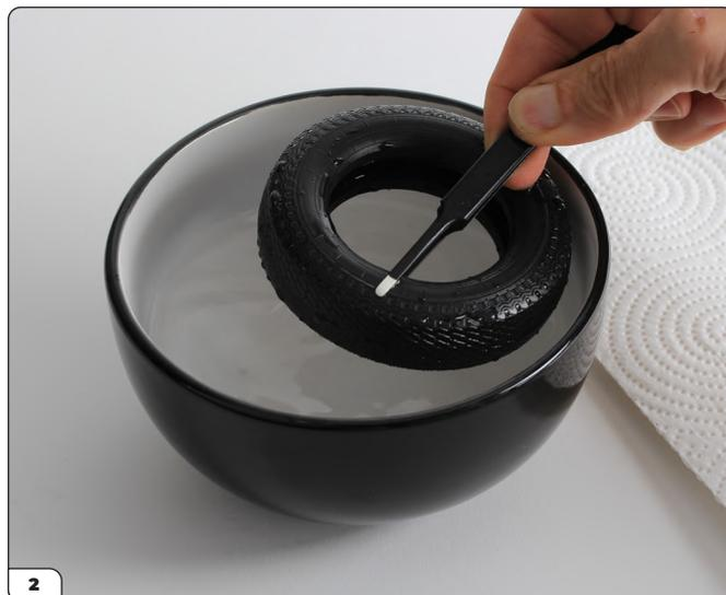
Nehmen Sie den Reifen vorsichtig mit einer Zange oder einer Pinzette aus dem Wasserbad – der Reifen ist sehr heiß! Schütteln Sie überschüssiges Wasser ab und trocknen Sie den Reifen mit Küchenpapier oder einem Geschirrtuch ab.
