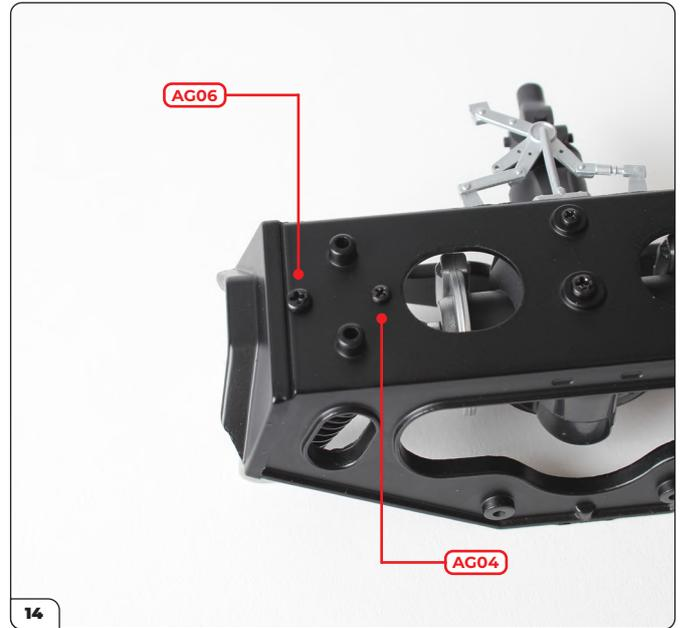
Halten Sie die Montageplatte fest, drehen Sie den Hilfsrahmen um und befestigen Sie die Montageplatte von unten mit 1 AG06- Schraube und 1 AG04-Schraube (siehe Abbildung).
