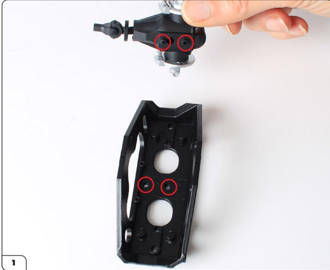
Richten Sie das Differential aus Bauphase 44 auf den hinteren Hilfsrahmen aus. Beachten Sie hierbei die Löcher in der Mitte des Hilfsrahmens und die Zapfen am Differential (eingekreist).
