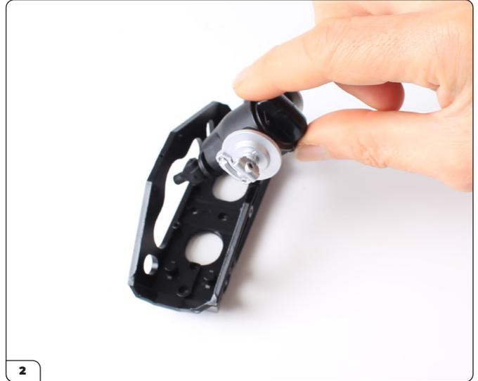
Stecken Sie das Differential wie gezeigt durch die Öffnung im Hilfsrahmen.
