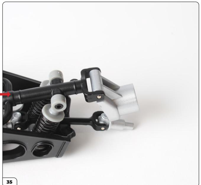
Drücken Sie den Splint in seine endgültige Position. Der Splint muss bündig anliegen.
