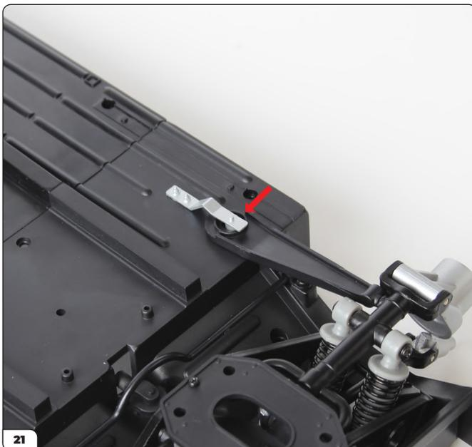
Bringen Sie eine der Sicherheitshalterungen in der gezeigten Richtung an: Stecken Sie ein Ende in das Loch in die Schubstrebe und das andere Ende in das Loch in der Bodenplatte.
