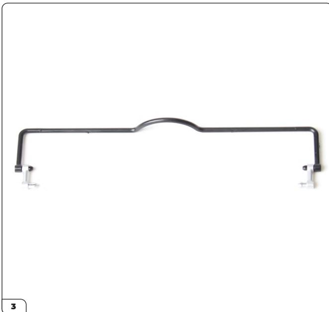
Nehmen Sie die andere Koppelstange und wiederholen Sie den Schritt auf der anderen Seite. Der Stabilisator müsste jetzt so wie hier gezeigt aussehen. Die beiden Zapfen müssen nach innen zeigen.
