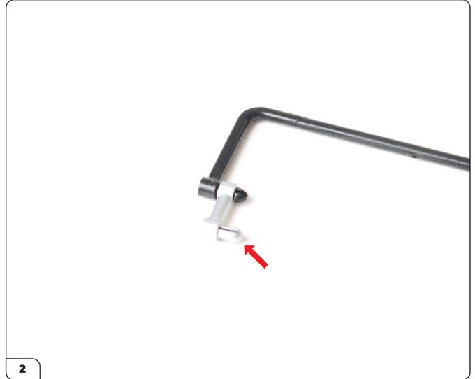
Stecken Sie die Koppelstange auf einen der Zapfen des Stabilisators. Der Zapfen an der Koppelstange muss nach innen zeigen (Pfeil).
