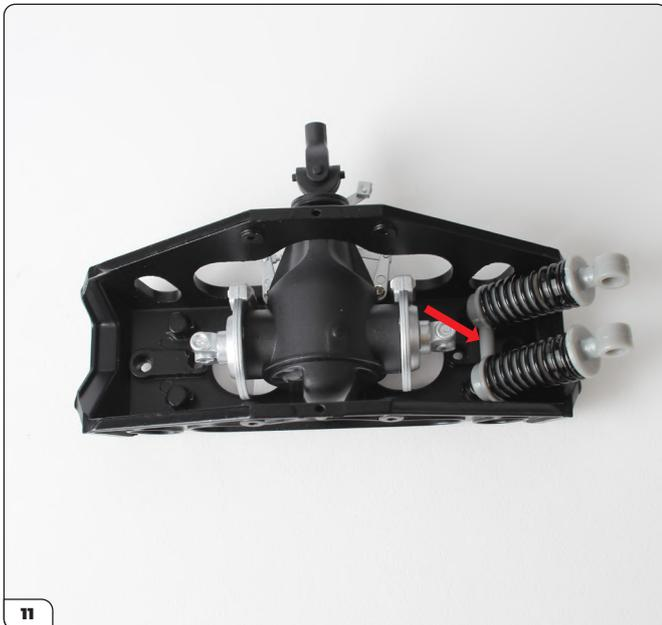
Legen Sie den Stoßdämpfer wie gezeigt in den Hilfsrahmen. Die Stange am Stoßdämpfer (Pfeil) muss sich zwischen den beiden Löchern am Boden des Hilfsrahmens befinden.
