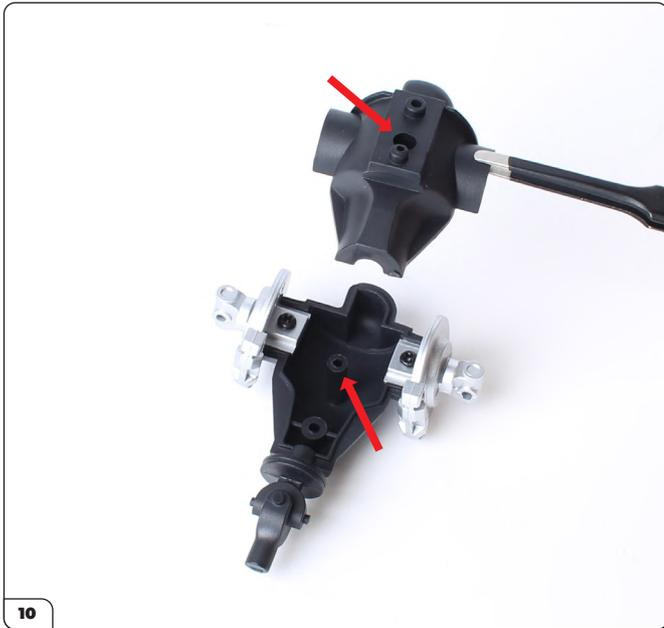
Nehmen Sie das obere Gehäuse und stecken Sie es auf das untere Gehäuse. Richten Sie hierbei den mittleren Zapfen auf der unteren Hälfte auf das Loch in der oberen Hälfte (Pfeile) aus.
