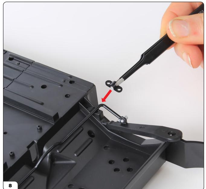
Nehmen Sie eine der Montagehalterungen und legen Sie sie über den Stabilisator. Richten Sie die Montagehalterung hierbei auf die Montagelöcher aus.
