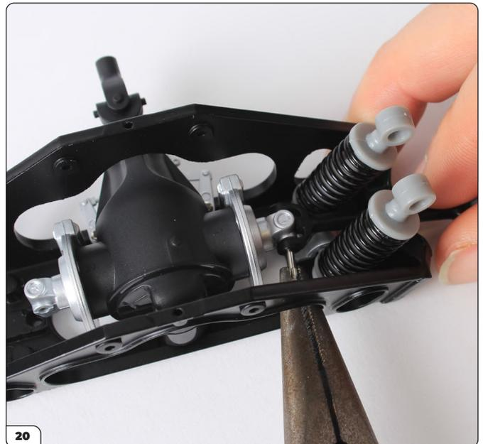
Stecken Sie das glatte Ende des Splints durch die Öffnung an der Seite des Hilfsrahmens in die Halbwelle und in das Universalgelenk.
