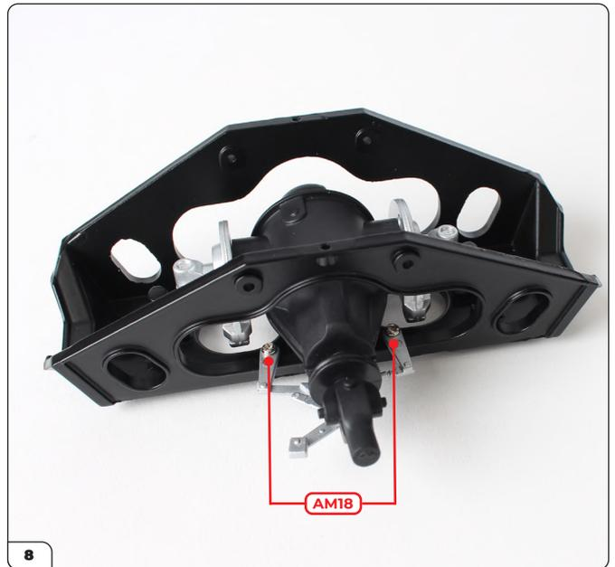
Verschrauben Sie beide Arme mit 2 AM18-Schrauben am Hilfsrahmen.
