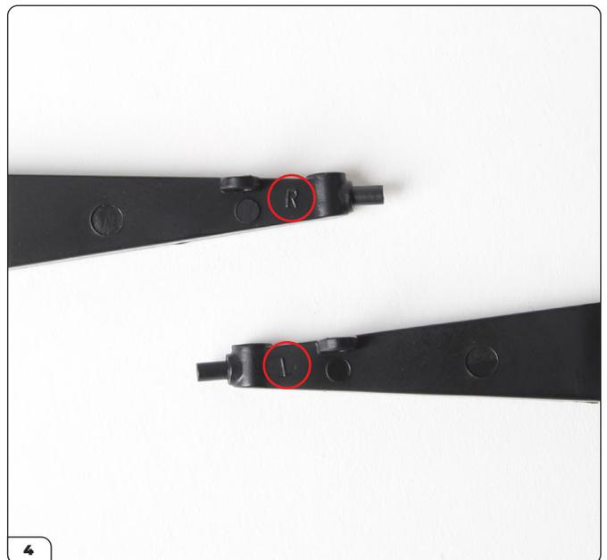
Nehmen Sie die Schubstreben. Beachten Sie, dass die linke Strebe mit einem „L“ und die rechte Strebe mit einem „R“ gekennzeichnet sind (eingekreist).
