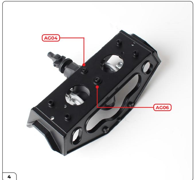
Halten Sie das Differential in seiner Position fest, drehen Sie den Hilfsrahmen um und verschrauben Sie die Baugruppe mit 1 AG04-Schraube und 1 AG06-Schraube.
