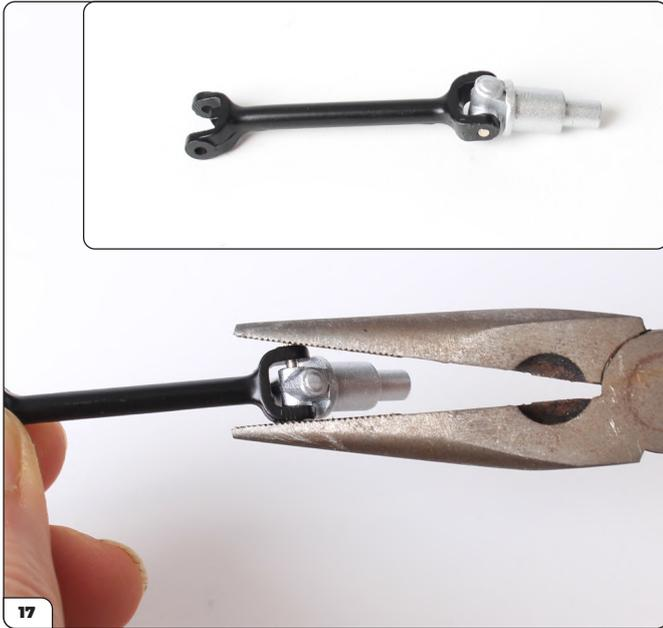
Stecken Sie das glatte Ende des Splints durch die Halbwelle und das Universalgelenk. Drücken Sie den Splint mit einer Zange in seine endgültige Position. Die Enden müssen an beiden Seiten bündig anliegen (kleines Bild).
