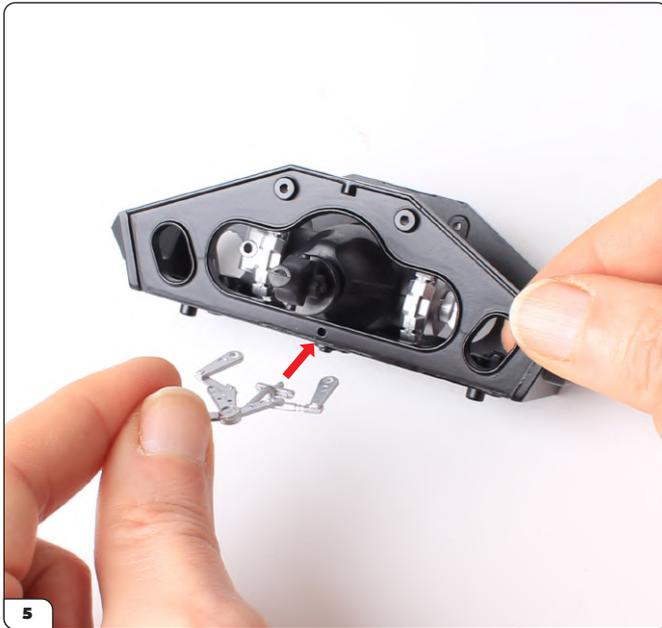
Nehmen Sie das Handbremsgestänge und richten Sie es auf den Hilfsrahmen aus. Der Passstift am Handbremsgestänge passt in das Loch am Hilfsrahmen (Pfeil).
