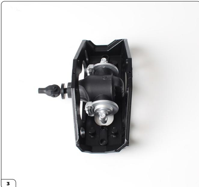
Das Differential muss durch die Öffnung im Hilfsrahmen ragen und die Zapfen müssen in die in Abb. 1 gezeigten Schraublöcher greifen.
