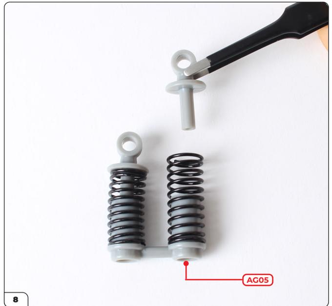
Nehmen Sie den anderen Stoßdämpferkolben und befestigen Sie ihn mit einer AG05-Schraube an der Hülse. Wiederholen Sie hierzu die in Abb. 4 und 5 gezeigten Schritte.
