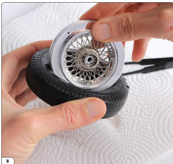
Arbeiten Sie schnell, solange der Reifen noch geschmeidig ist: Stecken Sie das Rad in den Reifen und drehen Sie das Rad bzw. den Reifen so, dass die äußere Radfelge unter der inneren Felge des Reifens sitzt.
