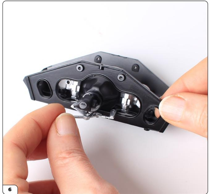
Stecken Sie den Stift in das Loch. Die beiden Arme des Handbremsgestänges müssen in der Öffnung des Hilfsrahmens liegen.
