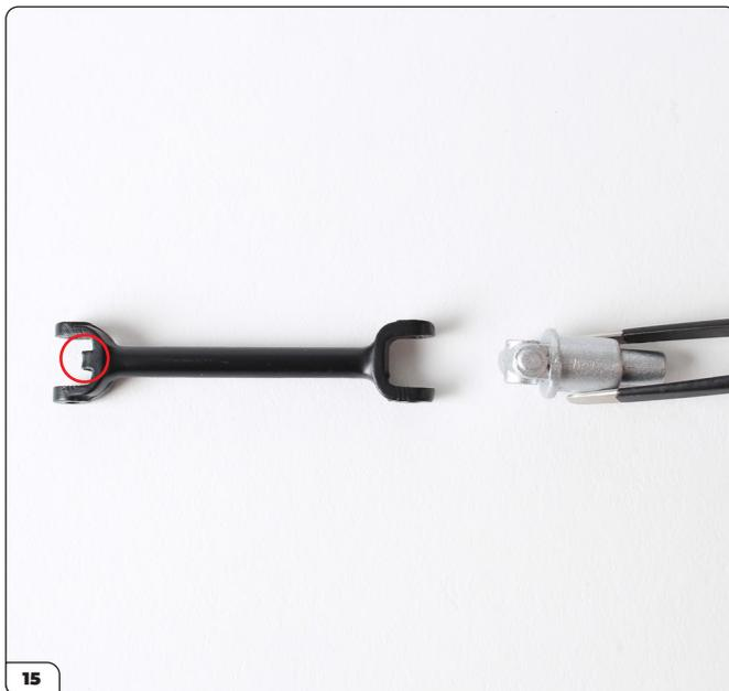
Nehmen Sie die linke Halbwelle und das Universalgelenk. Stecken Sie das Gelenk in das Ende der Halbwelle, das keinen Zapfen (eingekreist) in der Mitte hat. Vergewissern Sie sich, dass die Löcher im Universalgelenk auf die Löcher am Ende der Halbwelle ausgerichtet sind.
