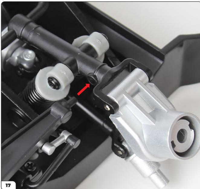
Stecken Sie die Stifte an beiden Schubstreben in die Löcher an beiden Querlenkern (siehe auch eingekreist in Abb. 18).
