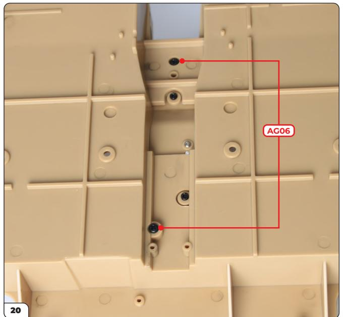
Befestigen Sie die Mittelkonsole mit 2 AG06-Schrauben am Cockpit-Boden.
