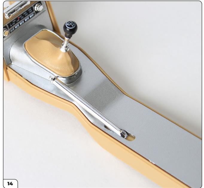
Stecken Sie den Handbremshebel auf die Mittelkonsolen-Baugruppe.
