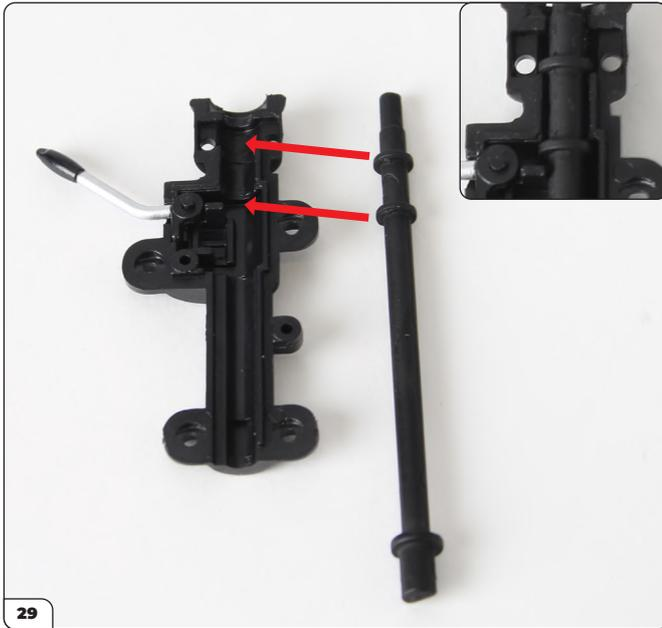
Bringen Sie nun die Lenksäule in ihrem Gehäuse an. Der Bereich zwischen den beiden Rillen muss innerhalb der Aussparungen liegen (Pfeil). Das kleine Foto zeigt den richtigen Einbau.
