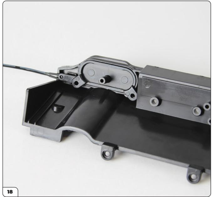
Stecken Sie den Instrumententräger wie gezeigt auf das Armaturenbrett. Der Schraubzapfen des Armaturenbretts muss durch das Loch des Instrumententrägers ragen.
