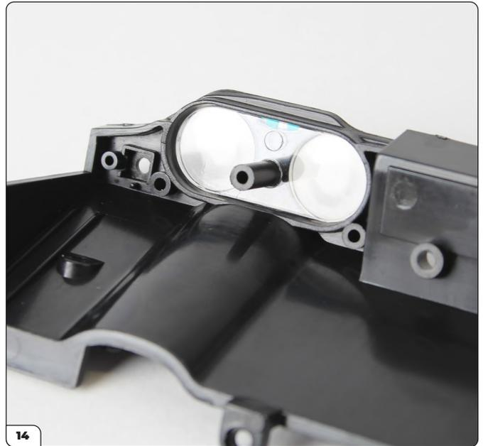
14 Stecken Sie das Instrumentenglas so auf das Armaturenbrett, dass der Schraubzapfen vom Armaturenbrett durch das Loch in der Mitte des Instrumentenglases ragt. Die hervorstehenden Blinker sollten von der Vorderseite des Armaturenbretts (siehe Abb. 20) sichtbar sein.
