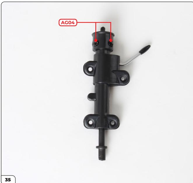
Verschrauben Sie die beiden Gehäusehälften mit 2 AG04-Schrauben.
