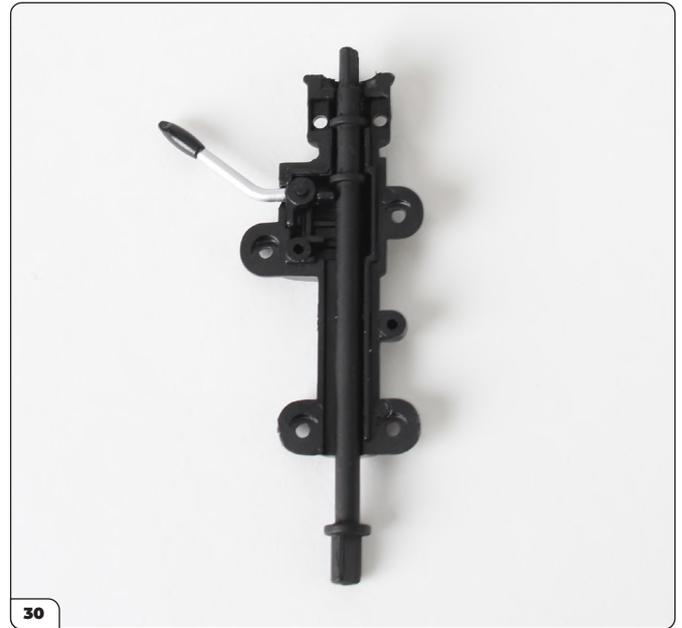
Die Lenksäule ist nun im Gehäuse eingesetzt.
