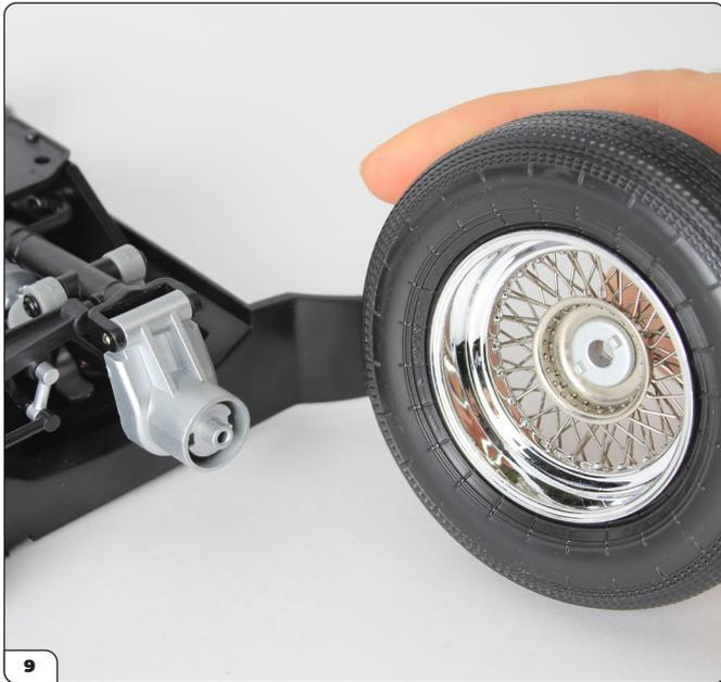
Halten Sie das Rad wie gezeigt, und richten Sie die beiden Zapfen in der Radmitte auf die beiden Kerben im rechten Nabenträger aus. Stecken Sie das Rad auf. Achten Sie darauf, dass die Zapfen in den Kerben sitzen.
