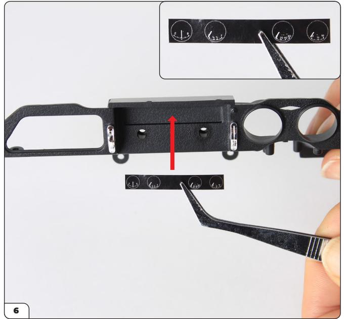
Richten Sie den Aufkleber für die kleinen Instrumente wie gezeigt auf das Armaturenbrett aus. Die Zahlen müssen sich unten auf den vier Instrumenten befinden (siehe kleines Bild). Legen Sie den Aufkleber probeweise in die Aussparung (Pfeil), bevor Sie die Schutzfolie abziehen.
