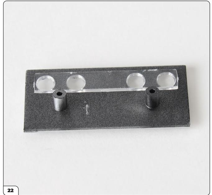
Das Glas ist nun an der Armaturenblende angebracht. In diesem Foto zeigt die glatte Seite des Glases nach oben.
