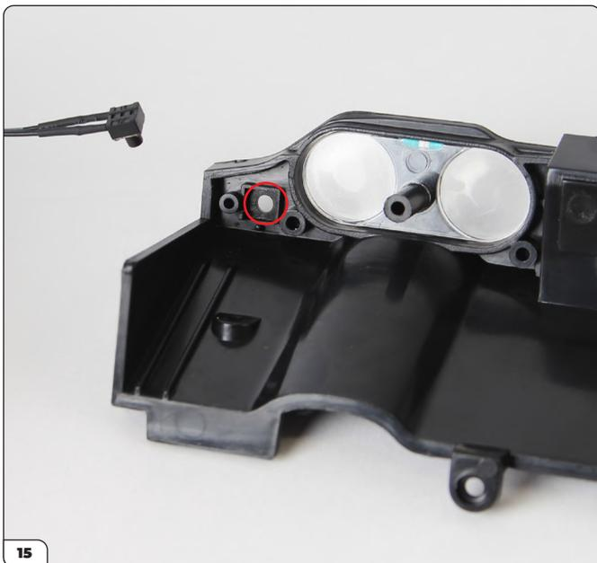
15 Nehmen Sie den Mikroschalter und identifizieren Sie das Loch im Armaturenbrett (eingekreist), durch das der Schalter gesteckt wird.
