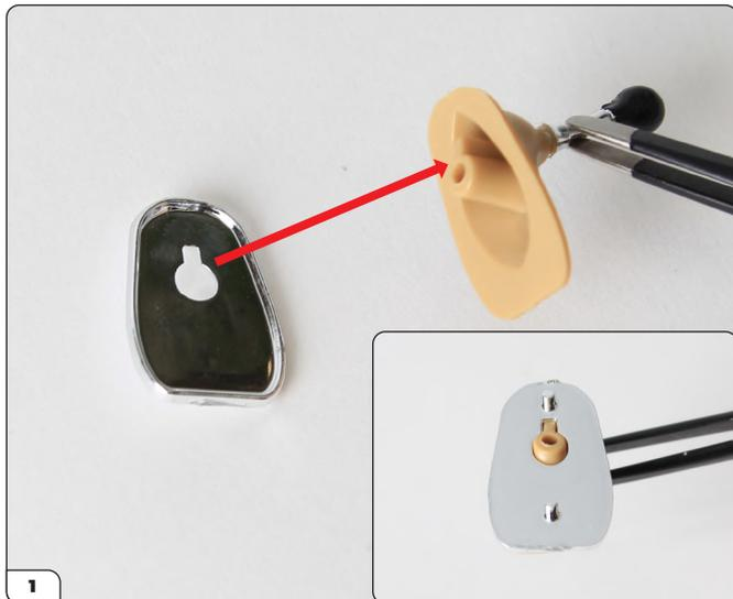
Nehmen Sie den Schalthebel und die Schalthebelmanschette. Stecken Sie die Manschette so auf den Schalthebel, dass der Zapfen durch das Loch ragt und die Stifte nach oben zeigen (siehe kleines Bild).
