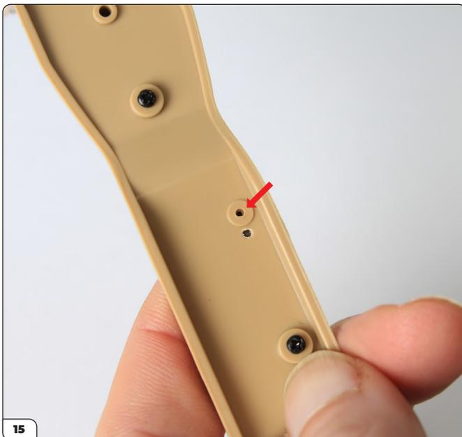
Halten Sie den Handbremshebel an seinem Platz fest, drehen Sie die Mittelkonsole um und lokalisieren Sie das Schraubloch für den Zapfen des Handbremshebels (Pfeil).
