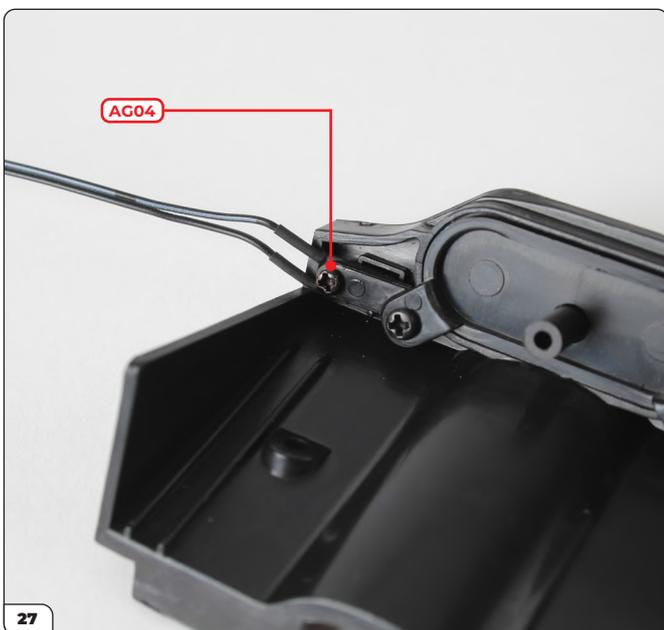
Drehen Sie vorsichtig 1 AG04-Schraube in das letzte Loch des Instrumententrägers ein. **Ziehen Sie diese Schraube nicht zu fest an.** Testen Sie, nachdem Sie die Schraube festgezogen haben, die Verbindung. Drücken Sie hierzu auf den Knopf am Armaturenblett. Wenn Sie kein Klicken spüren, lösen Sie die Schraube ein bisschen.
