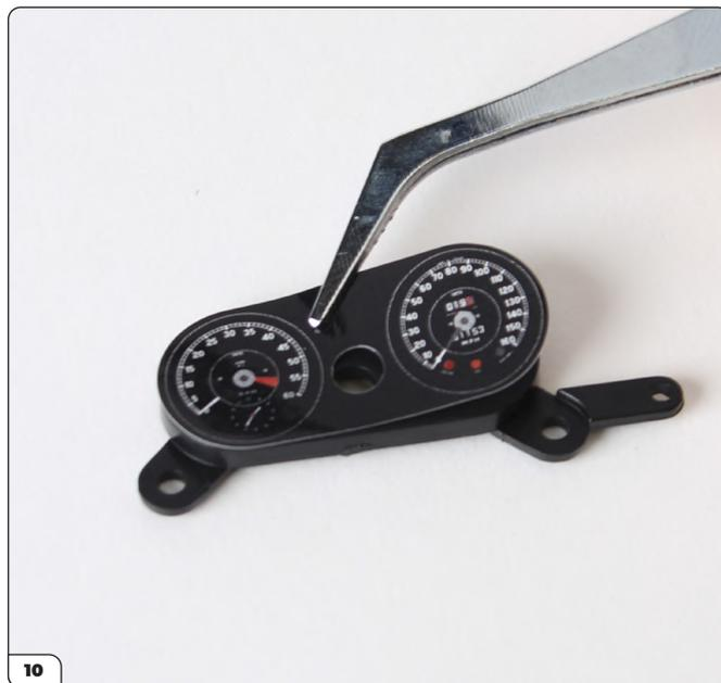
Ziehen Sie die Schutzfolie ab und bringen Sie den Aufkleber am Instrumententräger an. Verwenden Sie das Loch in der Mitte des Aufklebers beim Anbringen des Aufklebers am Träger als Orientierungshilfe.
