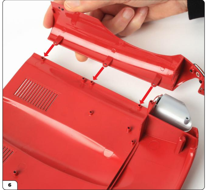
Nehmen Sie den rechten vorderen Kotflügel und richten Sie die drei Laschen auf die entsprechenden erhöhten Schraublöcher an der Motorhaube (siehe Pfeile) aus.
