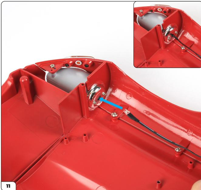
Nehmen Sie jetzt die linke Scheinwerfer-LED (mit „5“ markiert), die Sie in Bauphase 71 erhalten haben. Richten Sie diese Scheinwerfer-LED auf das Loch an der Rückseite des Scheinwerfers (siehe Pfeil) aus. Stecken Sie das LED-Lämpchen in das Loch, bis es fest sitzt (siehe kleines Bild).
