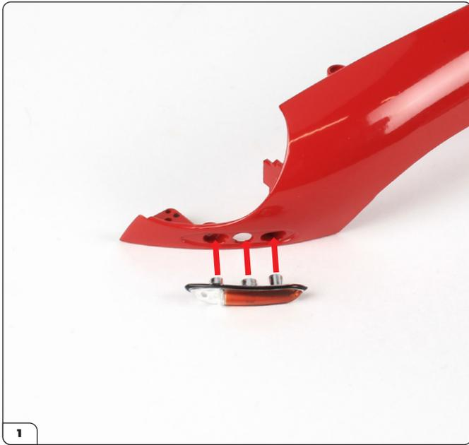
Richten Sie zuerst die Seitenlicht-/Blinker-Gruppe so auf den linken vorderen Kotflügel aus, dass die drei Stifte wie gezeigt zu den entsprechenden drei Löchern an der Außenseite des Autos zeigen.
