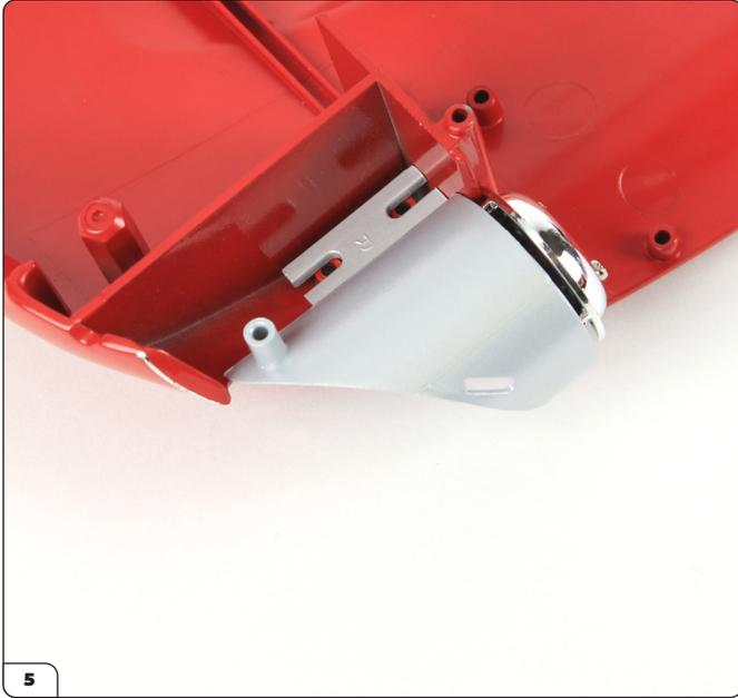
Setzen Sie die Scheinwerfer-Baugruppe so ein, dass die Schraublöcher von der Motorhaube wie gezeigt auf die Kerben ausgerichtet sind.
