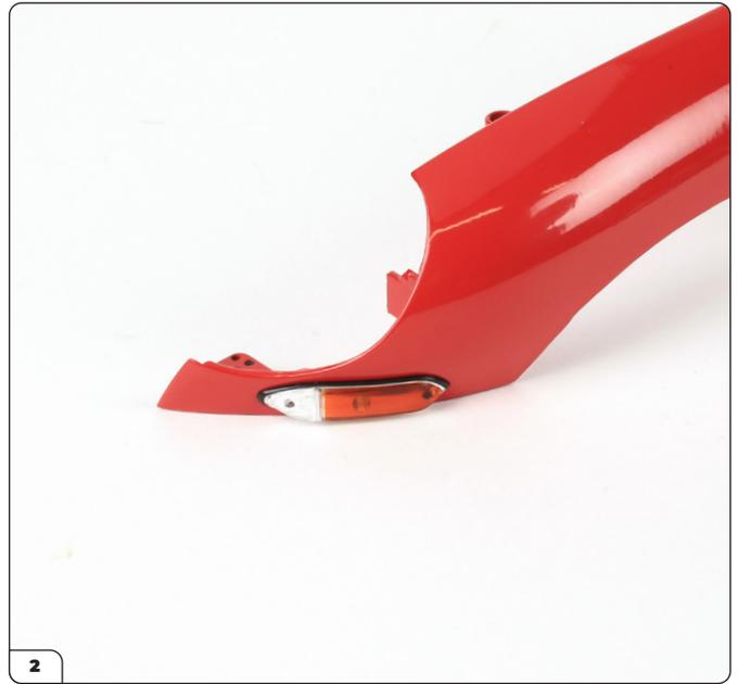
Stecken Sie die Leuchten-Gruppe hinein. Die Stifte müssen in die drei Löcher greifen und die Leuchte muss bündig am Kotflügel anliegen.
