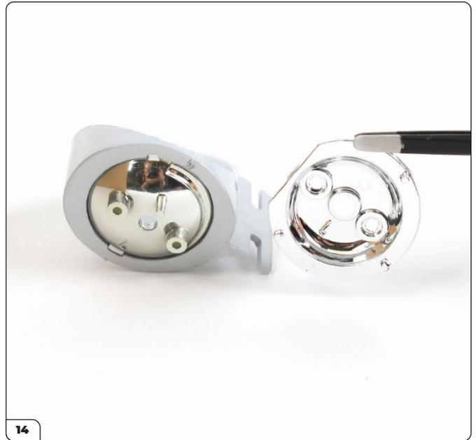
Richten Sie die Aufnahme auf die Rückseite des Scheinwerfergehäuses aus. Bringen Sie die Aufnahme an. Der Stift muss in das Loch greifen und die Schraublöcher müssen aufeinander ausgerichtet sein.
