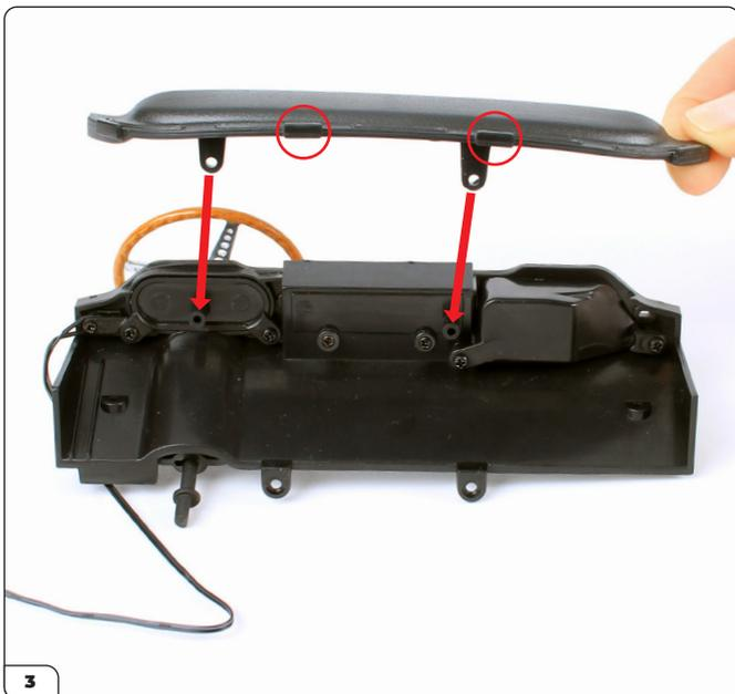
Nehmen Sie jetzt das obere Armaturenbrett und richten Sie es auf das Armaturenbrett aus. Die Kerben (eingekreist) müssen in die in der Abbildung gezeigte Richtung weisen. Legen Sie das obere Armaturenbrett auf.
