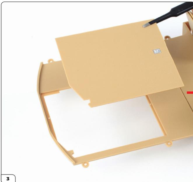
Die Abdeckung für das Reserverad kann jetzt in die entsprechende Aussparung im hinteren Boden gelegt werden.
