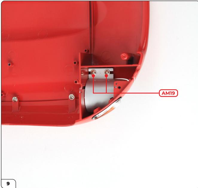
Der vordere Kotflügel ist nun angebaut. Drehen Sie nun 2 AM19-Schrauben in die Scheinwerfer-Baugruppe ein, um auch sie zu befestigen.
