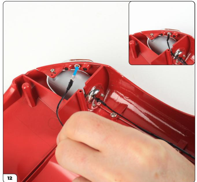
Nehmen Sie abschließend die linke Blinker-LED (mit „7“ markiert), die Sie in dieser Bauphase erhalten haben. Richten Sie diese Blinker-LED auf das Loch an der Rückseite der Seitenlicht-/Blinker-Gruppe (siehe Pfeil) aus. Stecken Sie das LED-Lämpchen in das Loch, bis es fest sitzt (siehe kleines Bild).
